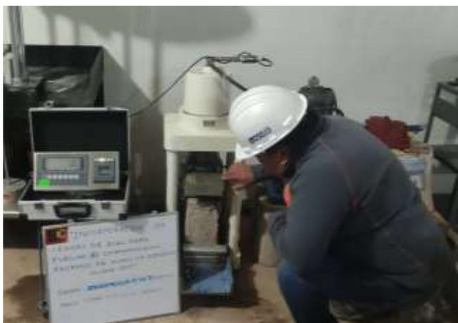
Figura 6: Ensayo de flexión por adherencia
