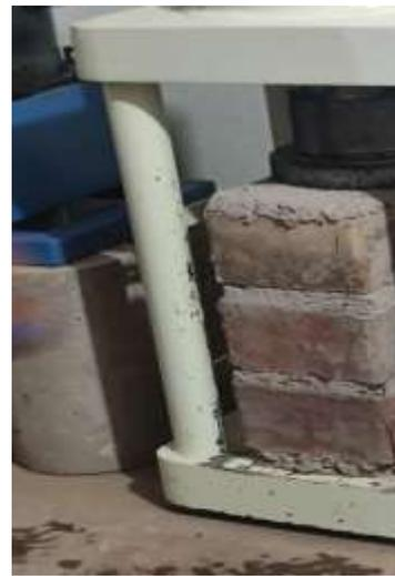
*Fig. 2. Pilas en ensayos*
