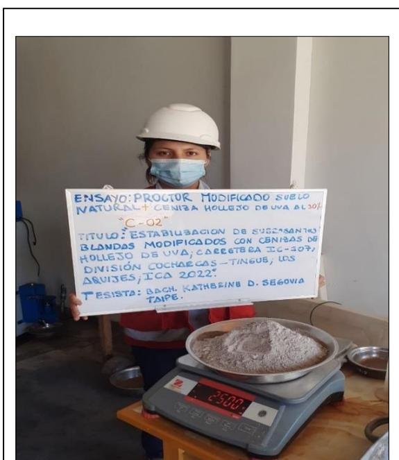
Figura 16. Ensayo de Proctor modificado con la adición de ceniza de hollejo de uva.
