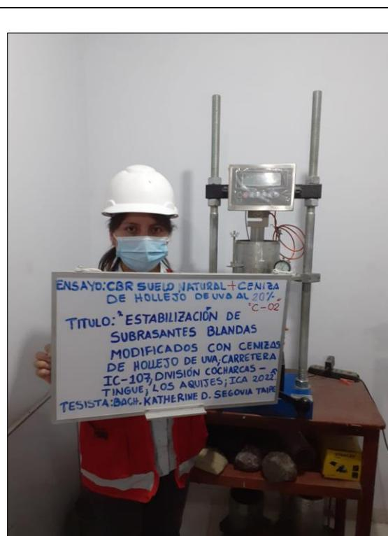
Figura 20. CBR con la adición (10%, 20%, 30% y 40%) de ceniza de hollejo de uva.
