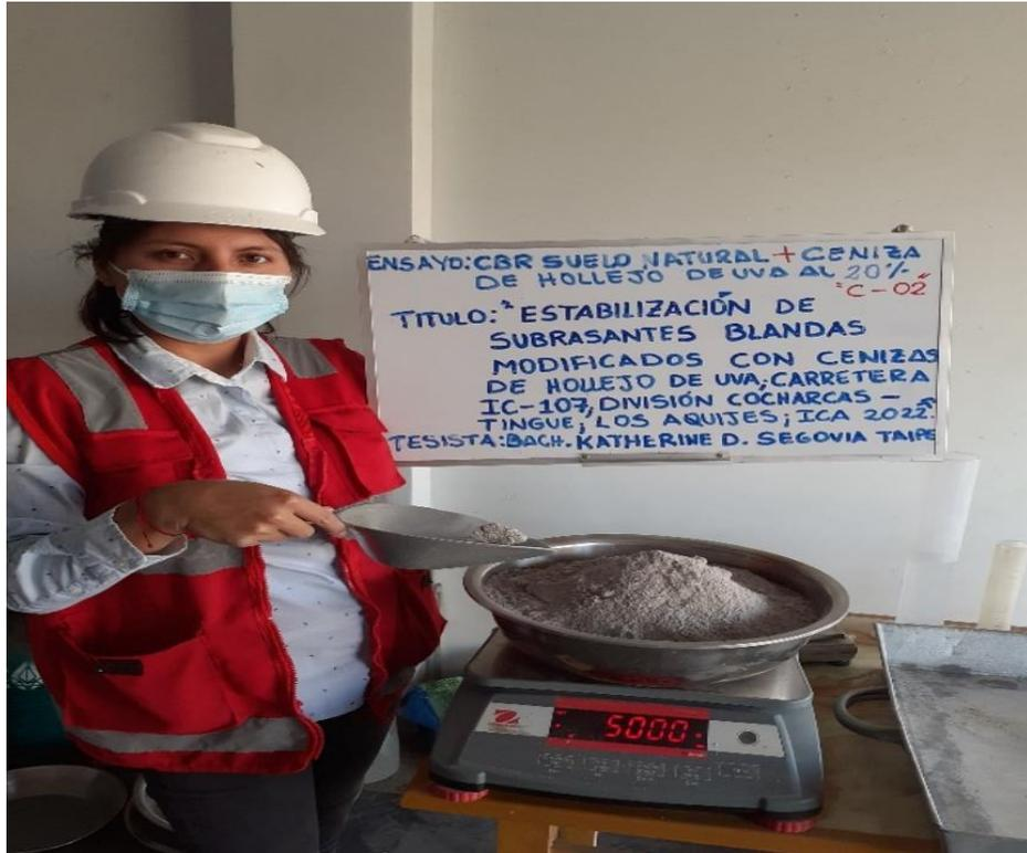
Figura 39. Ensayo de CBR suelo natural + 20% de cenizas de hollejo de uva
