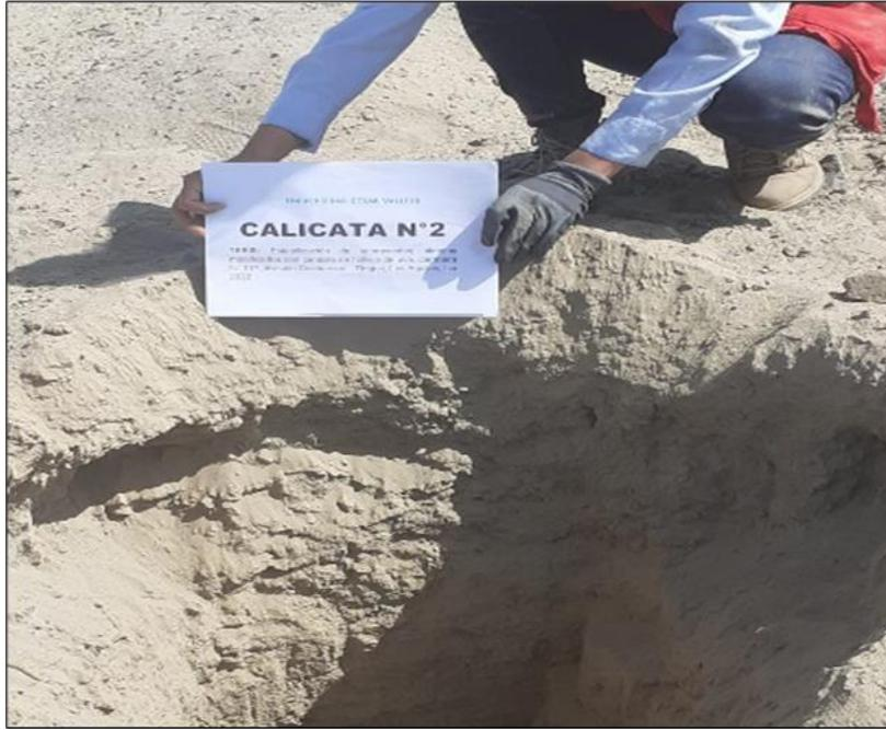
*Figura 29.* Excavación de calicata N°2
