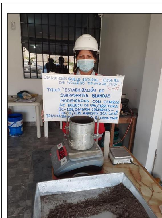
Figura 19. Ensayo de CBR con la incorporación de cenizas de hollejo de uva.
