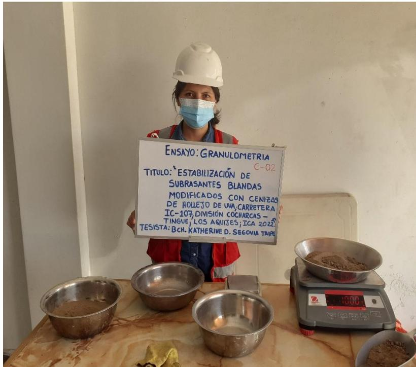
Figura 31. Ensayo de Granulometría suelo natural C-02
