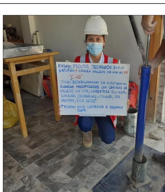
Figura 17. Compactación Proctor modificado con la adición (10%, 20%, 30% y 40%) de ceniza de hollejo de uva.
