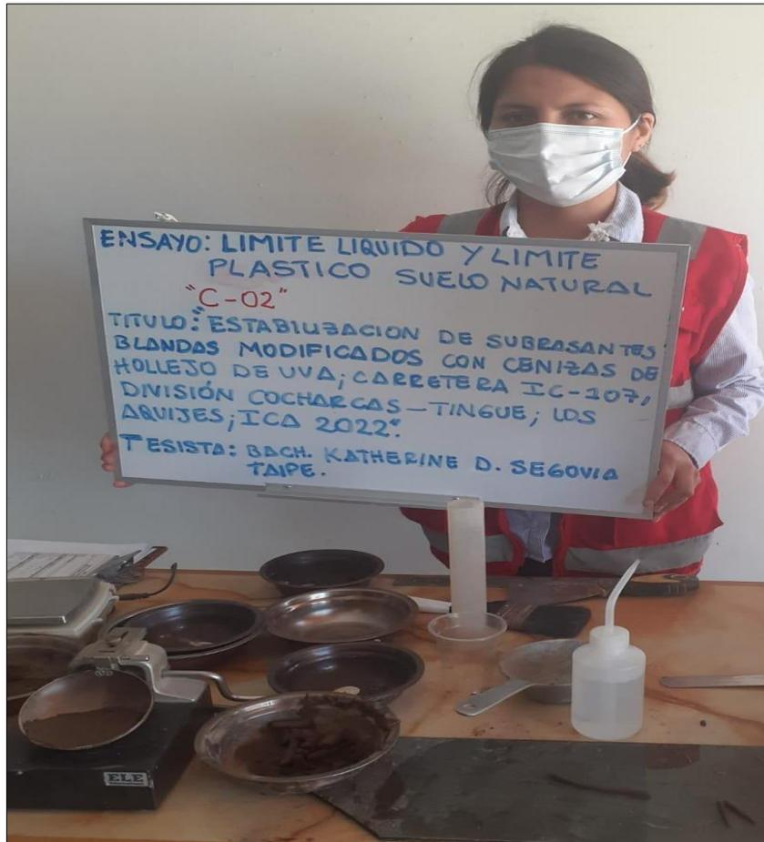
Figura 41. Ensayo de Limite líquido y limite plástico realizado con el instrumento casa grande para la C-02.
