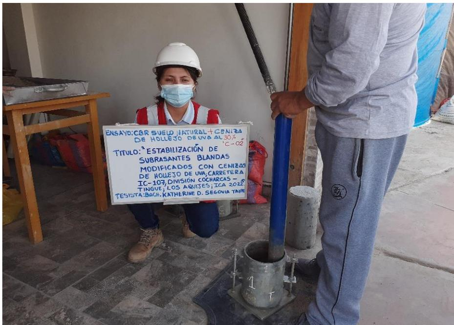
Figura 40. Ensayo de CBR suelo natural + 30% de cenizas de hollejo de uva
