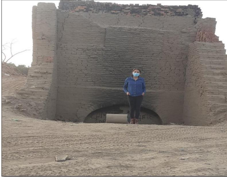
*Figura 27.* Incineración de hollejo de uva en horno artesanal a 600 °C
