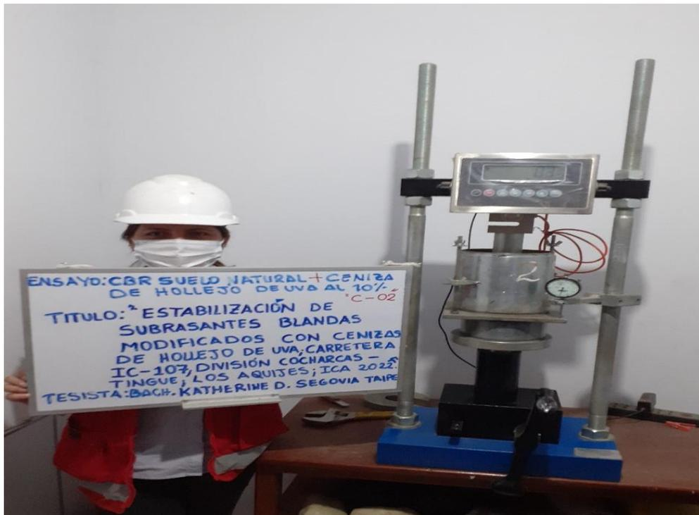
Figura 38. Ensayo de CBR suelo natural + 10% de cenizas de hollejo de uva
