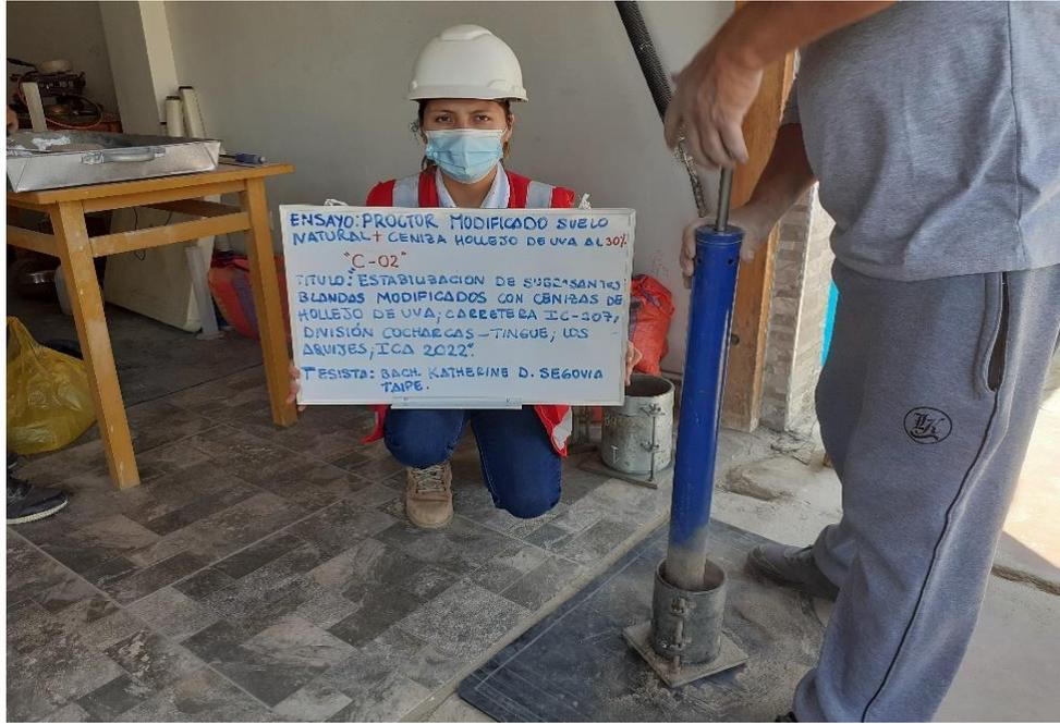
Figura 37. Ensayo de Proctor modificado suelo natural + 30% de cenizas de hollejo de uva
