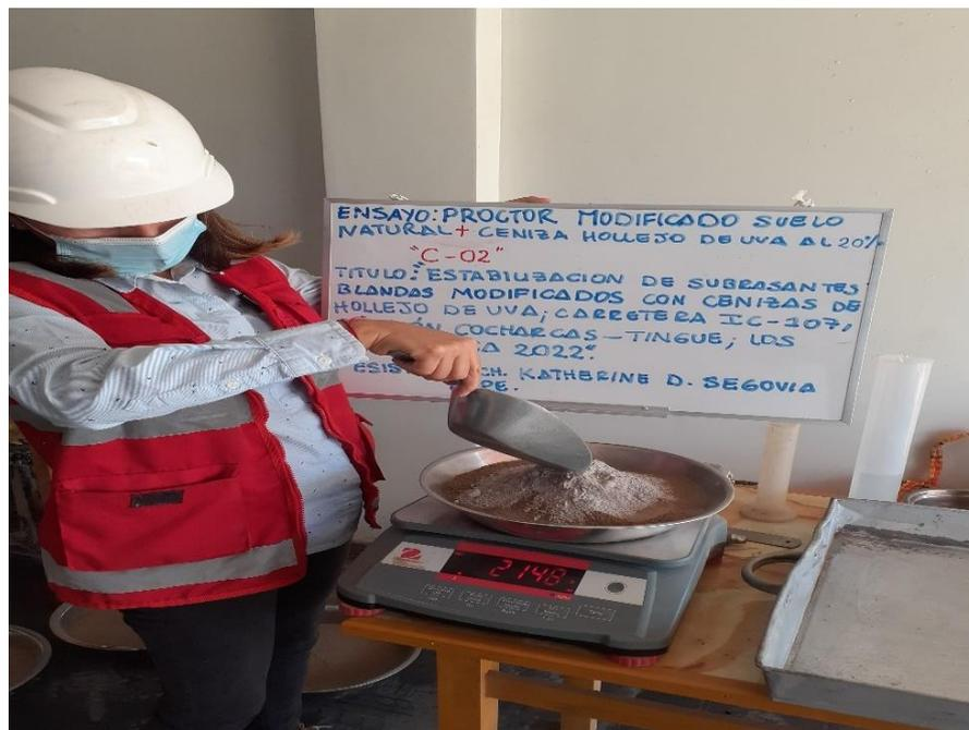
Figura 36. Ensayo de Proctor modificado suelo natural + 20% de cenizas de hollejo de uva
