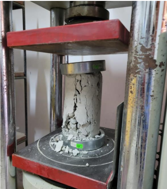
Figura 33: Momento de la rotura
