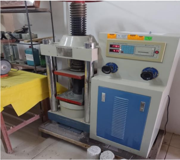
Figura 31: Equipo para ensayo de rotura
