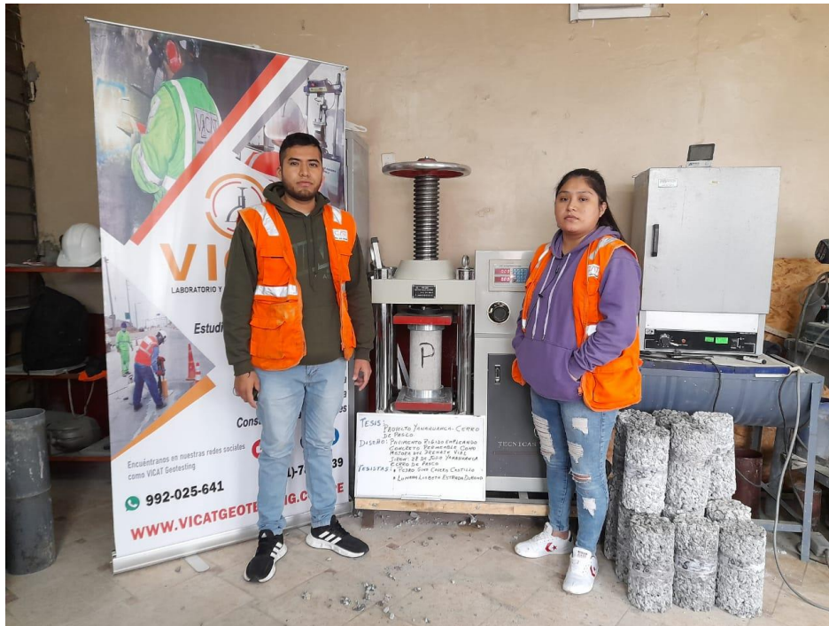
Figura 50. Previo a ensayo de compresión a Probeta Patrón
