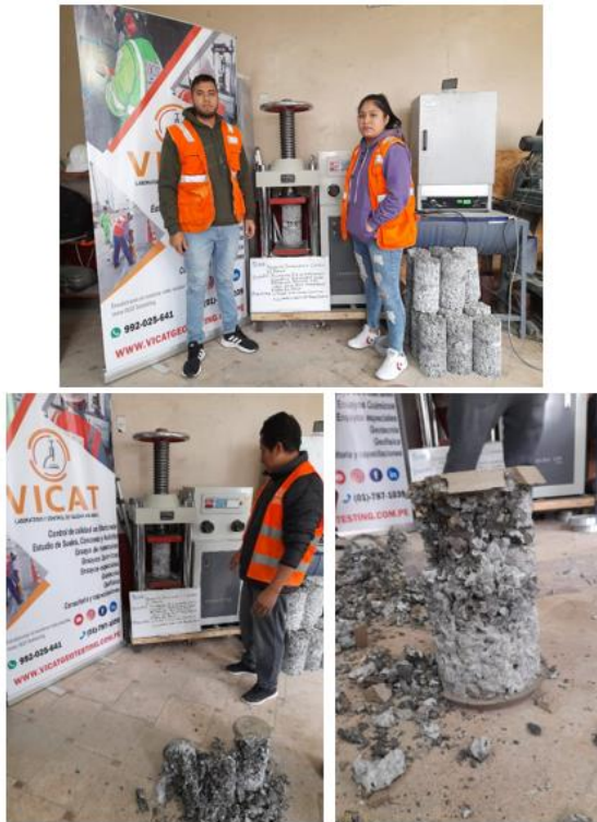
Figura 52. Ensayo de compresión - Probeta 15% de vacíos
