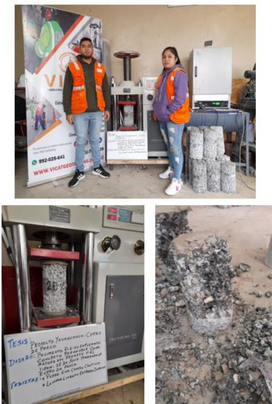
Figura 53. Ensayo de compresión - Probeta 20% de vacíos
