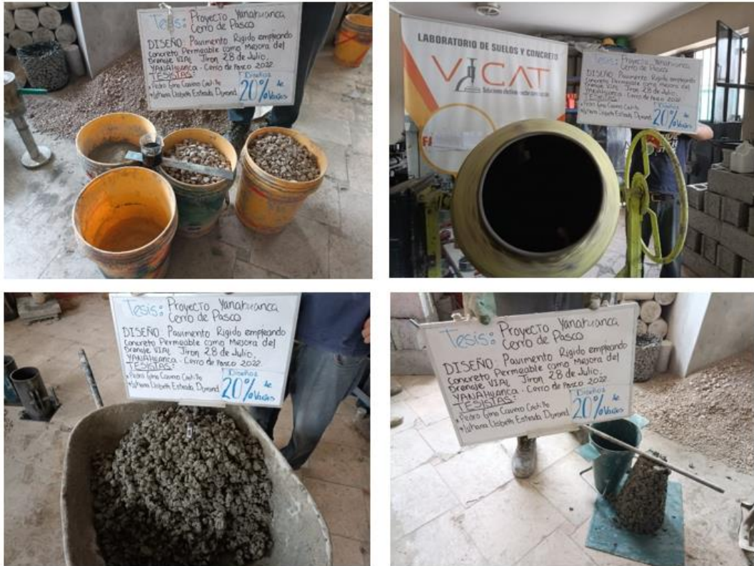
Figura 46. Realización de probetas al 20% de vacíos
