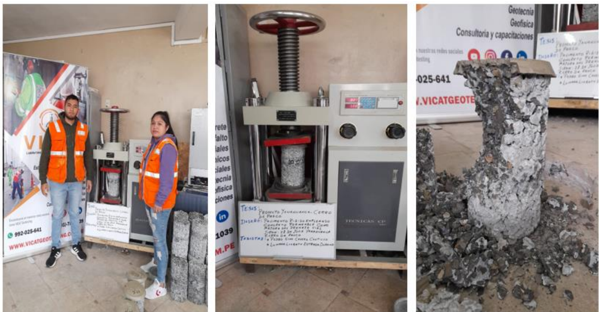
Figura 51. Ensayo de compresión - Probeta 10% de vacíos
