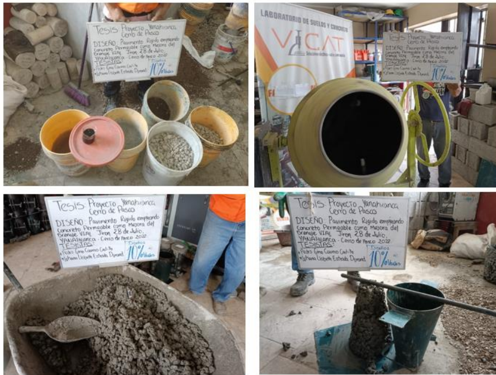
Figura 44. Realización de las probetas al 10% de vacíos
