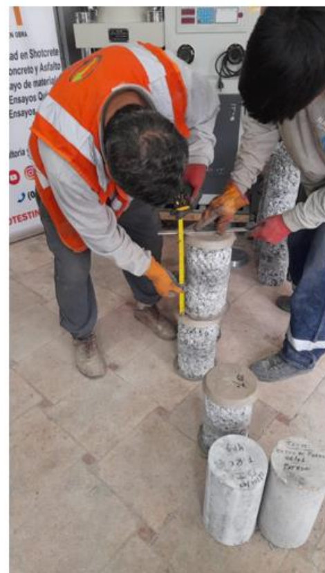
Figura 49. Medición de probetas para iniciar el examen de compresión
