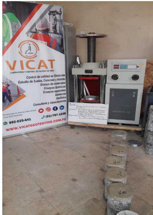
Figura 48. Máquina para los ensayos de compresión
