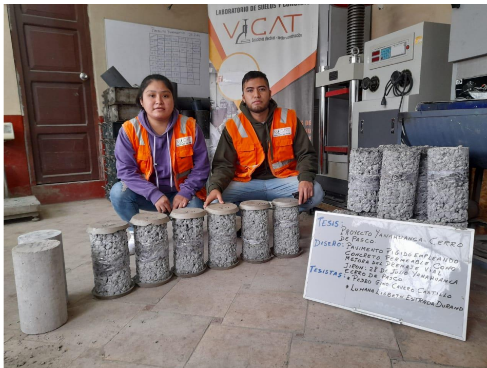
Figura 47. Diseño de probetas realizados: Patrón - probetas al 10% - 15% - 20%
