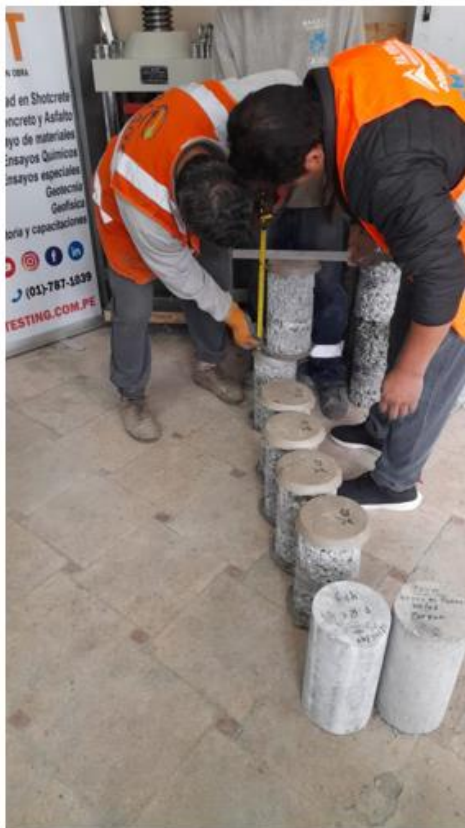
Figura 49. Medición de probetas para iniciar el examen de compresión
