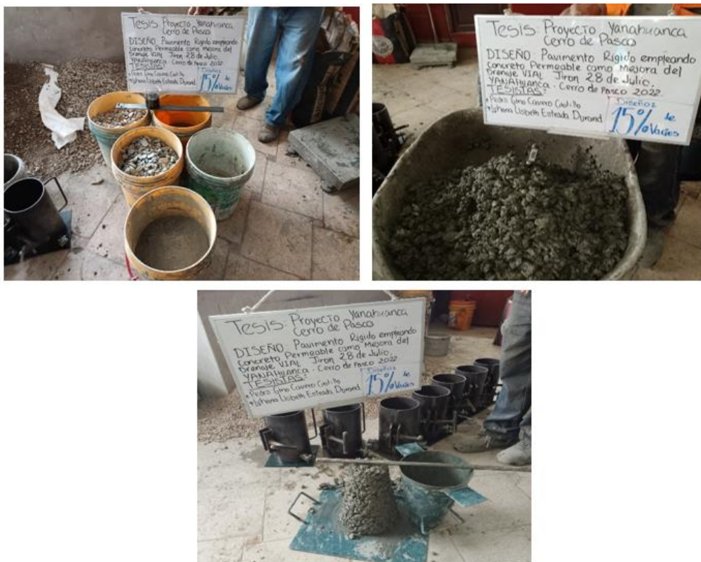
Figura 45. Realización de probetas al 15% de vacíos
