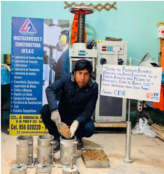
Figura 65. Realizando la mezcla CBR.
