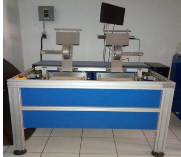
Figura 105. Ensayo rueda de Hamburgo.
