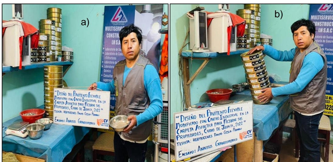
Figura 17. Análisis granulométrico a) Selección de la muestra b) Proceso de tamizado Fuente: Propia del investigador
