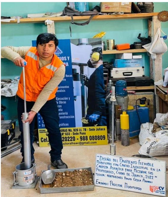
Figura 67. Realizando la compactación.
