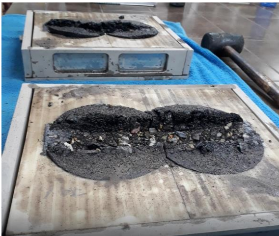
Figura 106. Ensayo rueda de Hamburgo.
