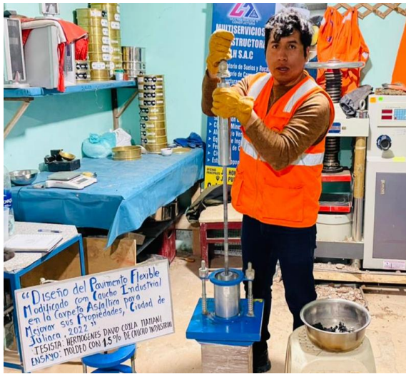
Figura 73. Moldeo de briquetas (1.5% CI).
