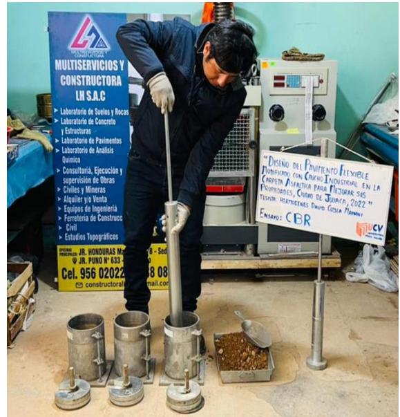
Figura 66. Realizando la compactación.
