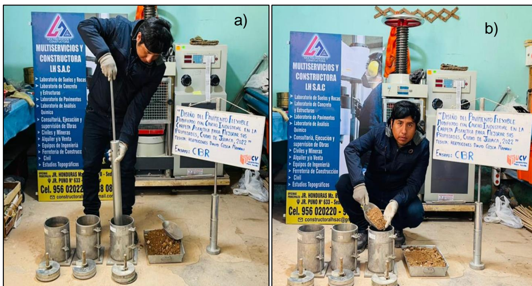
Figura 20. Ensayo de CBR a) Adición de la muestra b) Procesamiento Fuente: Propia del investigador
