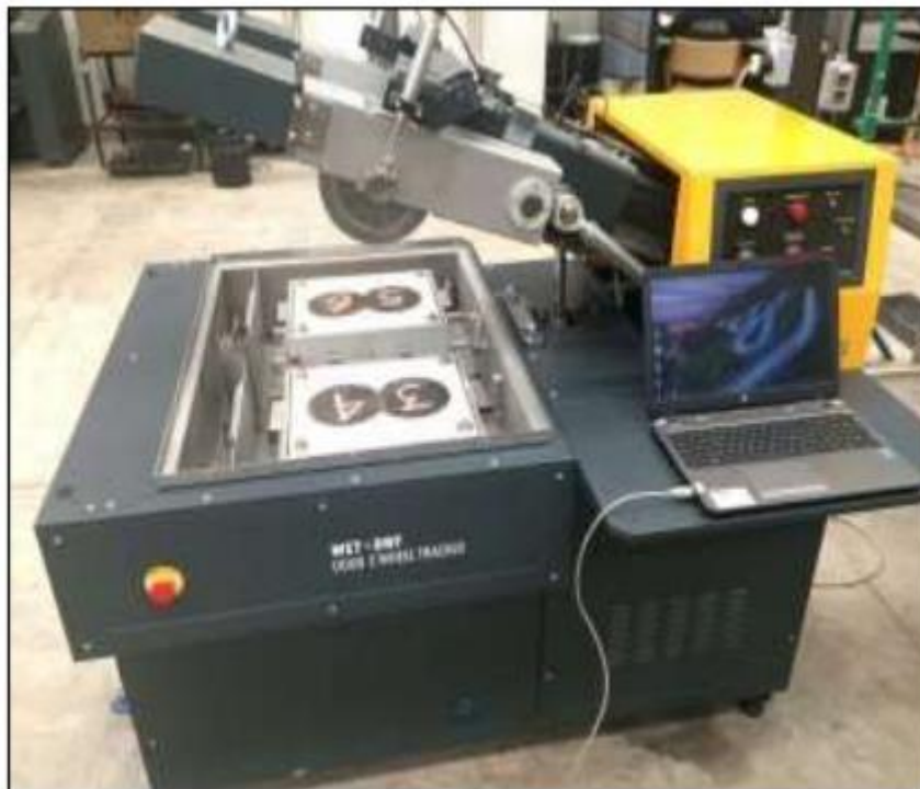
Figura 3. Equipo de la rueda de carga de Hamburgo Fuente: Flores et al. (2018).
