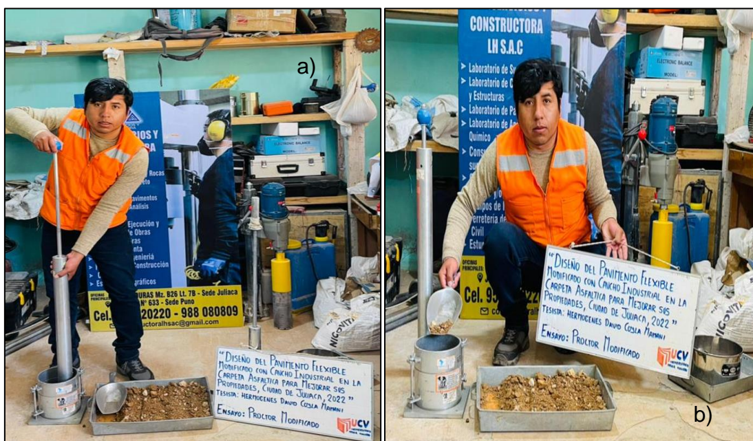
Figura 19. Ensayo de proctor modificado a) Preparación de la muestra b) Procesamiento Fuente: Propia del investigador
