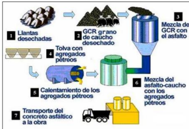
Figura 1. Modificación asfáltica por vía húmeda Fuente: Bisso (2015).
