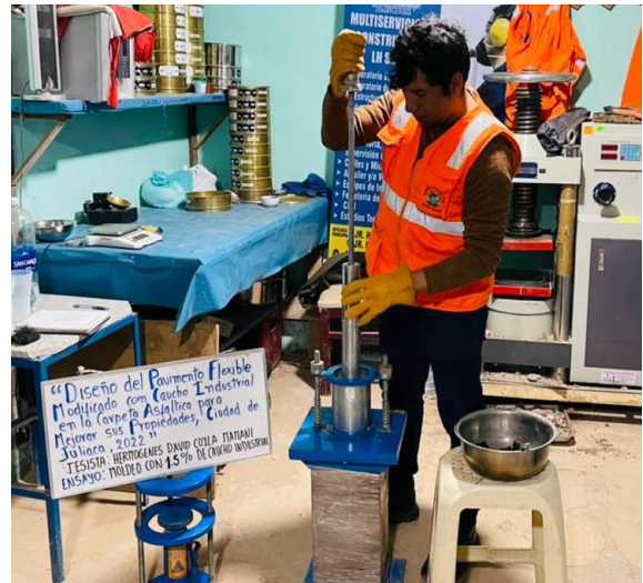
Figura 74. Moldeo de briquetas (1.5% CI).
