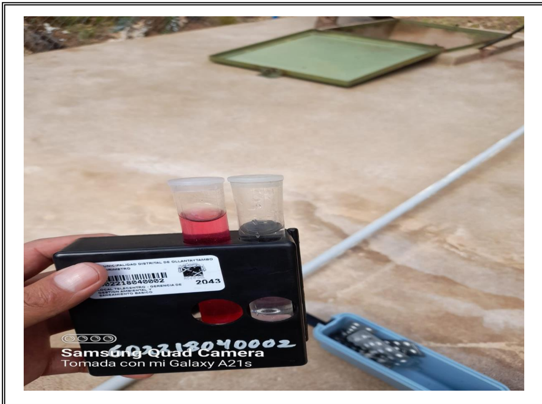
Foto 20: Control de cloro presente en el agua en reservorio
