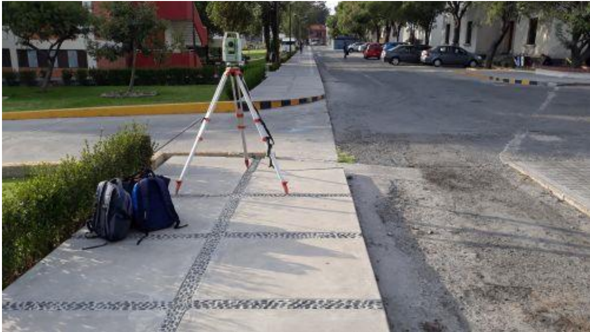
Foto 9; Equipo topográfico para el levantamiento de la edificación Existente
