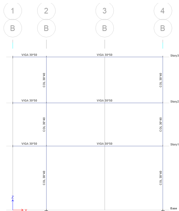
Figura 39. Vista de la planta del 1º Nivel del Módulo. Nótese la disposición y dimensiones de sus elementos principales (columnas y vigas).
