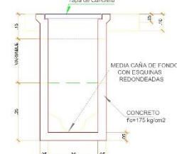
CORTE Y - Y DETALLE DE CAJA DE REGISTRO DE 12" x 24"
