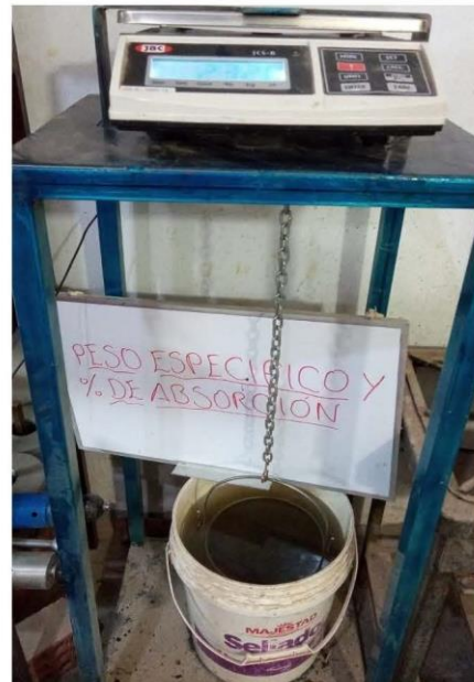
FOTO N° 02. Se muestra ensayo para peso específico y absorción de la piedra.
