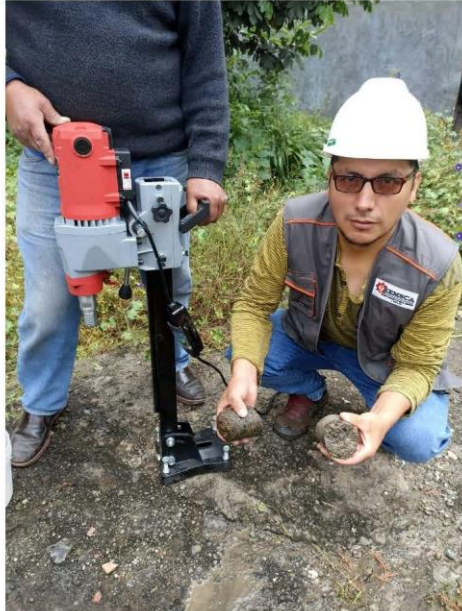
FOTO N° 01. Extracción de la muestra de roca con diamantina de las dos muestras.
