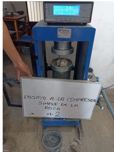
FOTO N° 03. Se muestra ensayo de la Resistencia a la Compresión Simple de la muestra 2
