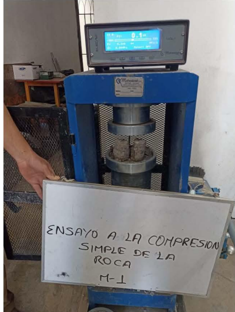
FOTO N° 03. Se muestra ensayo de la Resistencia a la Compresión Simple de la muestra 1
