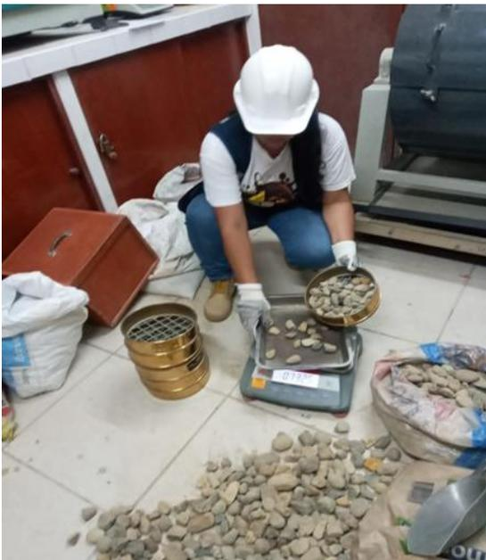
**Figura 63:** Pesaje del agregado grueso
