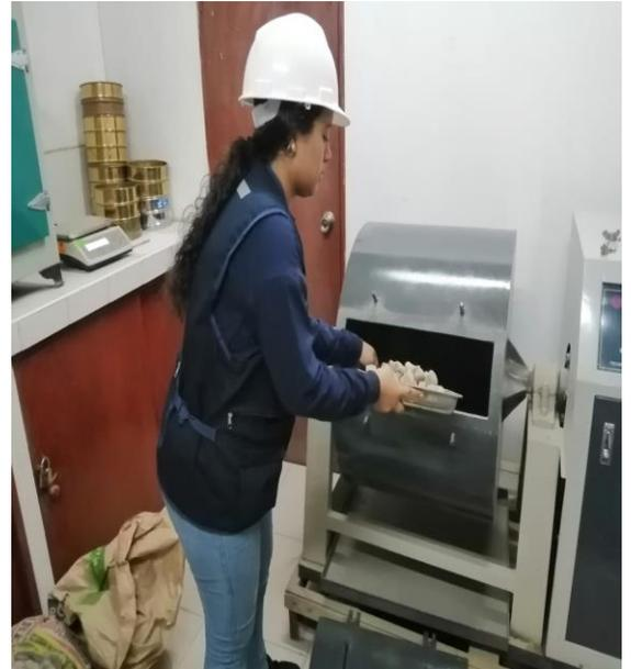
**Figura 86:** Tesista introduciendo el agregado grueso en la maquina Los Ángeles
