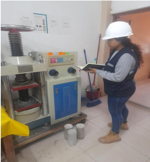
**Figura 81:** Anotando la resistencia a los 14 días
