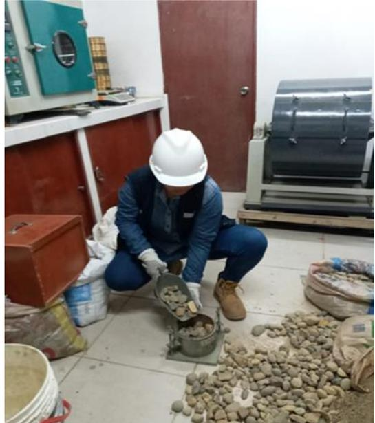
**Figura 66:** Incorporando el agregado grueso
