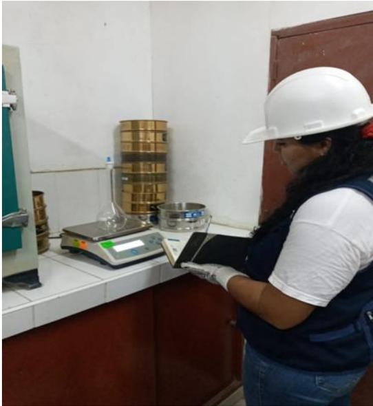
**Figura 61:** Pesaje del matraz vacío
