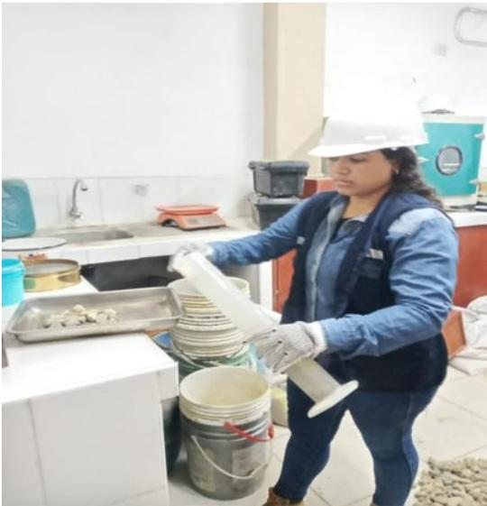
**Figura 59:** Determinando el contenido de humedad
