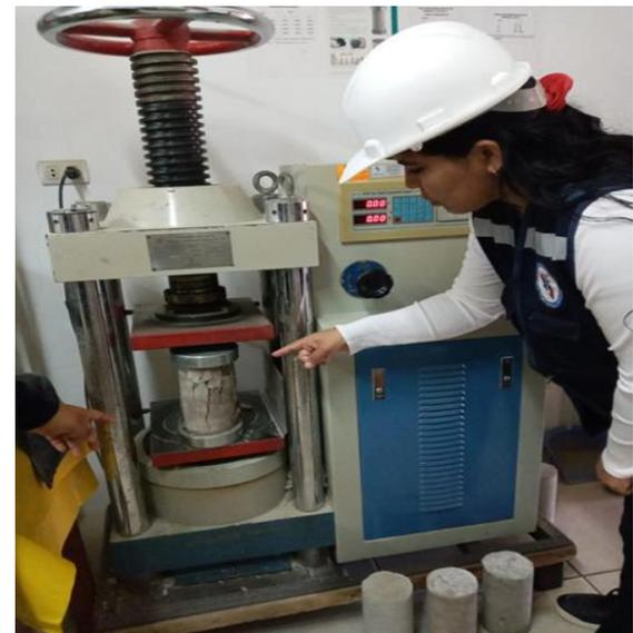
**Figura 80:** Observando las características de la rotura a los 7 días
