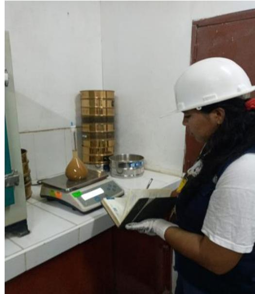
**Figura 62:** Pesaje del matraz lleno con limos
