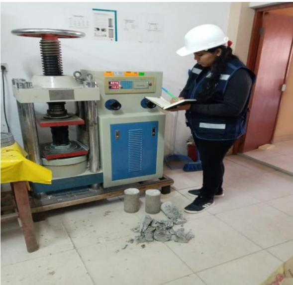
**Figura 83:** Anotando los valores de rotura
