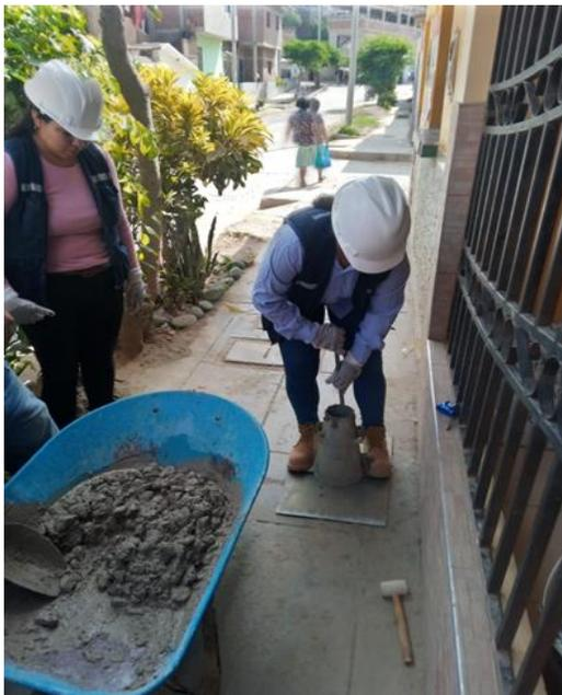
**Figura 71:** Chuceando el cono de Abrams
