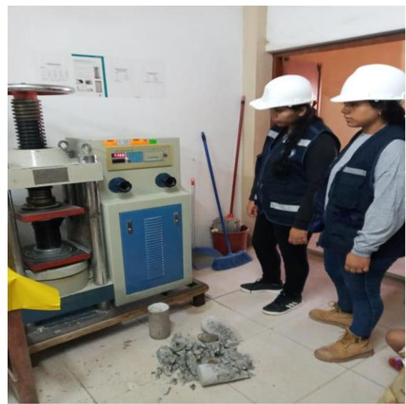
**Figura 84:** Ambas testistas observando las roturas de los especímenes
