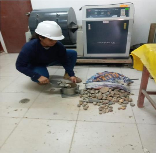
**Figura 57:** Incorporando agregado grueso al tamiz
