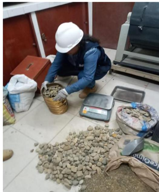
**Figura 64:** Tamizando el agregado grueso
