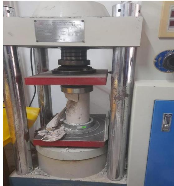
**Figura 90:** Momento de la rotura de la probeta
