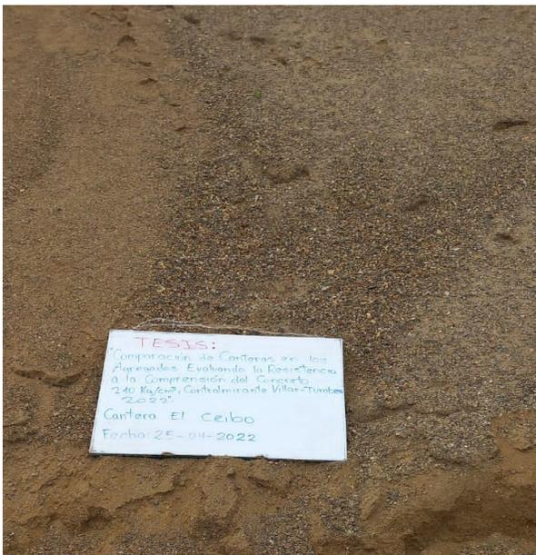
**Figura 48:** Agregado fino de la cantera El Ceibo
