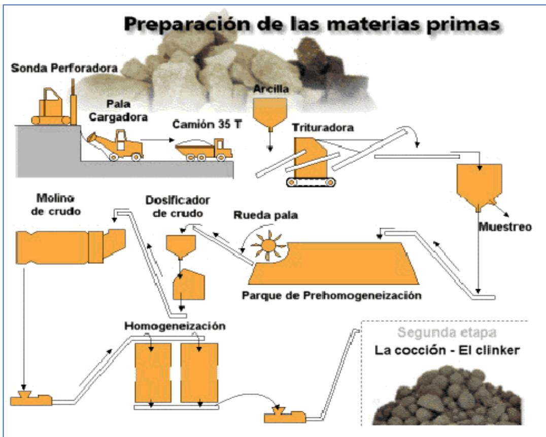
**Figura 1:** Proceso de la producción de cemento
