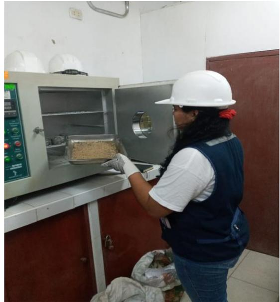
**Figura 55:** Introduciendo los agregados al autoclave
