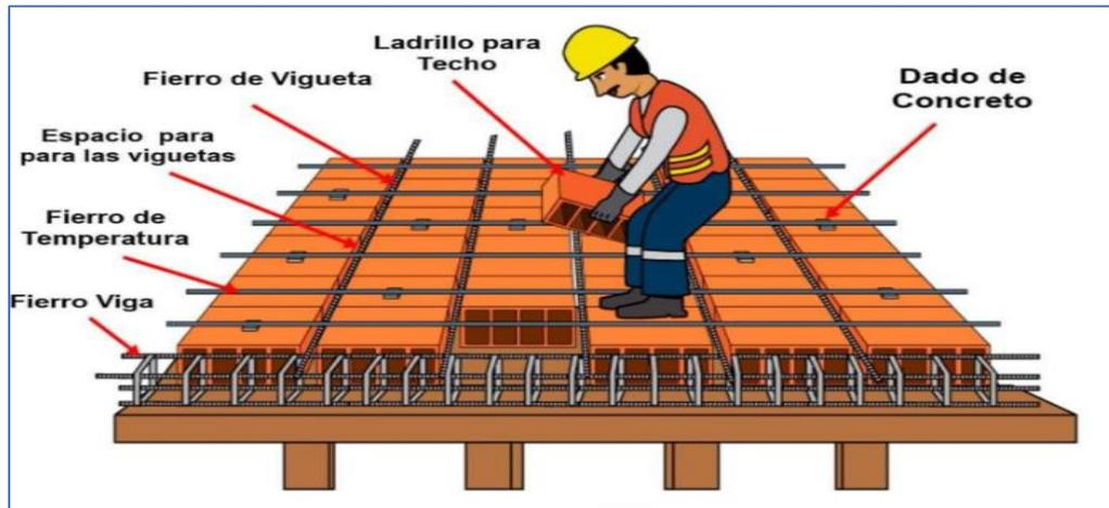
**Figura 23:** Disposición del fierro de refuerzo de la losa aligerada
