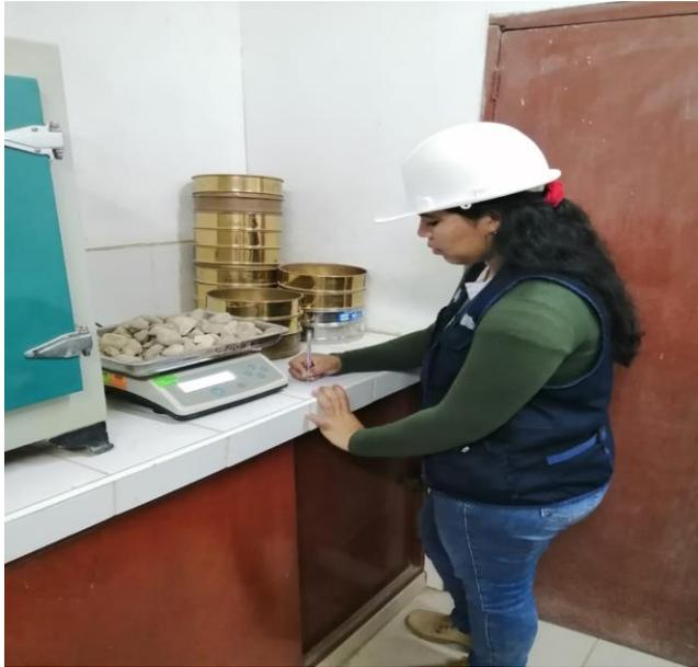
**Figura 85:** Tesista pesando el agregado grueso
