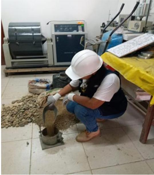
**Figura 65:** Incorporando el agregado fino
