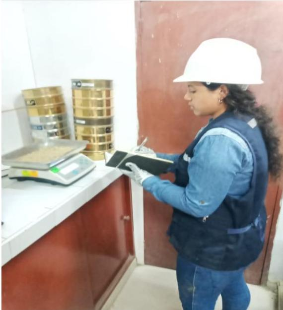
**Figura 54:** Tesista anotando el peso del agregado fino
