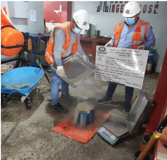
Figura 40: Vaciado de material en estado suelto
