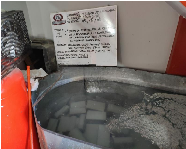
Figura 67: Curado de especímenes
