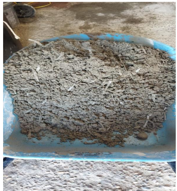
Figura 51: Mezcla de concreto con fibra PET
