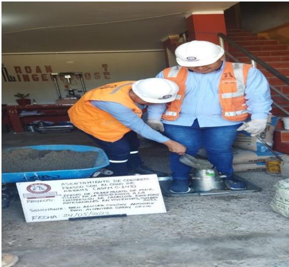
Figura 56: Vaciado de primera capa
