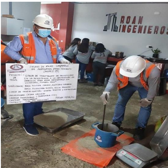
Figura 42: Golpeo de muestra con varilla
