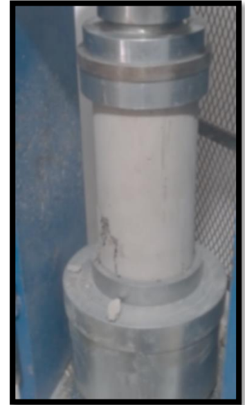
Rotura de probeta: Concreto + Fibra de Carbono 0.54% - Tipo de Rotura Cono y Corte (C) – 14 días
