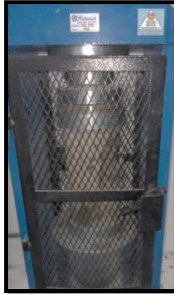
Rotura de probeta: Concreto + Fibra de Carbono 0.54% - Tipo de Rotura Corte (D) – 14 días
