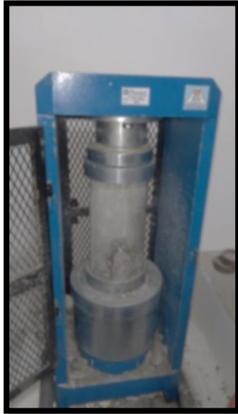
Rotura de probeta: Concreto + Fibra de Carbono 0.54% - Tipo de Rotura Cono y Corte (C) – 14 días
