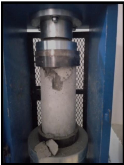
Rotura de probeta: Concreto Patrón – Tipo de Rotura de Cono y Corte (C) – 14 días
