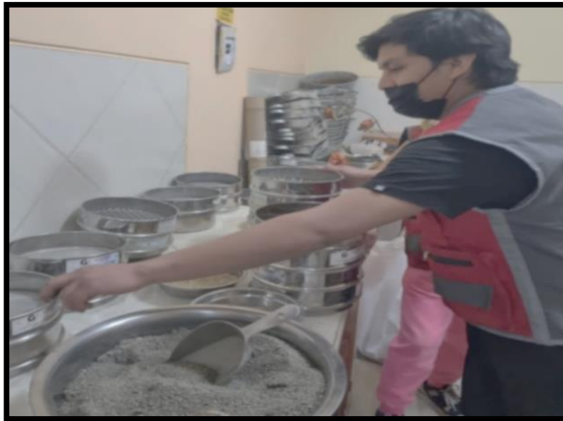
Ensayo de Granulometria de Agregado Fino – Malla N° 04
