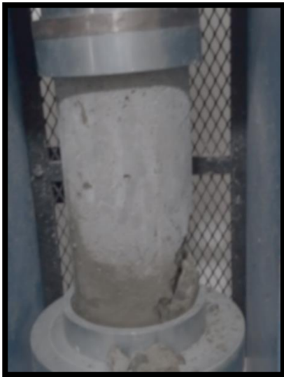
Rotura de probeta: Concreto + Fibra de Carbono 1.08% - Tipo de Rotura Cono y Corte (C) – 14 días
