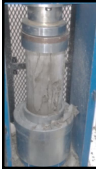
Rotura de probeta: Concreto + Fibra de Carbono 0.54% - Tipo de Rotura Cono y Corte (C) – 14 días
