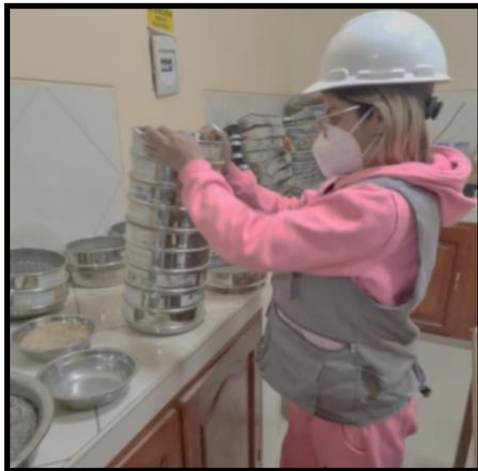
Ensayo de Granulometria de Agregado Grueso – Malla 2”
