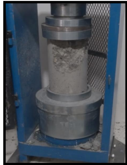
Rotura de probeta: Concreto Patrón – Tipo de Rotura de Cono y Corte (C) – 14 días
