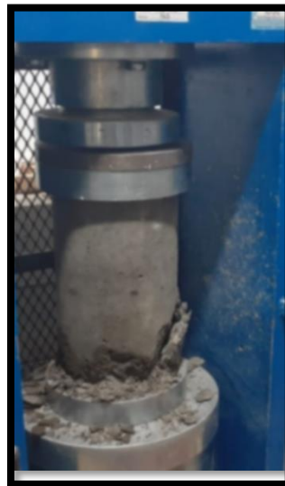
Rotura de probeta: Concreto + Fibra de Carbono 1.08% - Tipo de Rotura Cono y Corte (C) – 14 días
