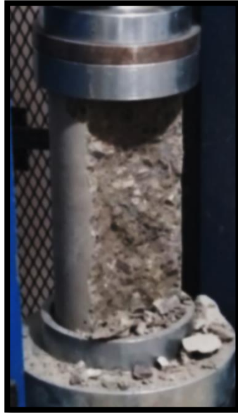
Rotura de probeta: Concreto + Fibra de Carbono 0.54% - Tipo de Rotura Columnar (E) – 7 días
