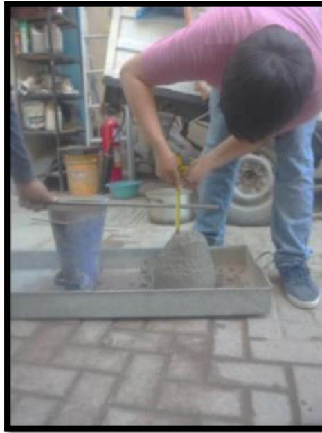
Prueba Cono de Abrams – Asentamiento de 4"
