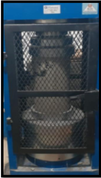
Rotura de probeta: Concreto + Fibra de Carbono 0.54% - Tipo de Rotura Corte (D) – 14 días
