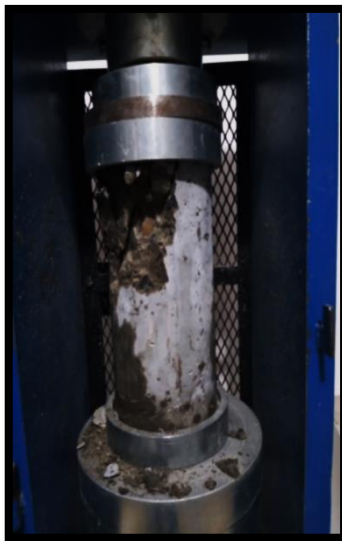
Rotura de probeta: Concreto + Fibra de Carbono 1.08% - Tipo de Rotura Corte (D) – 7 días
