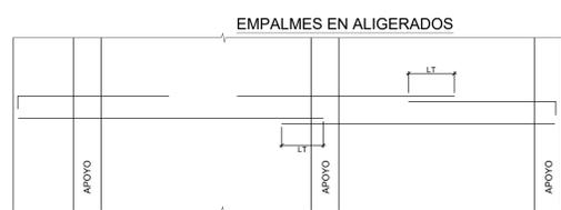
NOTA (a): NO EMPALMAR MAS DEL 50% DEL AREA TOTAL EN UNA MISMA SECCION
