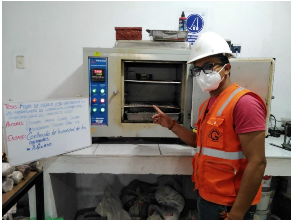
Anexo 10: Ensayo de contenido de humedad del A.G
