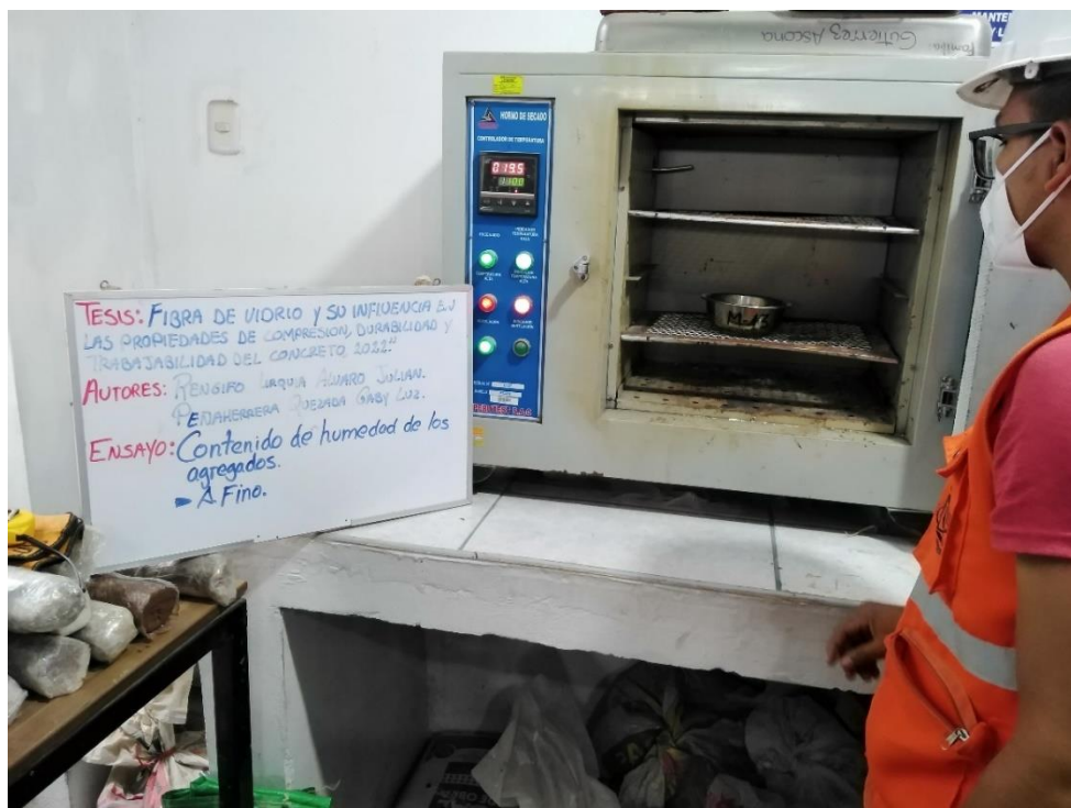
Anexo 11: Ensayo de contenido de humedad del A.F
