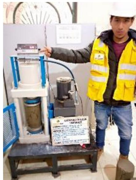
Figura 13: rotura de probetas cilíndricas, edad 20 hrs.
