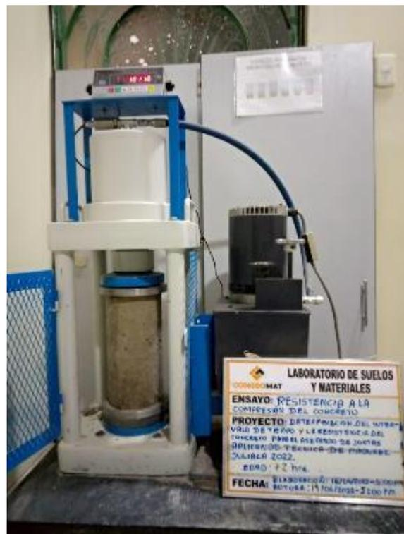
Figura 15: rotura de probetas cilíndricas, edad 7 días
