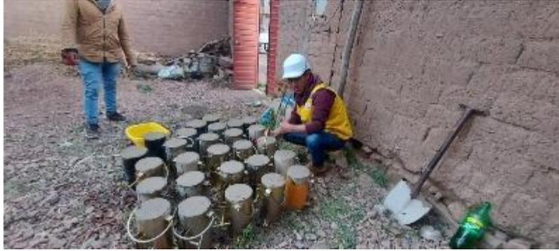
Figura 3: elaboración de probetas cilíndricas in-situ
