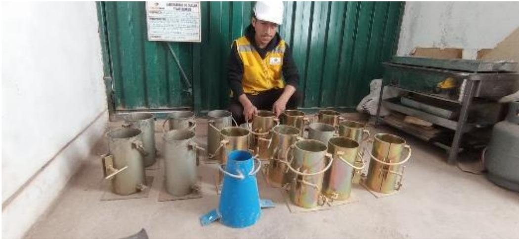
Figura 1: probetas cilíndricas usadas
