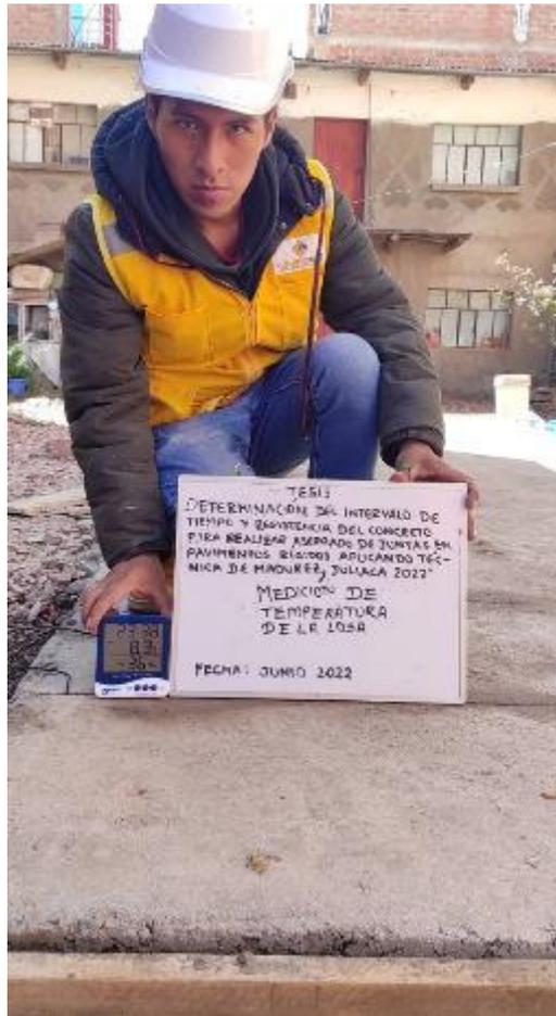
Figura 20: monitoreo de temperatura en la losa de concreto simple
