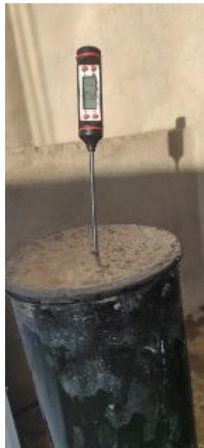
Figura 5: termómetro digital introducido en probeta cilíndrica
