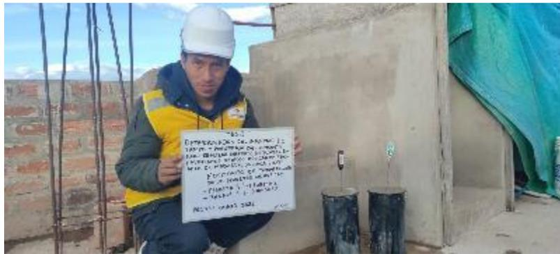
Figura 7: monitoreo de temperatura en probetas cilíndricas
