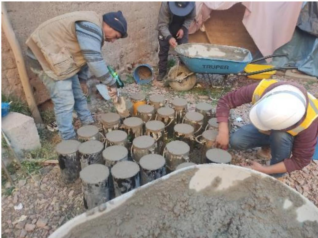
Figura 2: elaboración de probetas cilíndricas in-situ
