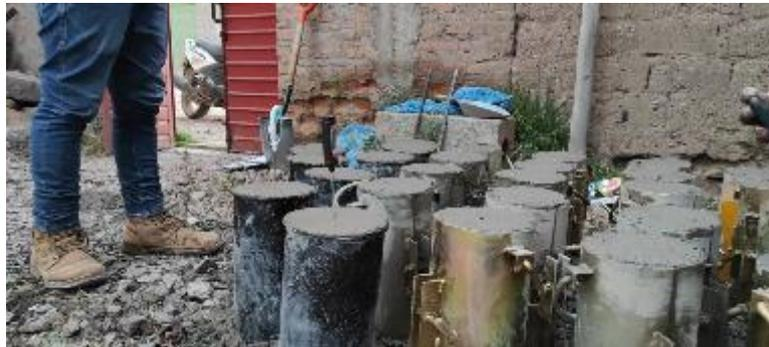
Figura 4: termómetros digitales introducidos en 2 probetas cilíndricas
