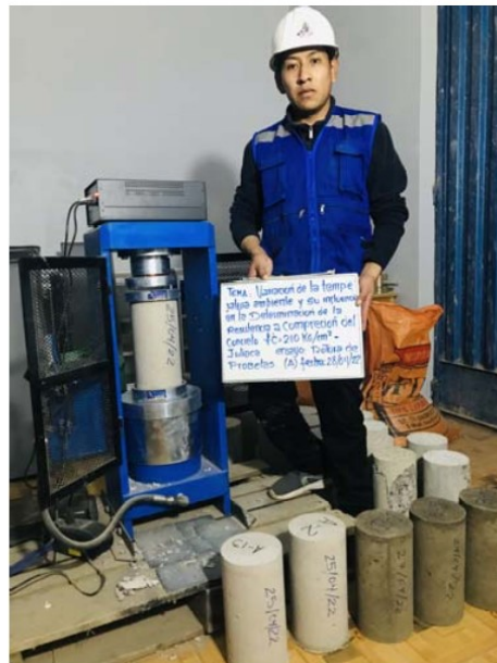
Fotografía 34. Ensayo de resistencia a compresión – Muestra In situ (B)
