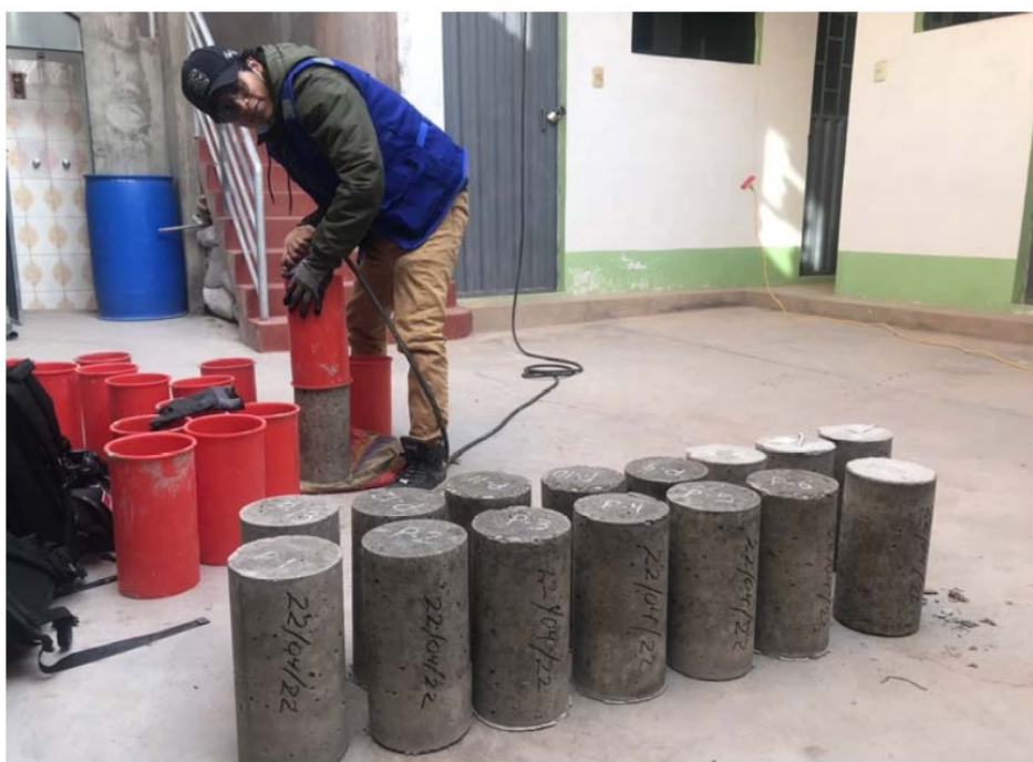
Fotografía 8. Desmolde de Probetas - Muestra Patrón (P)
