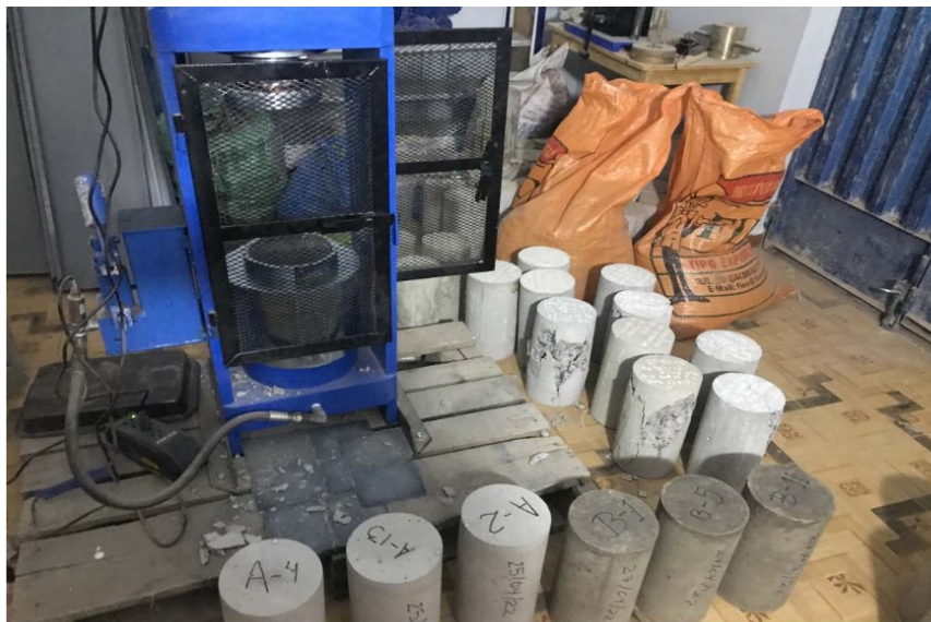
Fotografía 32. Ensayo de resistencia a compresión – Muestra In situ (A) y Muestra In situ (B)
