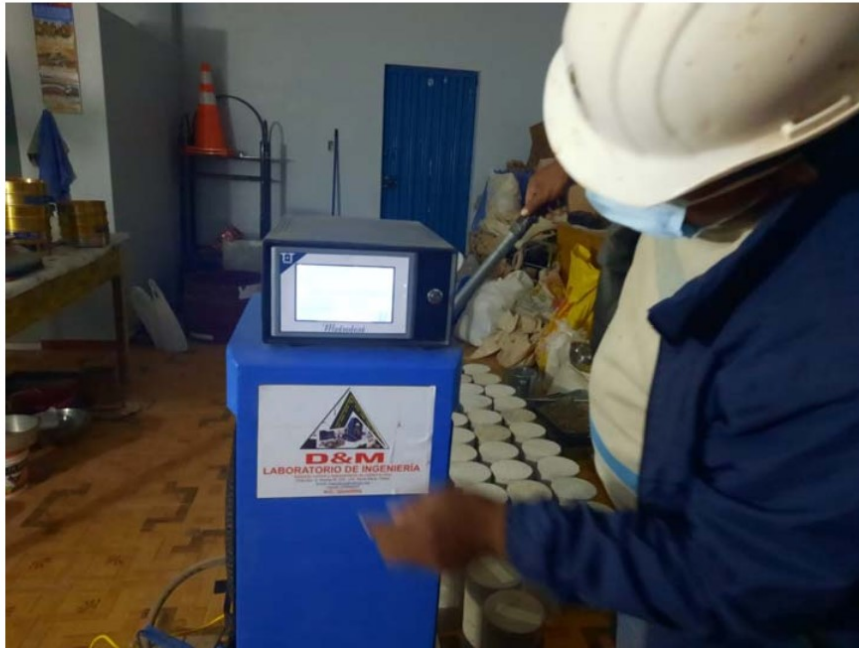
Fotografía 39. Ensayo de resistencia a compresión – Muestra In situ (B)
