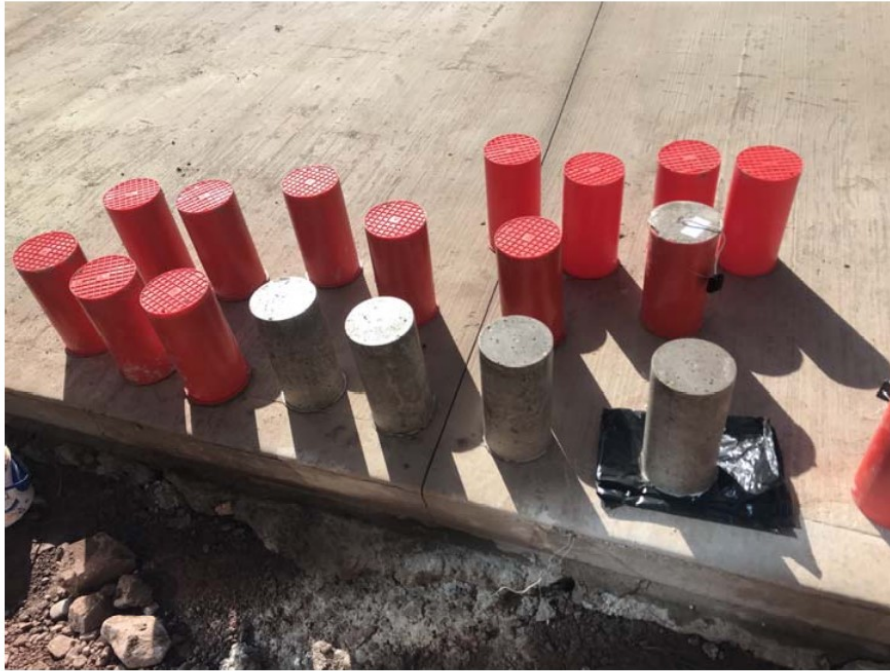
Fotografía 25. Proceso de curado – Muestra no sumergida in situ (A)
