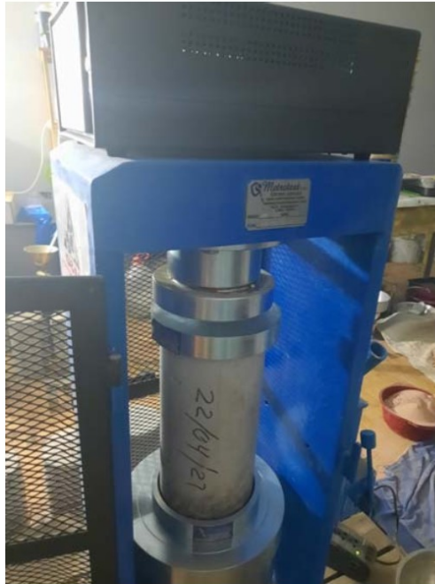
Fotografía 31. Ensayo de resistencia a compresión – Muestra Patrón (P)
