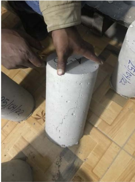
Fotografía 35. Ensayo de resistencia a compresión – Muestra In situ (A)
