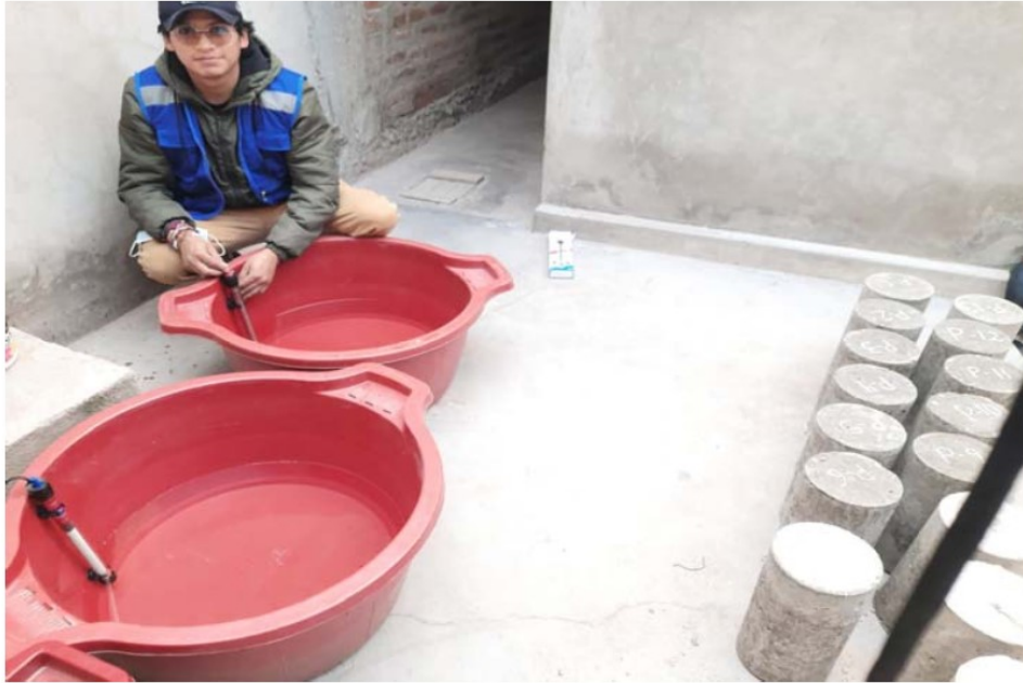
Fotografía 9. Instalación de termostatos para curado de la Muestra Patrón (P)
