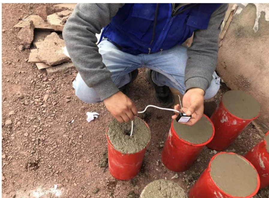
Fotografía 19. Instalación de sensores SmartRock2 - Muestra sumergida in situ (B)
