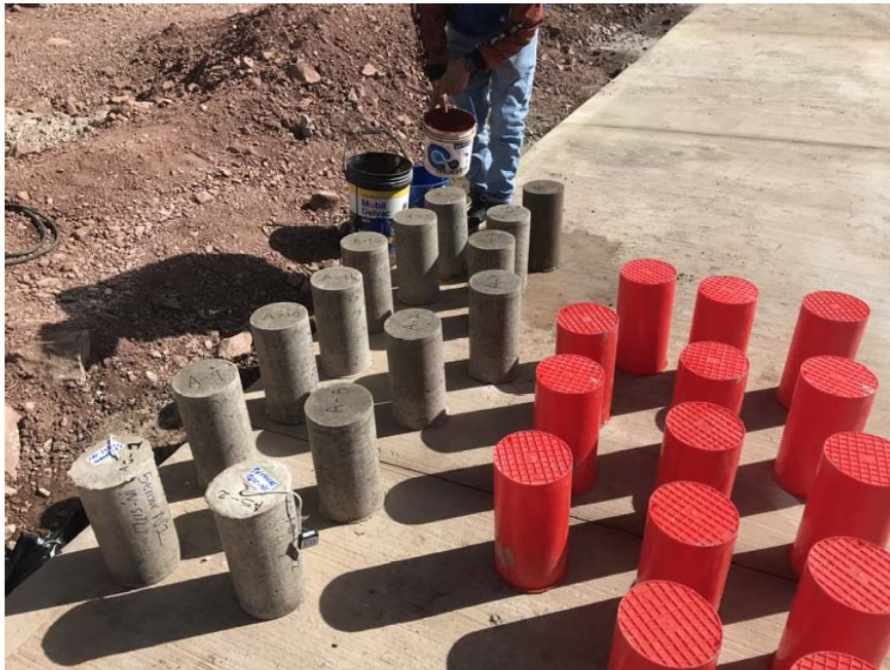
Fotografía 26. Proceso de curado – Muestra no sumergida in situ (A)
