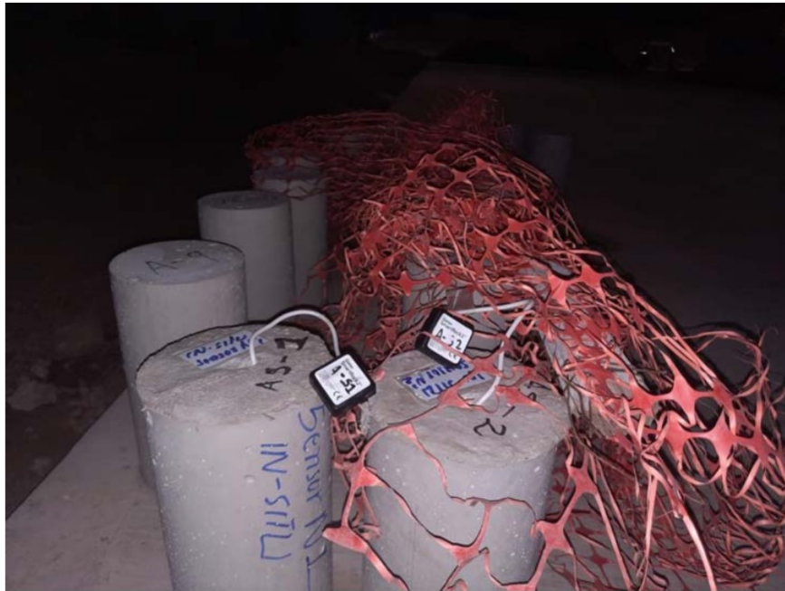
Fotografía 27. Lectura de historial de temperatura – Muestra no sumergida in situ (A)
