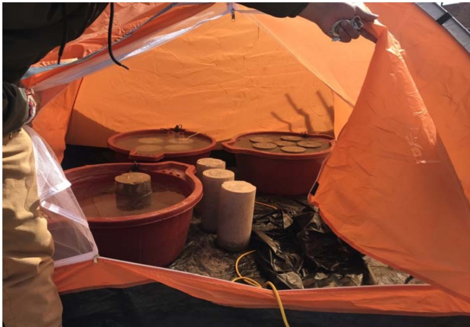
Fotografía 10. Curado de probetas en condiciones controladas - Muestra Patrón (P)
