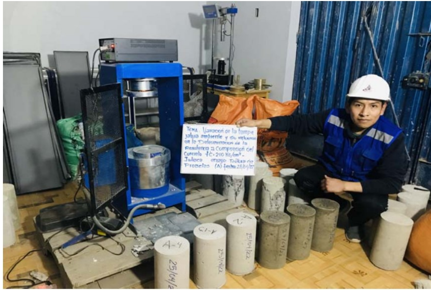
Fotografía 33. Ensayo de resistencia a compresión – Muestra In situ (A)
