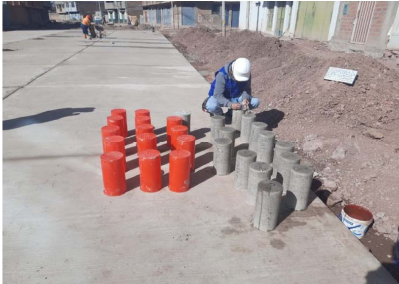
Fotografía 15. Lectura de desarrollo de temperatura del concreto – Muestra in situ (A)
