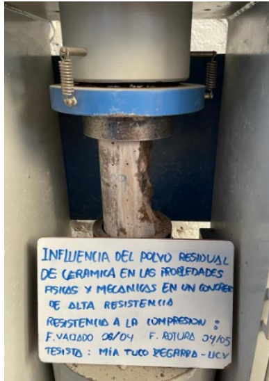
Figura 14. Ensayo de resistencia a la compresión del concreto.
