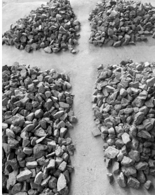
Ensayo de peso unitario suelto y compactado
