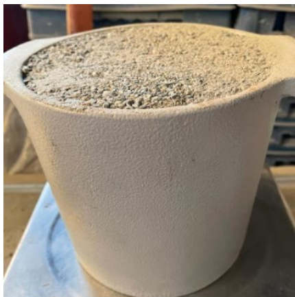
Figura 3. Ensayo de peso unitario suelto de agregado fino.
