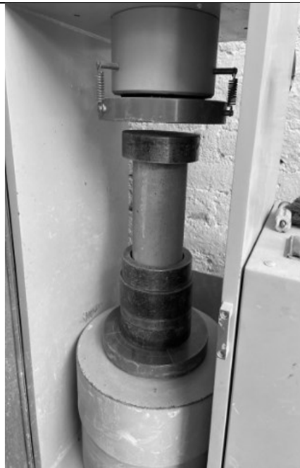
Ensayo de resistencia a la compresión
