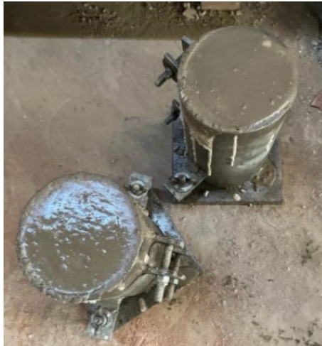
Figura 9. Preparación de las probetas de concreto.
