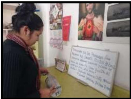
Obtención de la medida longitudinal de la probeta con escala en L de 90°.
