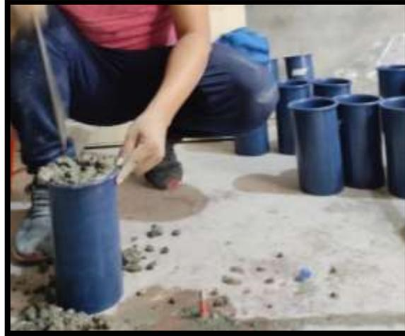
Chuzado de las probetas de concreto
