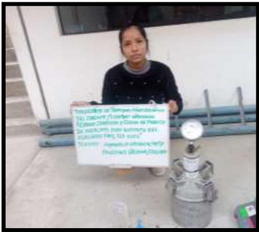
Ensayo de contenido de aire del concreto
