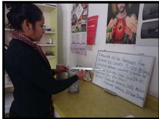
Obtención de la medida diametral de la probeta con la escala de vernier.
