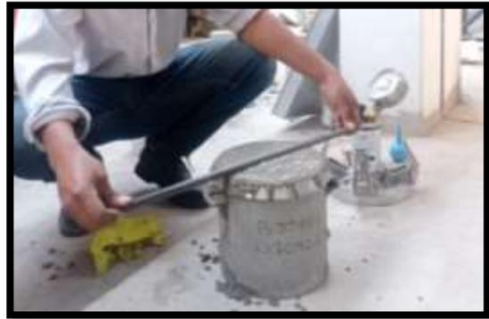
Ensayo del peso unitario del concreto fresco
