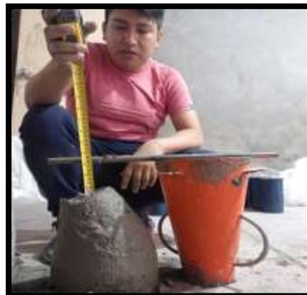
Asentamiento del concreto sustituyendo el agregado fino por ceniza de tronco de eucalipto.
