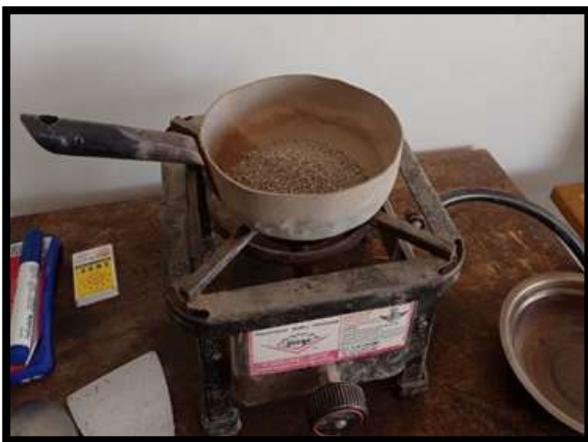
Elaboración del contenido de humedad del agregado fino.
