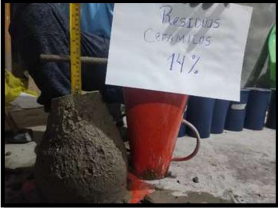
Asentamiento del concreto sustituyendo el agregado fino por residuos cerámicos.
