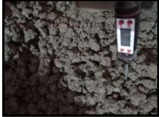
Ensayo de temperatura del concreto
