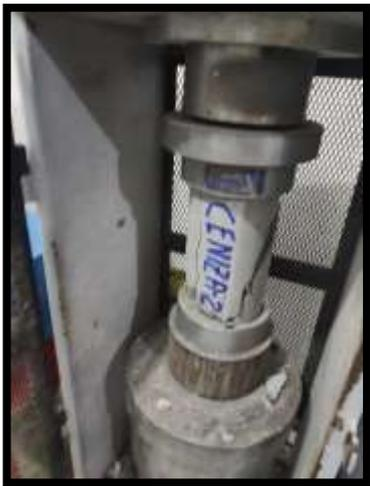
Ensayo a compresión de las probetas de concreto con ceniza.
