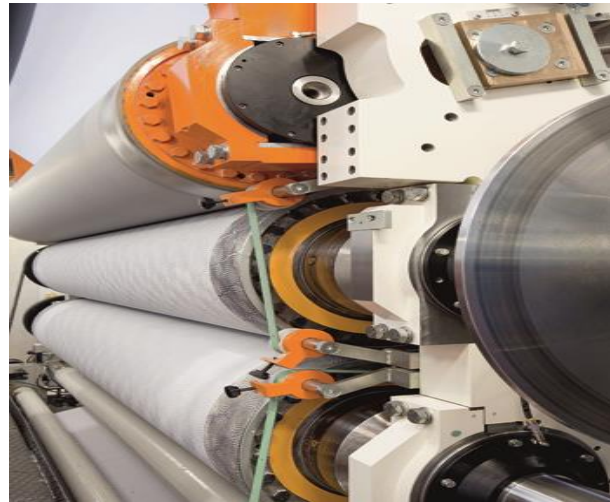
Figura 19. Proceso de Gofrado
