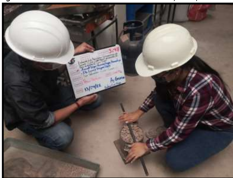
Figura 6. Proceso de determinación del ensayo de peso unitario del agregado
