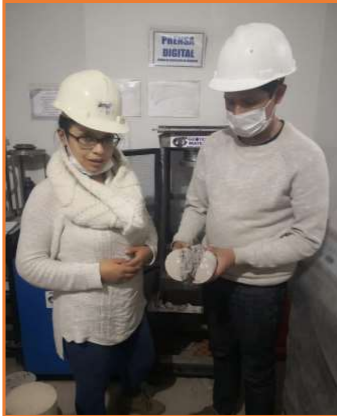
Figura 28. Probetas rotas en resistencia en tracción
