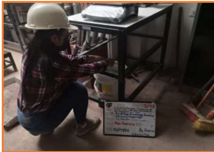
Figura 10. Ensayo de gravedad específica del agregado grueso
