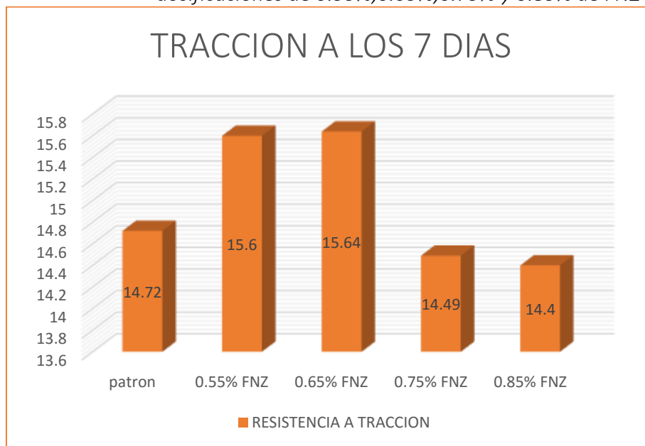
Figura 29. Resistencia a tracción a los 7 días de un concreto 280kg/cm 2 y con dosificaciones de 0.55%,0.65%,0.75% y 0.85% de FNZ
