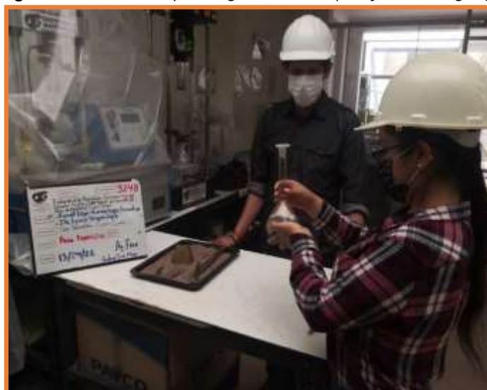
Figura 8. Ensayo de gravedad específica del agregado fino
