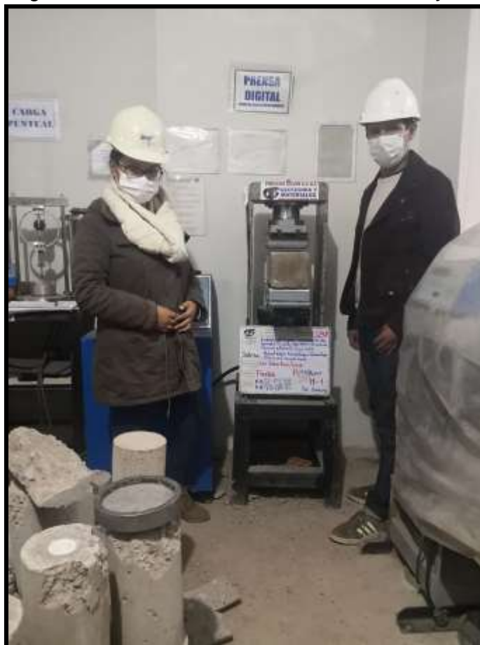
Figura 32. Probetas rotas en resistencia en flexión
