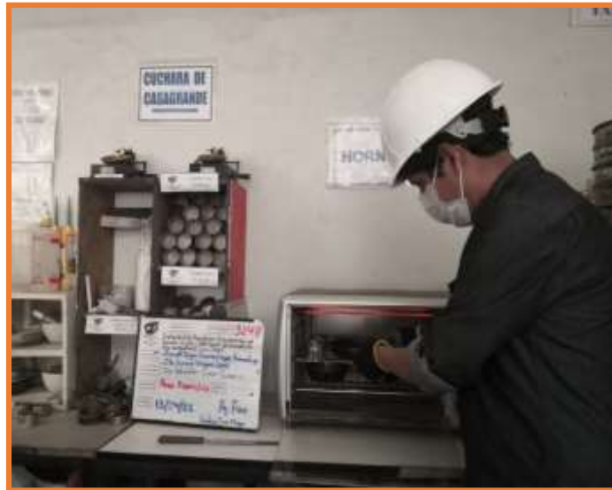
Figura 9. Ensayo de gravedad específica del agregado fino
