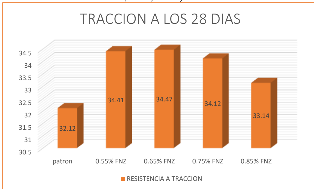
Figura 31. Resistencia a tracción a los 28 días de un concreto 280kg/cm 2 y con dosificaciones de 0.55%,0.65%,0.75% y 0.85% de FNZ
