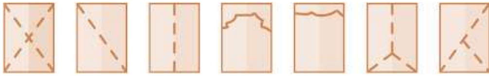
Figura 6. Tipos de fractura o falla al realizar el ensayo a la compresión.
