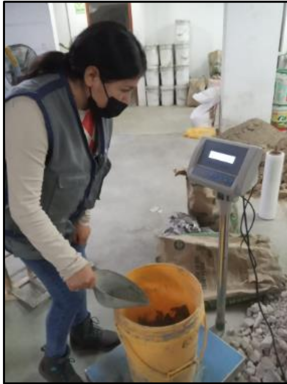
Figura 18. Procedimiento de pesaje del cemento
