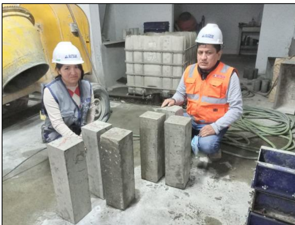
Figura 26. Prismas para la prueba de resistencia a flexión
