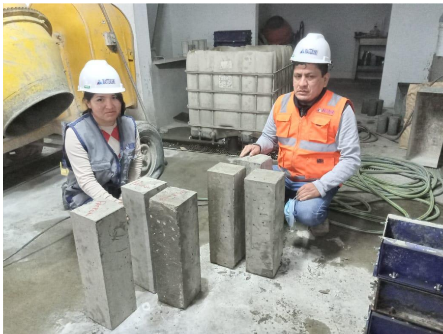
Figura18. Ensayos a la resistencia de flexión del concreto.
