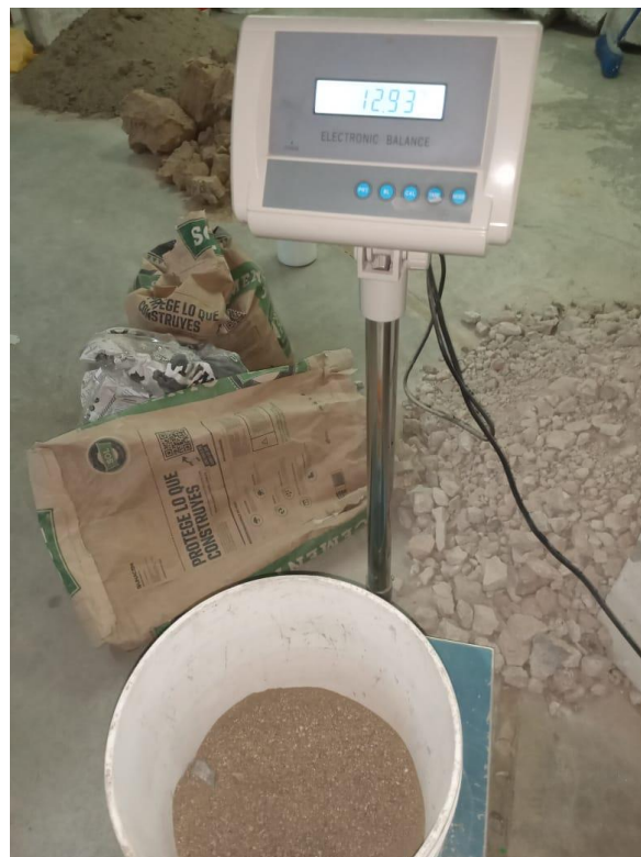
Figura 04. Peso de los agregados en el Laboratorio
