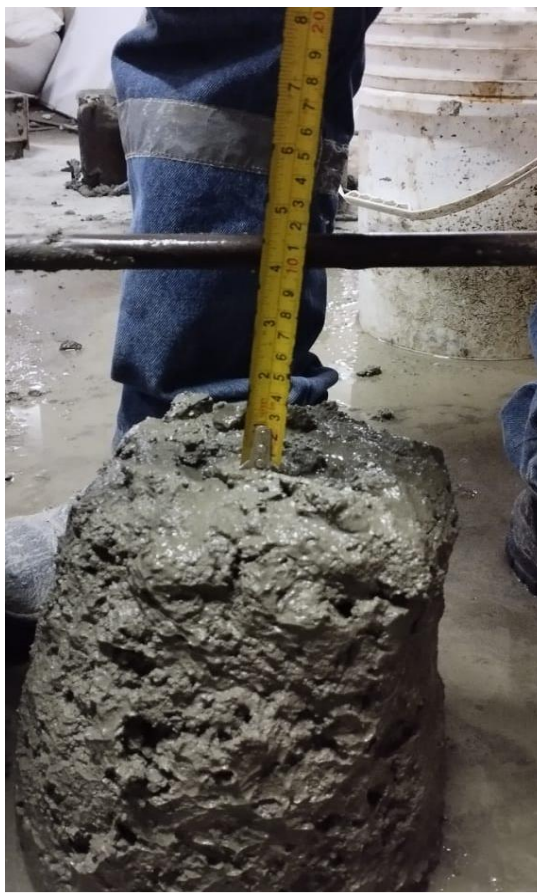
Figura 08. Medición del asentamiento del concreto en el cono de Abram
