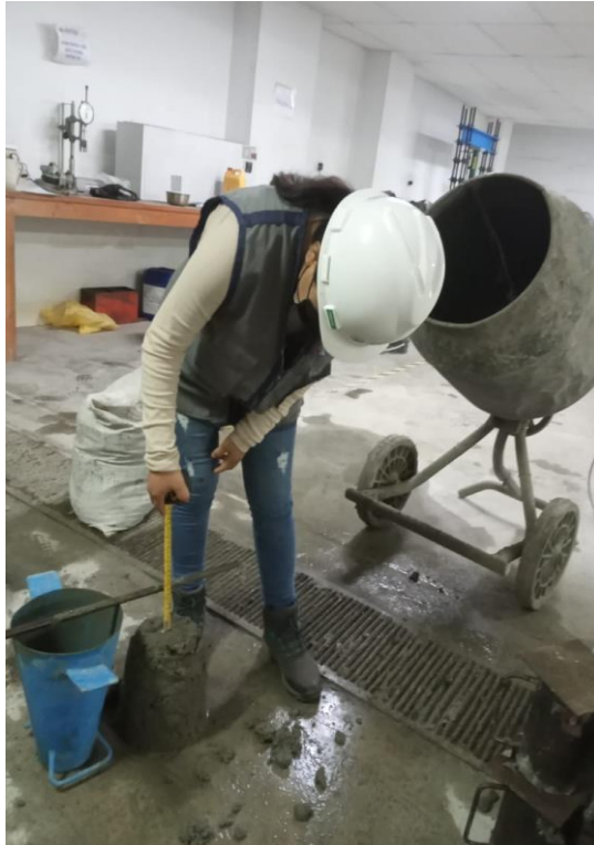
Figura 07. Medición del asentamiento del concreto en el cono de Abram
