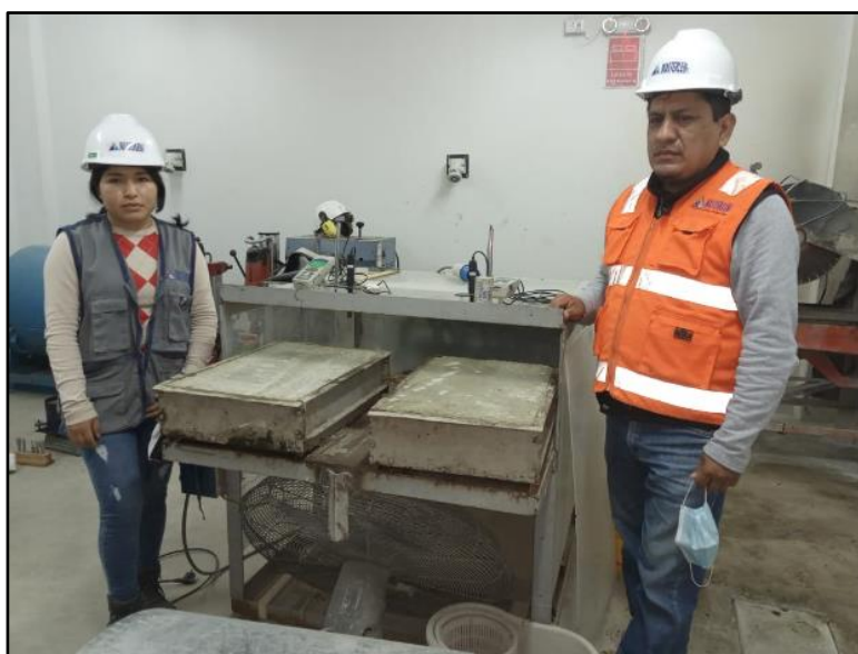
Figura 22. Losas de concreto normal para evaluación de fisuras
