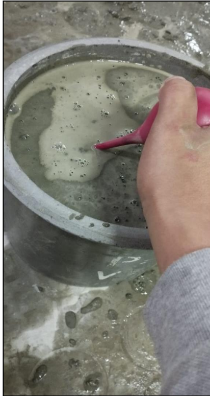
Figura 14. Prueba de exudación del concreto fresco
