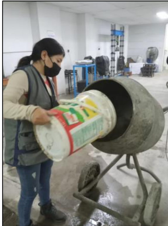
Figura 20. Dosificación del agua de mezclado
