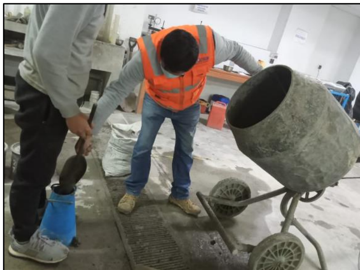
Figura 16. Colocación del concreto fresco en el cono de Abrams
