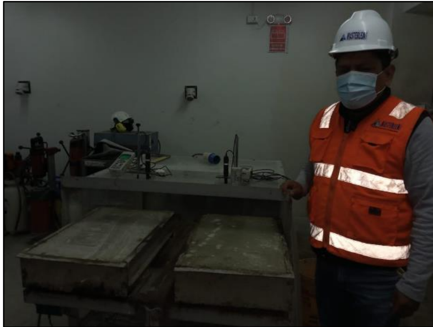
Figura 21. Losas de concreto normal para evaluación de fisuras
