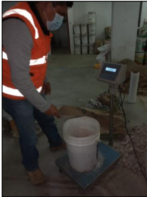
Figura 15. Pesaje de agregados para la mezcla
