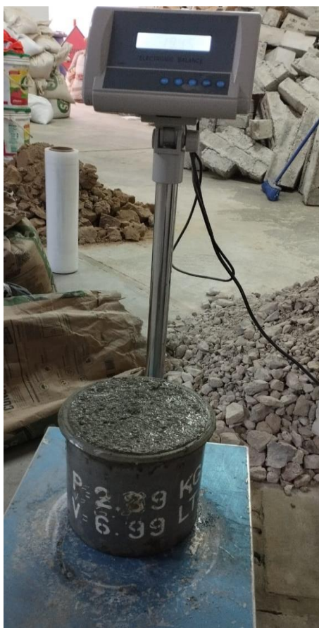
Figura 10. Pesando el concreto
