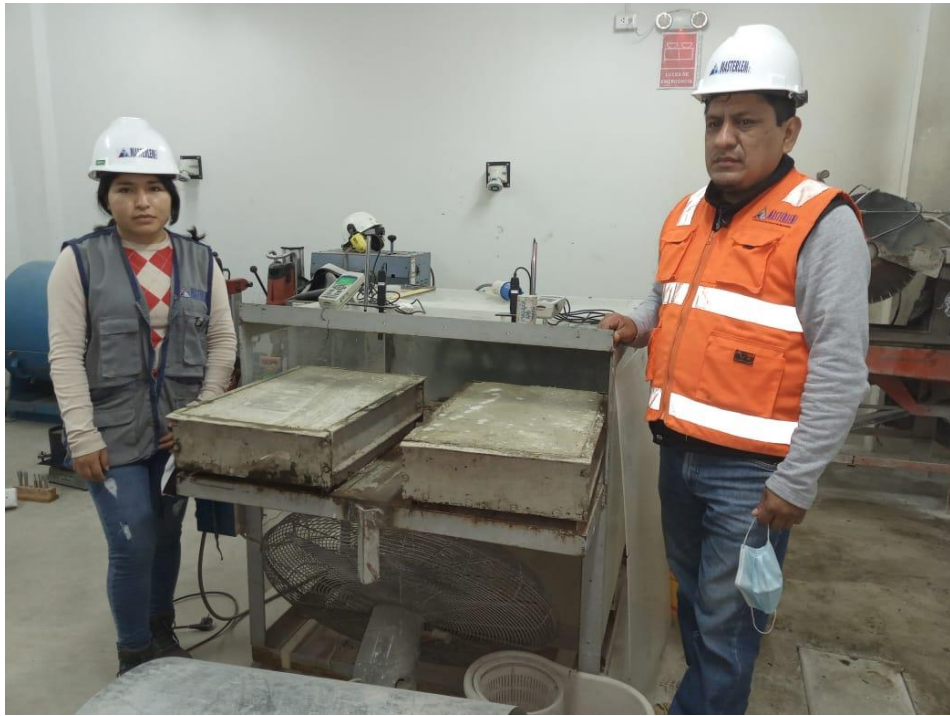
Figura 15. Moldes ya fraguados
