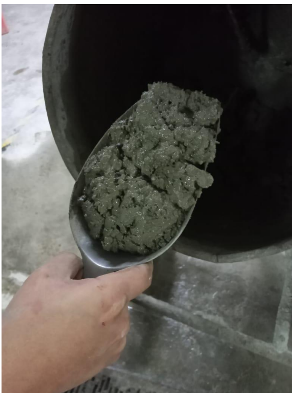
Figura 09. Retirando el concreto de la mezcladora
