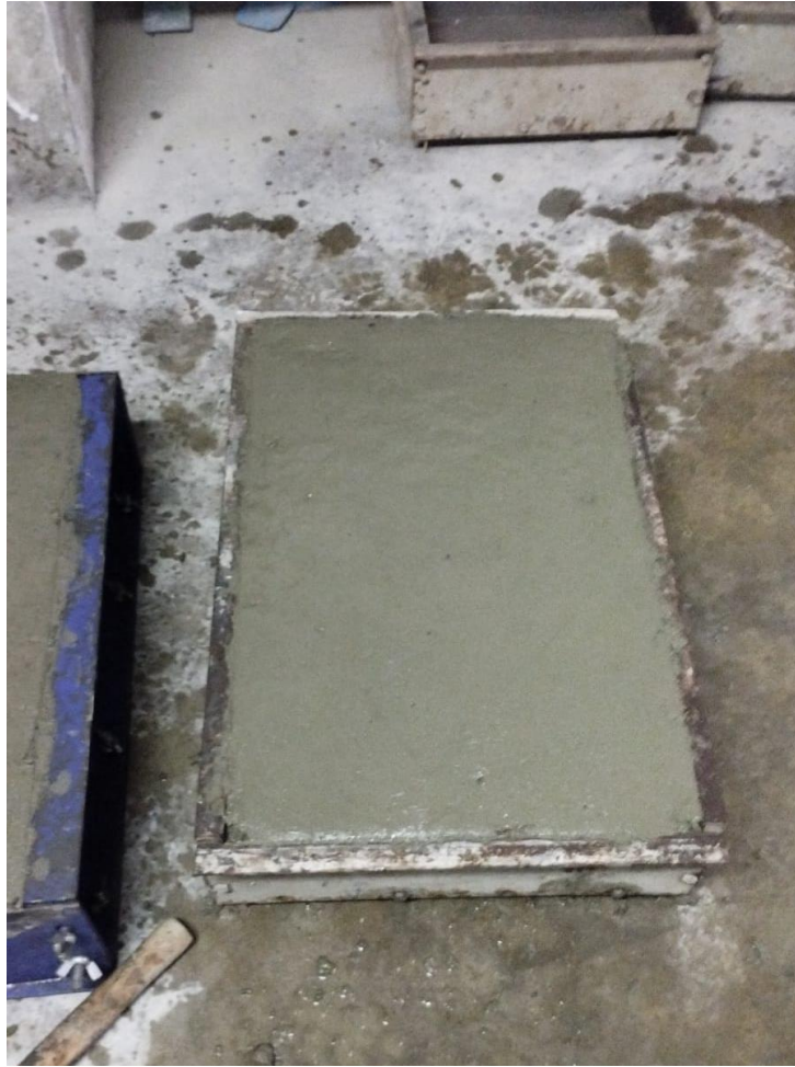
Figura 13. Vaciado del concreto en los moldes de 0.56 x 0.35 x0.10 para realizar el ensayo de contracción plástica.
