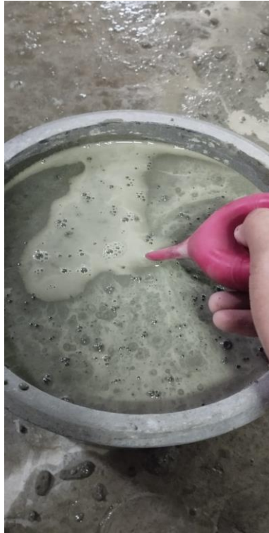
Figura 11. Realizando el ensayo de Exudación
