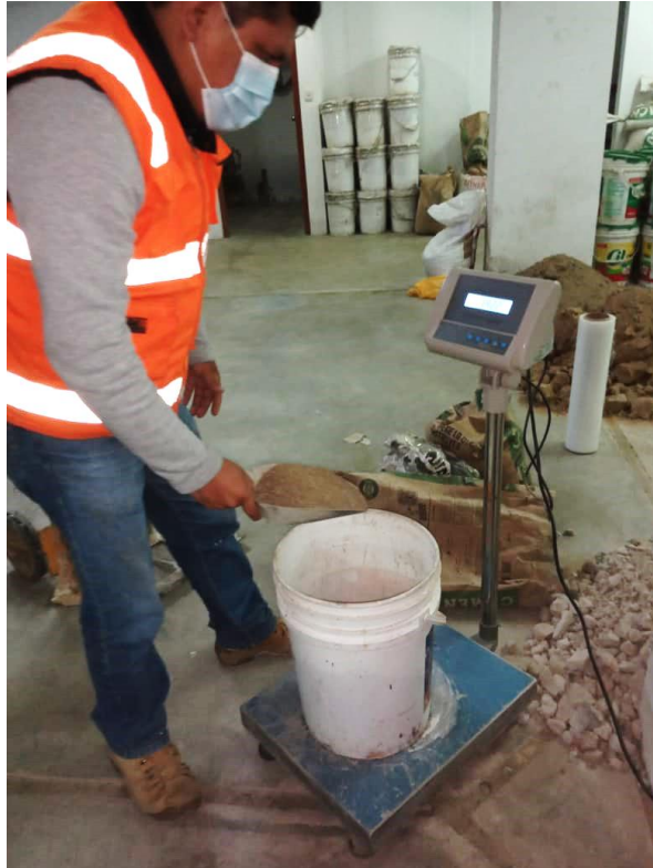
Figura 03. Pesando los agregados en el Laboratorio
