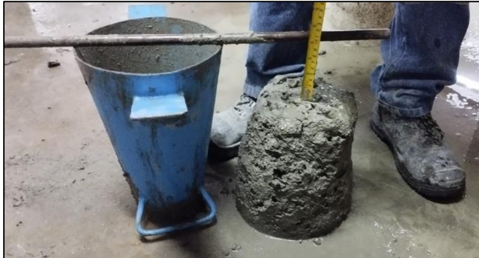
Figura 17. Prueba del slump del concreto fresco
