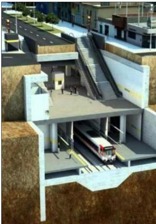
*Fuente: Proinversión – Construcción de estaciones por método Cut and Cover*
