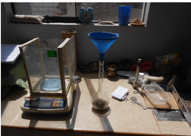
Descripción: Ensayo de gravedad específica de los suelos
