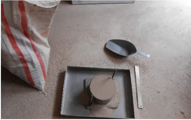
Descripción: Ensayos de peso unitario suelto de muestras
