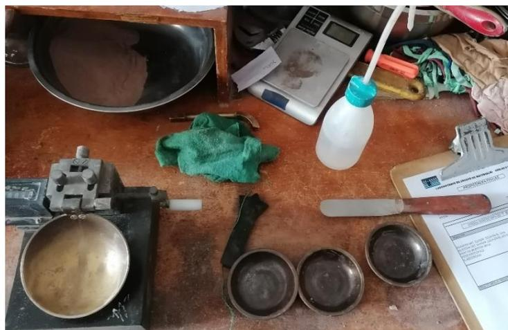
**Figura 16.** Limite Liquido - Equipos utilizados para el ensayo (Fuente Propia)
