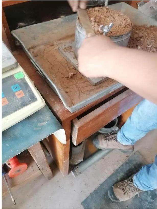
**Figura 20.** Ensayo Proctor de la Subrasante. (Fuente Propia)
