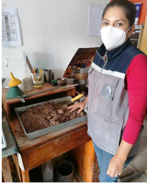
**Figura 19.** Ensayo Proctor de la Subrasante. (Fuente Propia)
