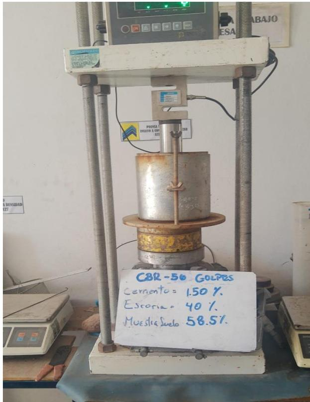
**Figura 26.** Ensayo de CBR para determinar el mejoramiento de sus propiedades
