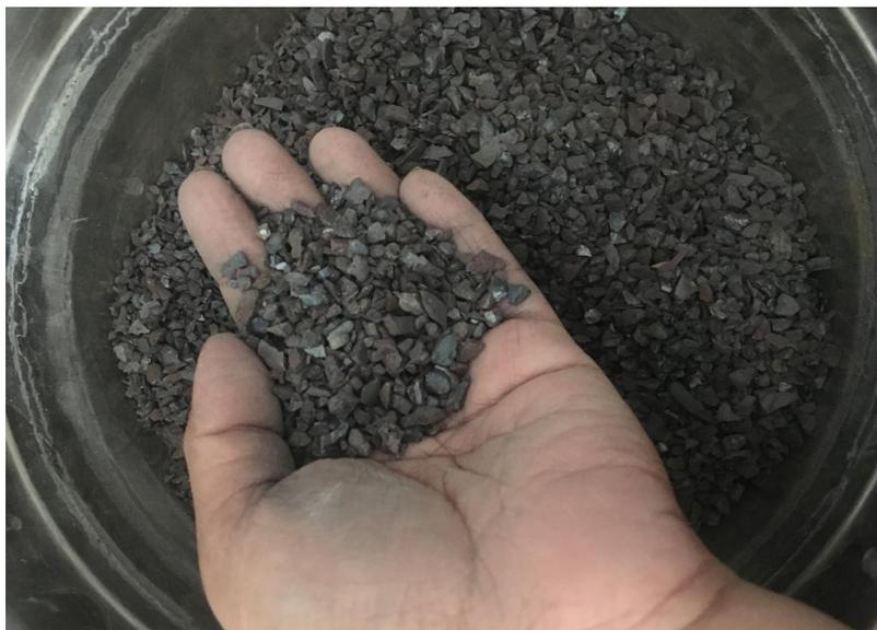
**Figura 30.** Escoria de cobre de altos hornos. (Fuente Propia)
