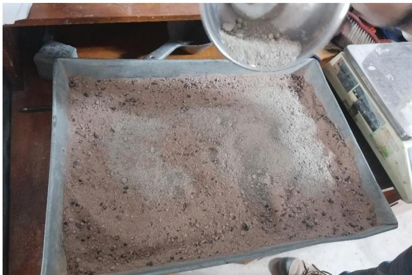
**Figura 25.** Mejoramiento de Propiedades con Escoria de Cobre y Cemento (Fuente Propia)
