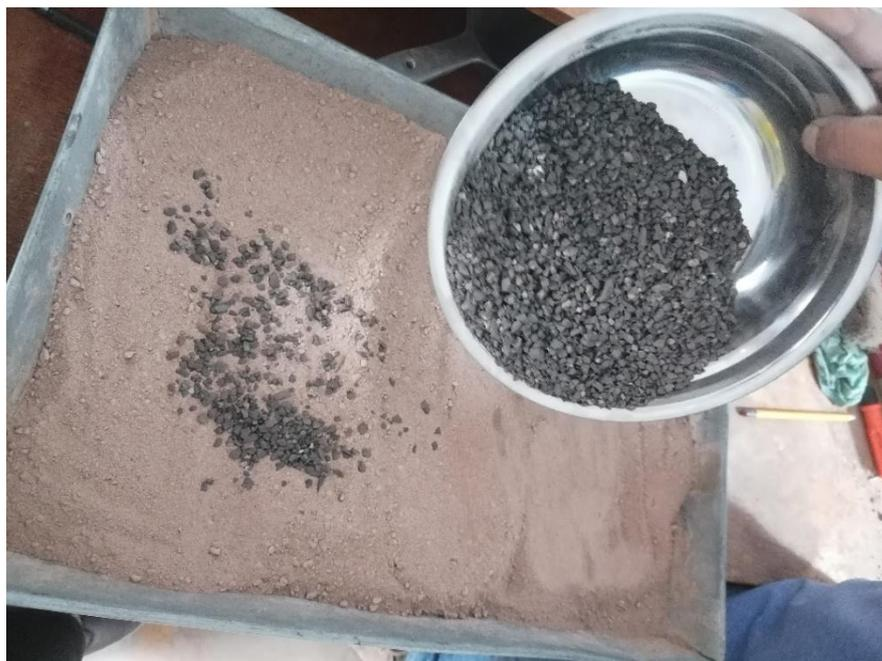
**Figura 22.** Ensayo de Proctor Modificado Combinaciones Cemento y Escoria de Cobre.
