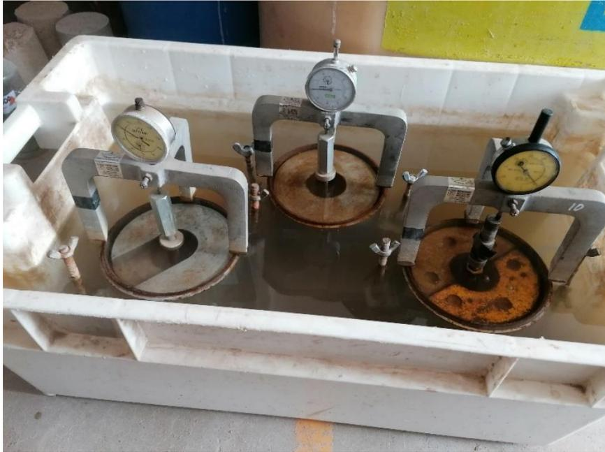
**Figura 21.** Ensayo CBR - Inmersión. (Fuente Propia)
