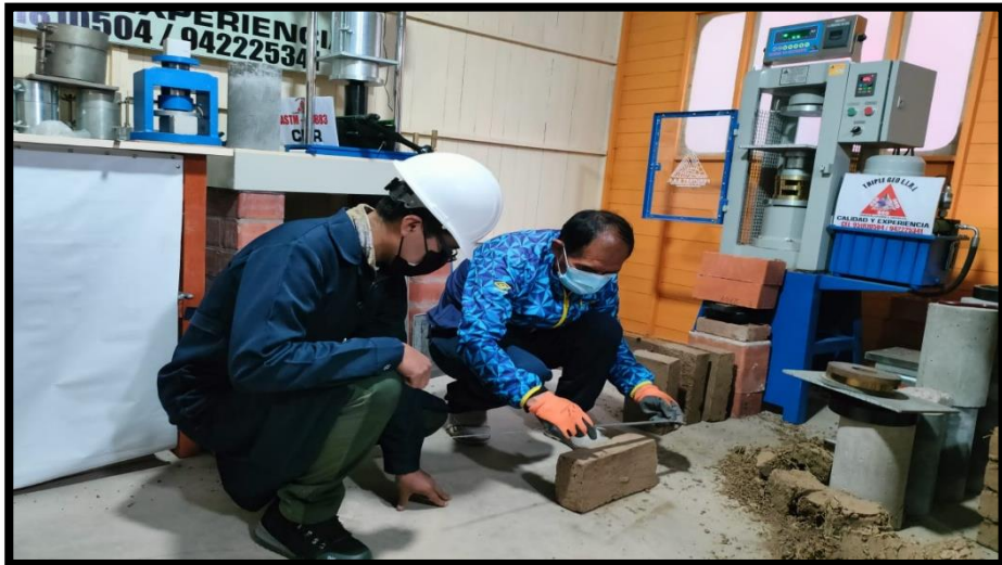
Fotografía: Medición de los adobes con (VERNIER) para la variación dimensional.
