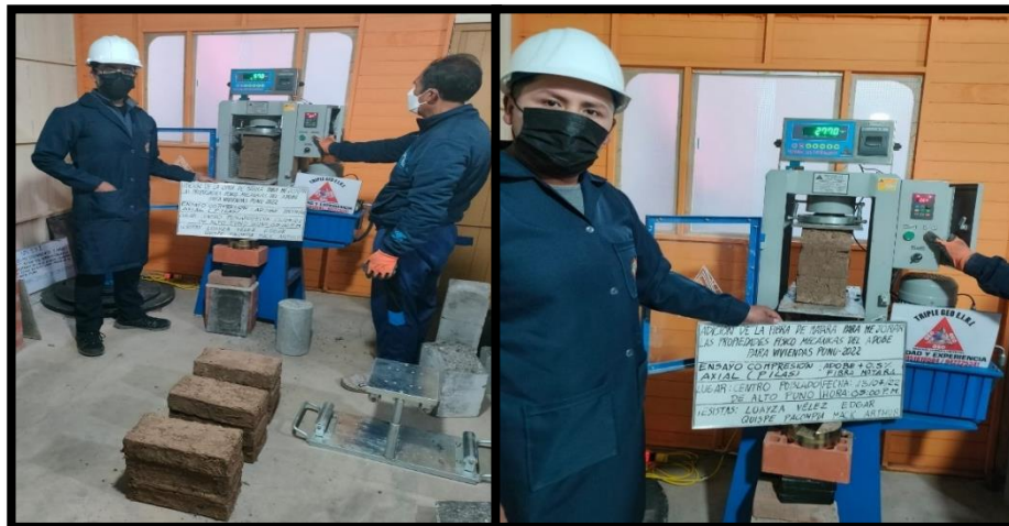
Fotografía: Rotura de adobes a 0.5% de fibra de Matara para compresión axial.
