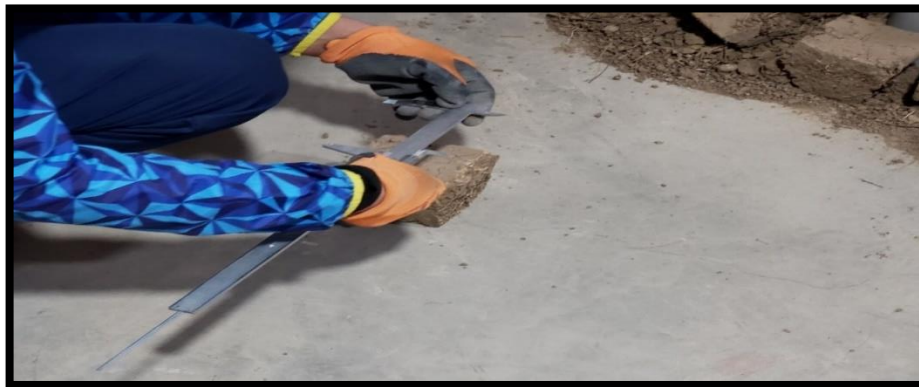
Fotografía: Herramienta utilizada para medir los adobes de 10x10x10 (VERNIER).
