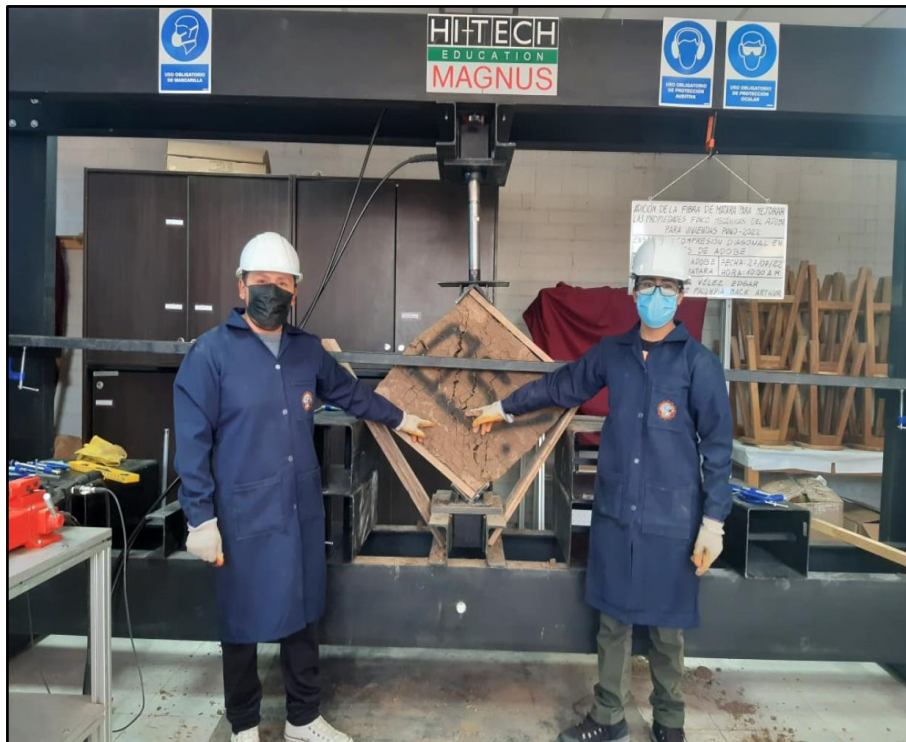
Figura 54. Rotura de los muretes ERCD.
