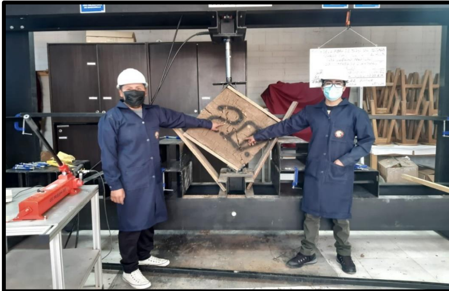
Fotografía: Fisura de murete al 2.0% en compresión diagonal.
