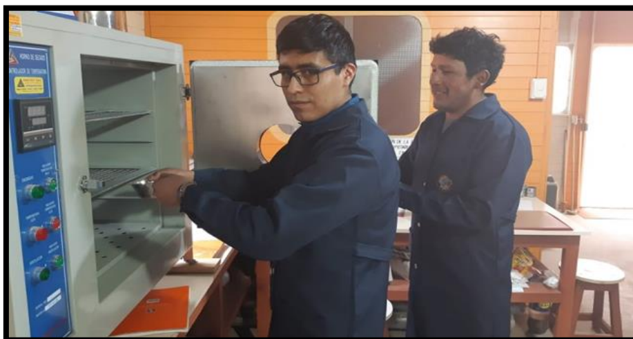
Fotografía: Horneado de suelo húmedo más tara a una temperatura de 110°C.
