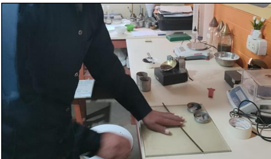
Figura 8. Ensayo de límite plástico en laboratorio.
