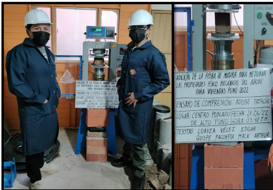
Fotografía: Rotura de adobes a ensayo de compresión.
