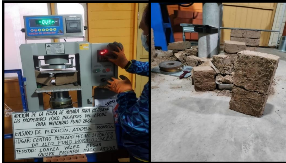
Fotografía: Rotura de los adobes 0.0%, 0.5%, 1.0%, y 2.0% a flexión.
