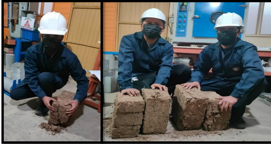
Fotografía: Prototipos después de ser sometidos al ensayo de compresión axial.
