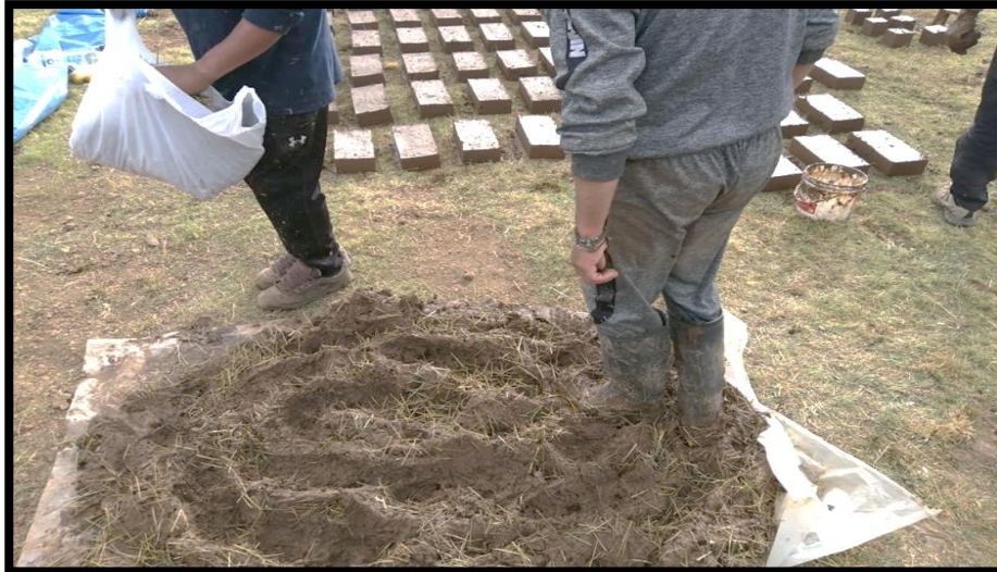
Fotografía: adición y mezclado de la fibra de Matara al 2.0%.
