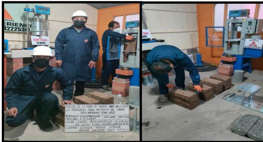
Fotografía: Medición y rotura de adobes patrón para el ensayo de compresión axial.
