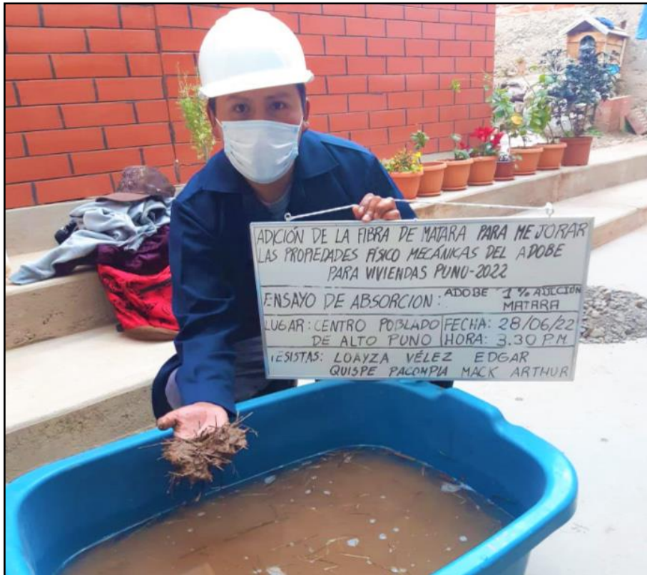
Figura 58. Sumersión de los prototipos de adobe EPA.
