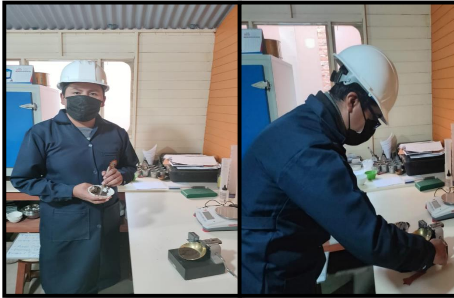
Fotografía: Colocación del material a la cazuela de Casagrande y numero de golpes.
