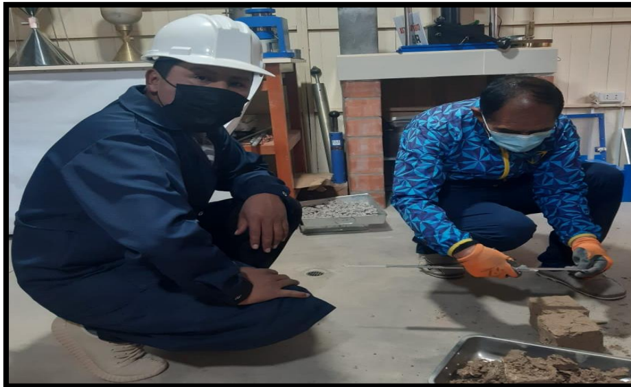
Fotografía: Medicion de los cubos de adobe para la variacion dimensional.
