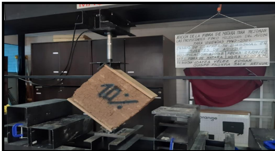
Fotografía: Murete con adición de fibra de Matara al 1.0%.
