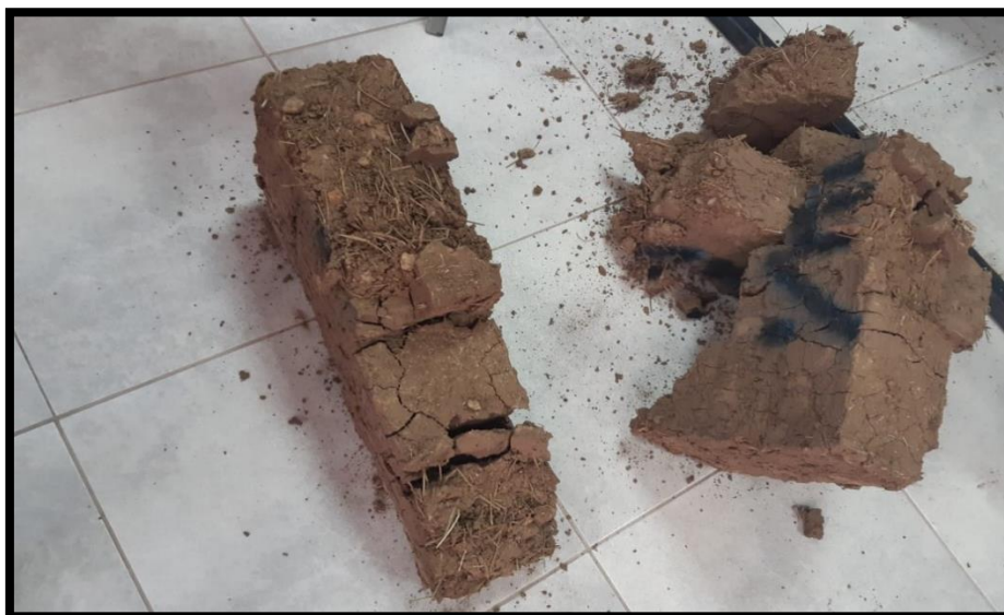
Fotografía: Rotura después de los ensayos a compresión diagonal.
