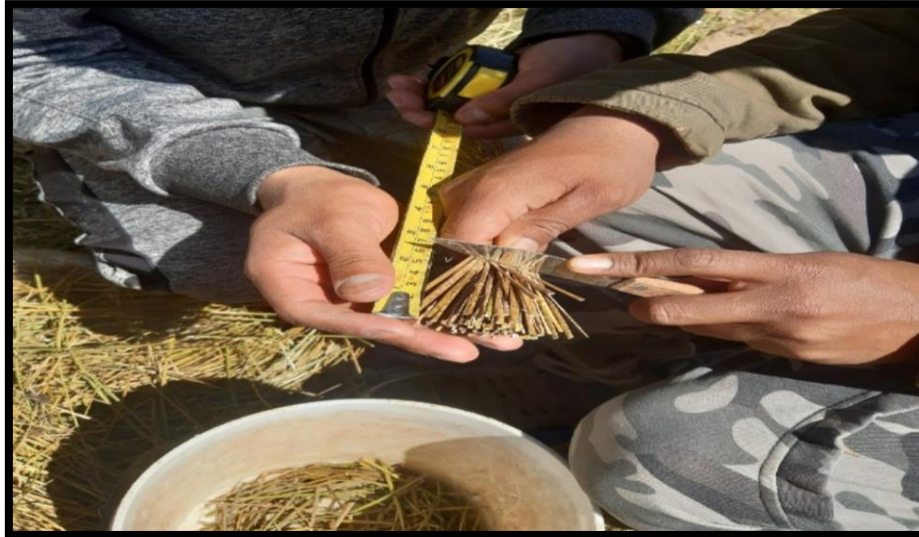
Fotografía: Cortado de la fibra de Matara a 5cm.
