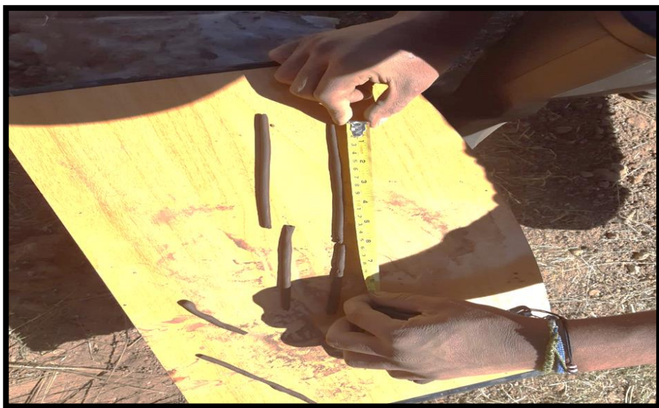
Fotografía: Cinta de barro de 4mm y longitud de 15cm.
