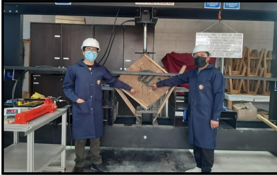
Fotografía: Fisura de murete al 1.0% en compresión diagonal.
