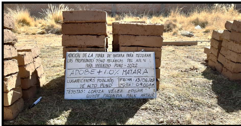
Fotografía: Adobe seco con 1.0% de fibra de matara para ensayo el de flexión.
