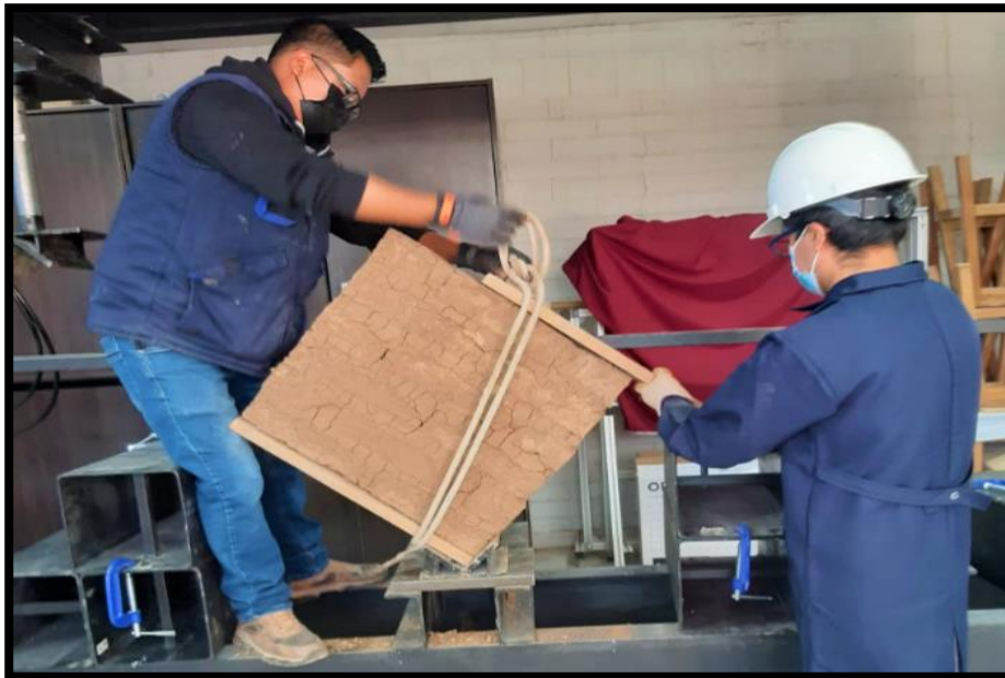
Fotografía: Colocación del murete en forma diagonal
