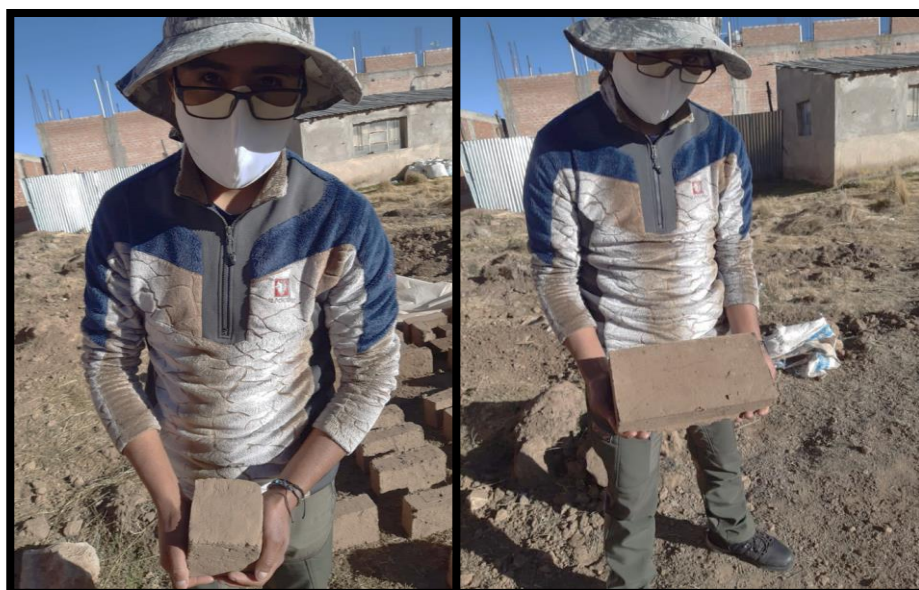
Fotografía: Adobes secos para los ensayos de compresión y flexión.
