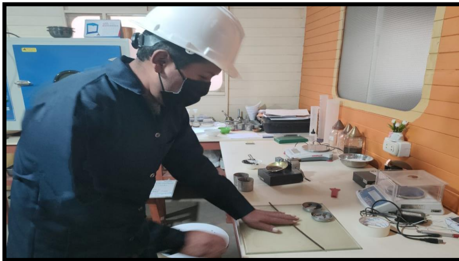
Fotografía: Elaboración del rolado para conseguir cilindros de 3mm de diámetro.
