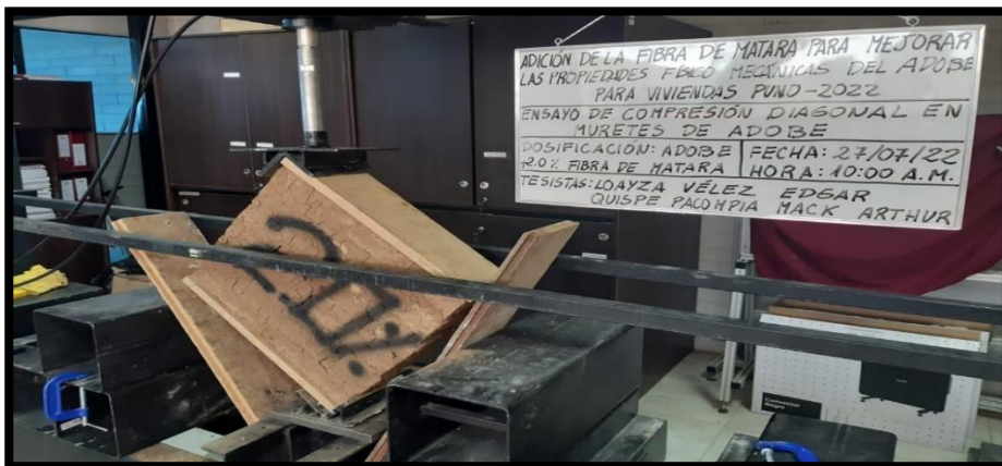
Fotografía: Murete con adición de fibra de Matara al 2.0%.
