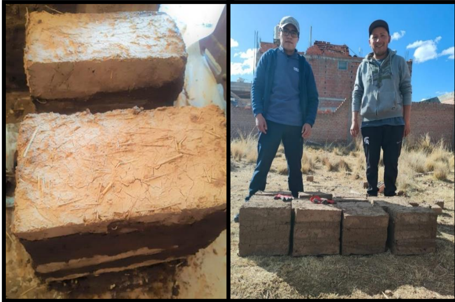
Fotografía: Elaboración de pilas de adobe para el ensayo de compresión axial.
