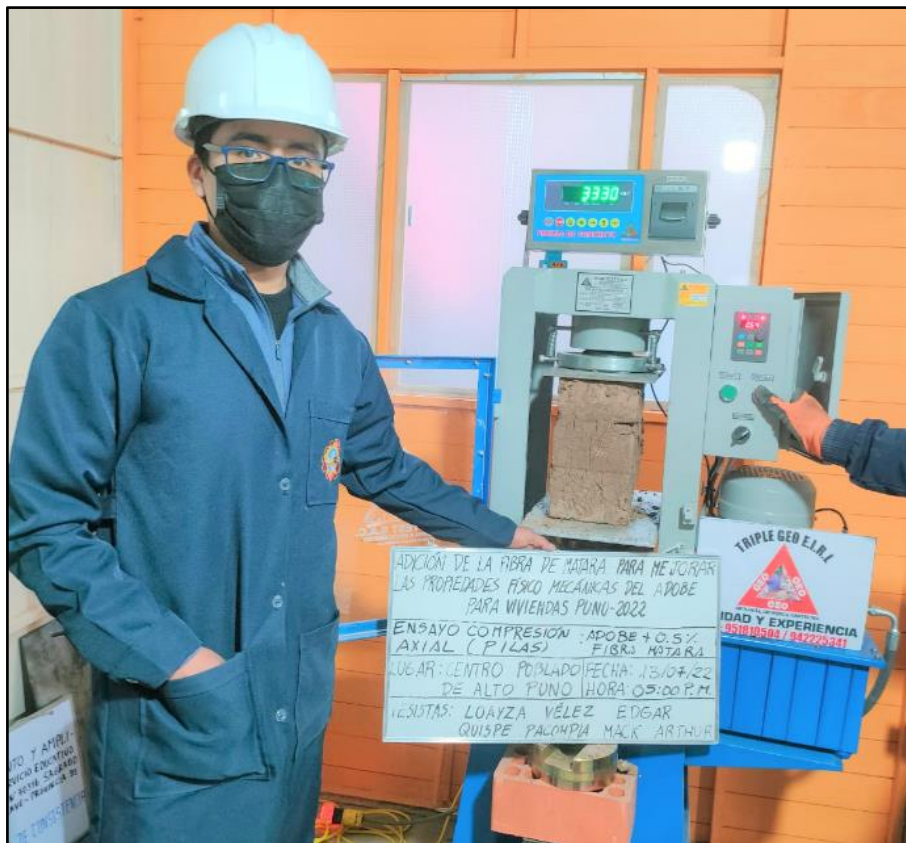
Figura 45. Rotura de las pilas ERCA.
