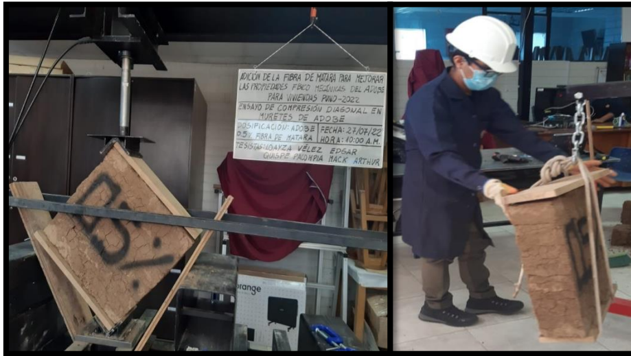
Fotografía: Murete con fibra de Matara al 0.5% para ser sometido a compresión diagonal.
