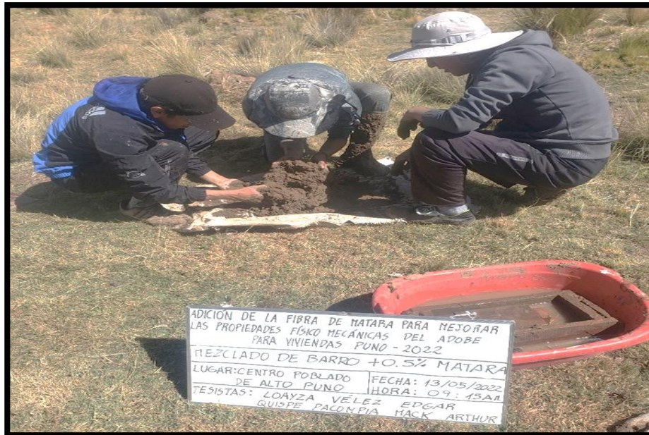
Fotografía: Mezclado del barro y la fibra Matara al 0.5%.
