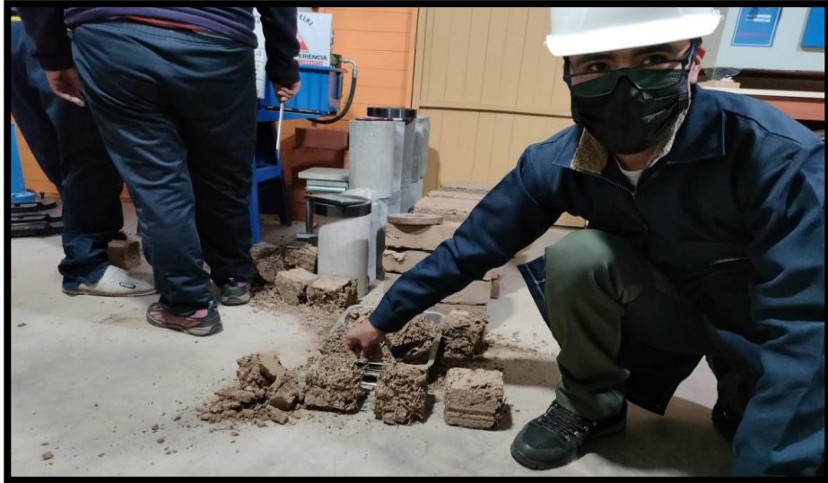
Fotografía: Rotura de los adobes al 0.0%, al 0.5%, 1.0%, 2.0% a compresión.
