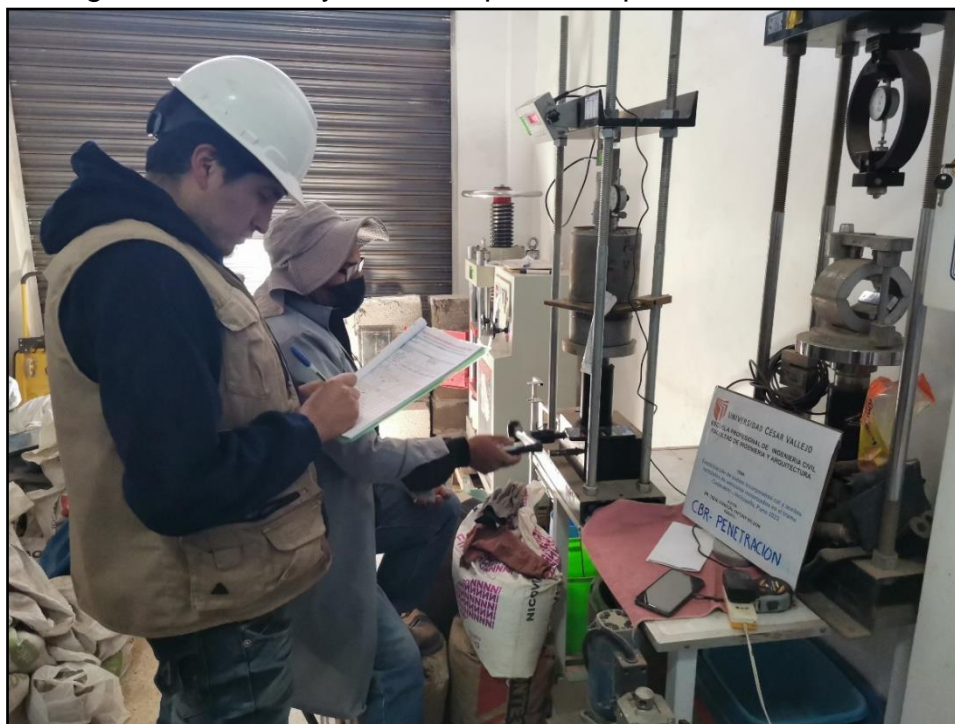
Figura 3.29. Ensayo de CBR pistón de penetración.
