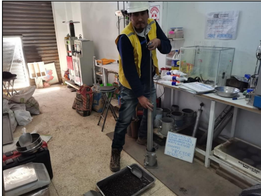
Figura 3.12. Ensayo de proctor modificado método A
