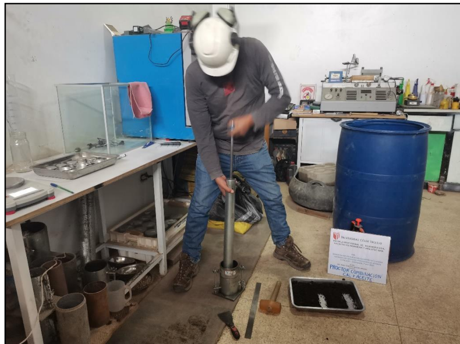
Figura 3.24. Ensayo de proctor modificado muestra con cal y aceite
