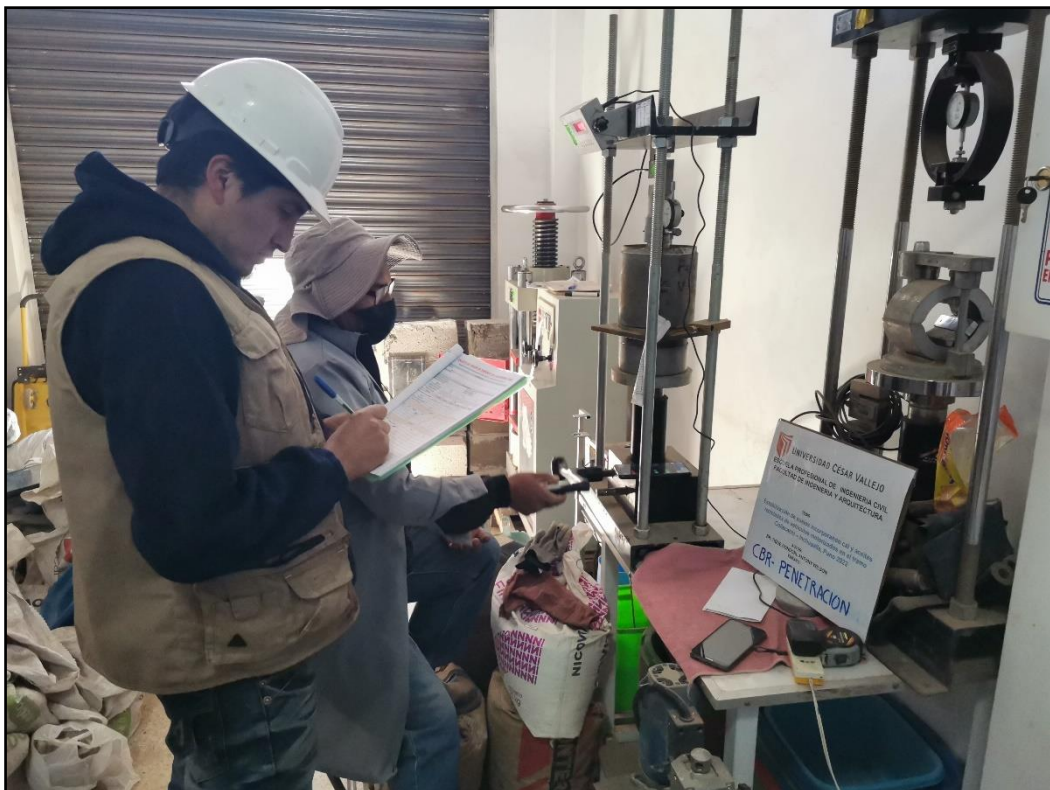
Figura 3.13. Ensayo de CBR pistón de penetración.
