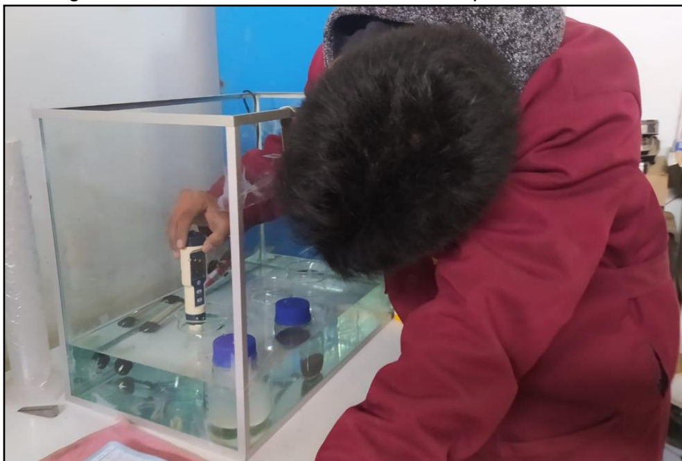
Figura 3.20. Medición del nivel de PH con potenciómetro
