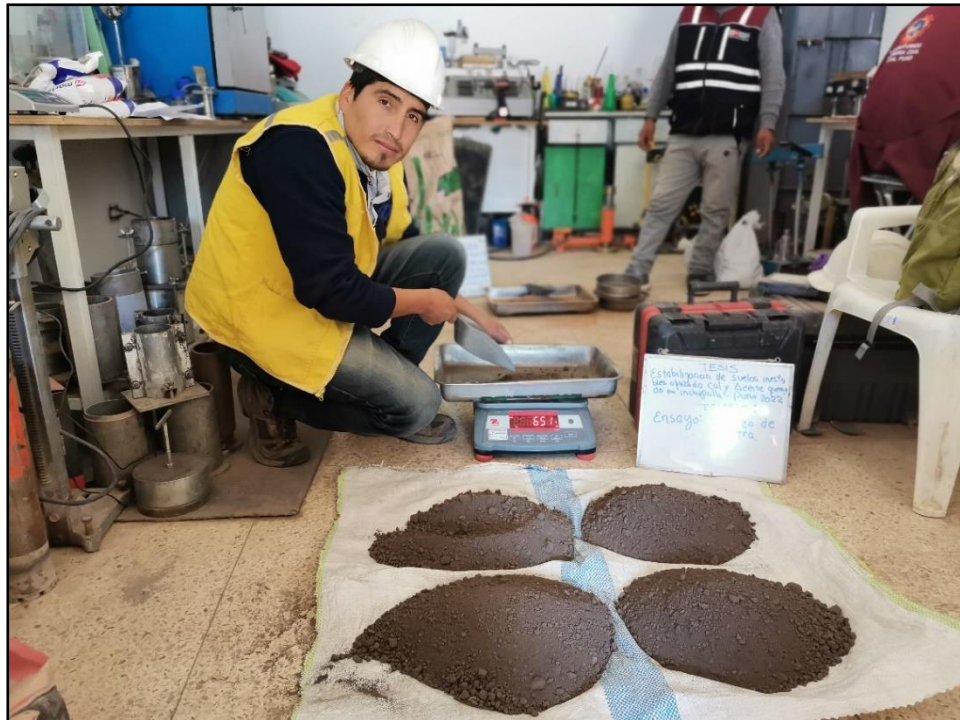
Figura 3.8. Cuarteo de muestra
