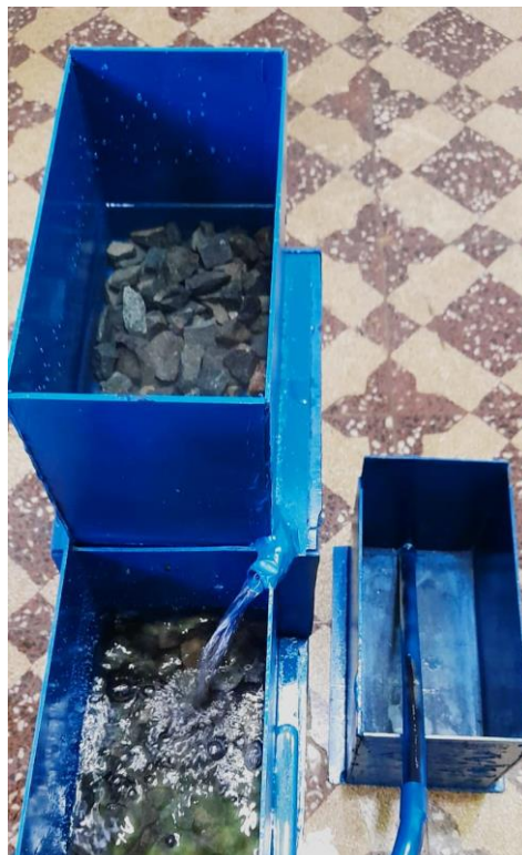
Figura 10. Proceso de filtrado de agua en la segunda cámara de tratamiento.
