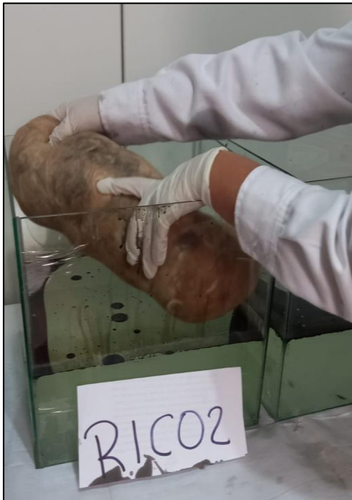
Ilustración 14: Introducción del adsorbente al efluente
