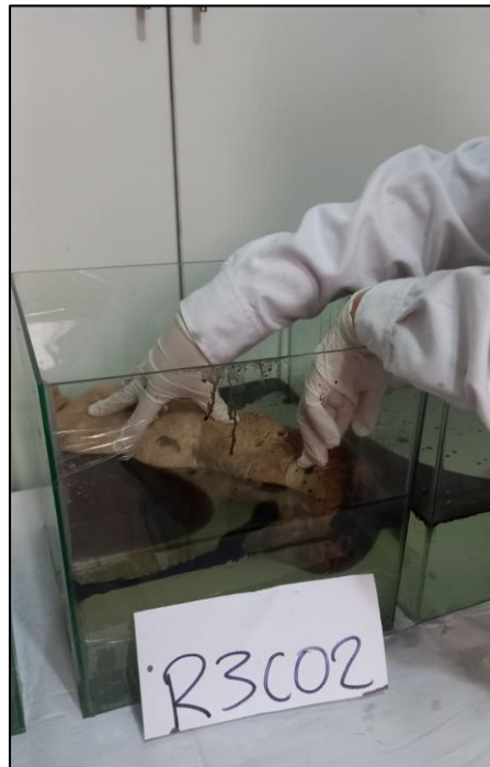
Ilustración 15: Introducción del adsorbente al efluente
