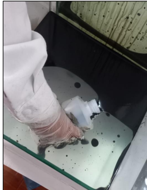
Ilustración 11: Toma de muestra antes de la adsorción
