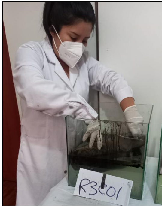
Ilustración 13: Introducción del adsorbente al efluente
