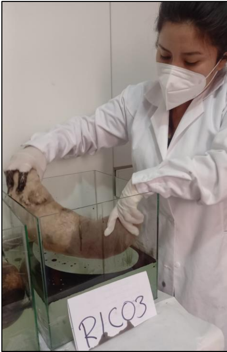
Ilustración 12: Introducción del adsorbente al efluente
