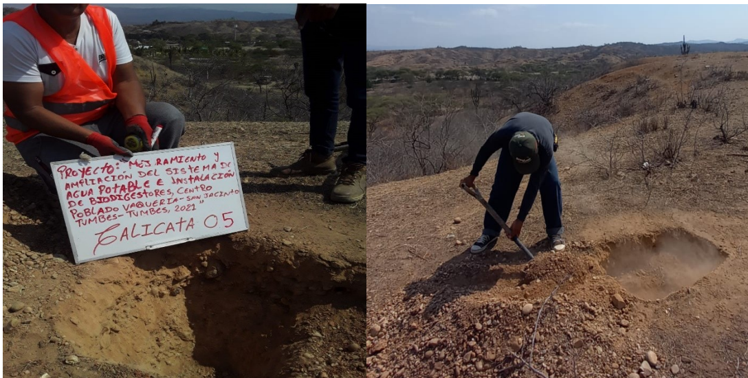
DESCRIPCIÓN: REALIZACIÓN DEL ESTUDIO BASICO DE MECÁNICA DE SUELOS, PROCEDE A REALIZAR LAS CALICATAS.
