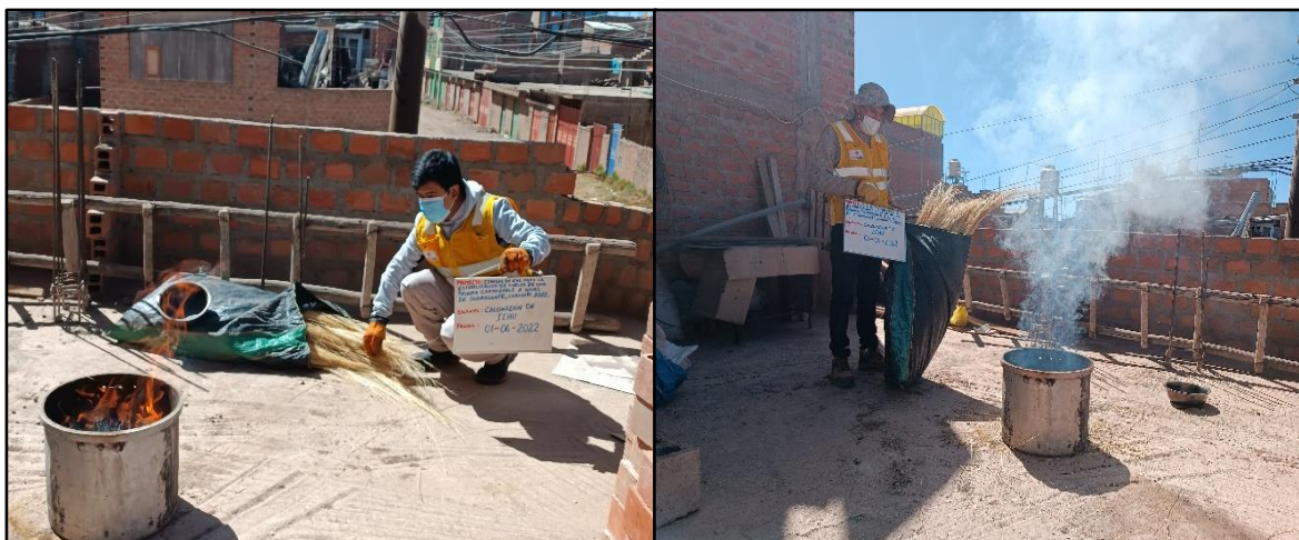
Figura 15. Calcinación de la ceniza de ichu
