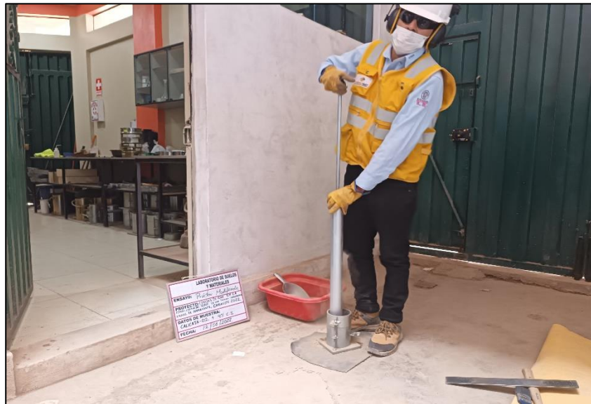
Figura 10. Ensayo Proctor modificado.
