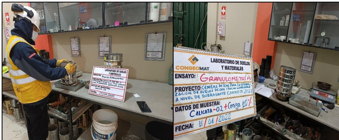
Figura 16. Tamizaje de muestra en el ensayo "Granulometría".
