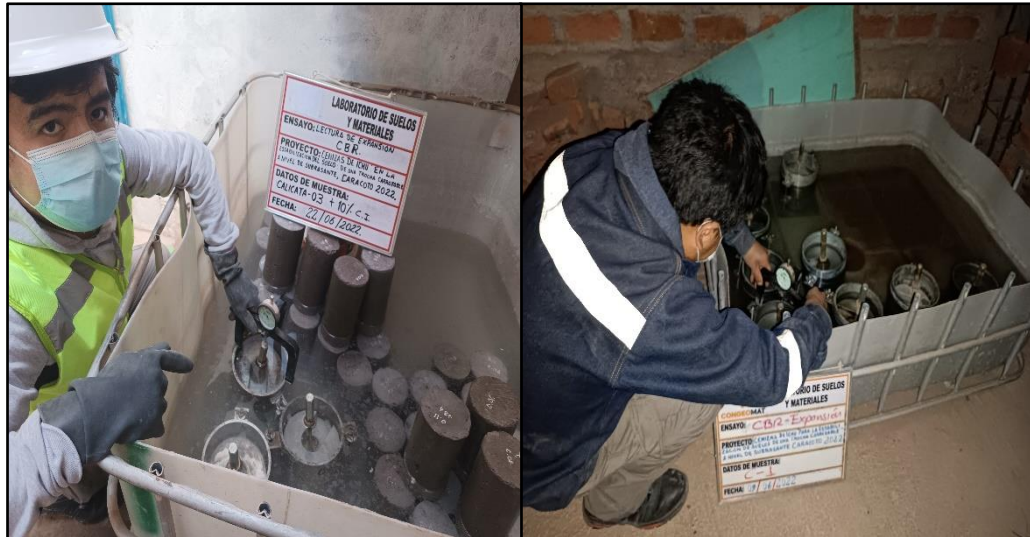
Figura 22. Moldes sumergidos en el ensayo CBR
