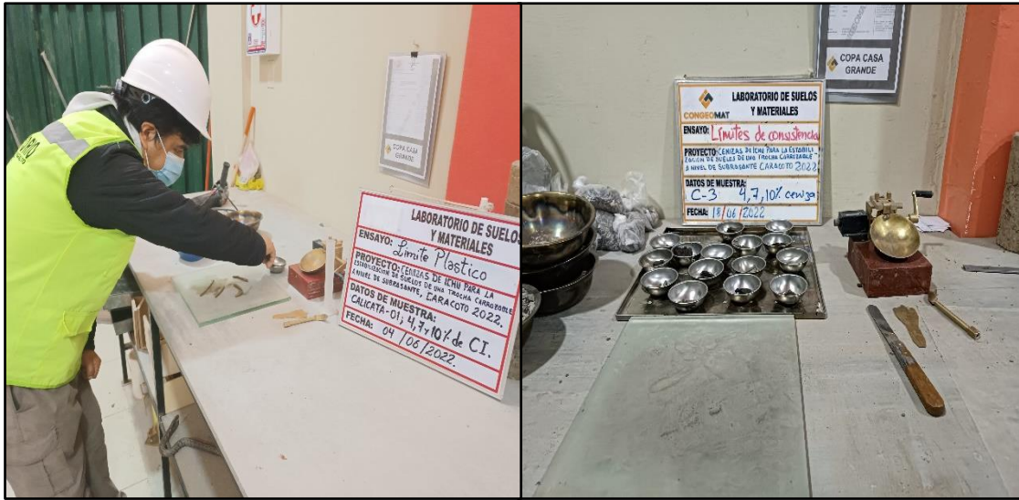
Figura 18. Ensayo de límite plástico.
