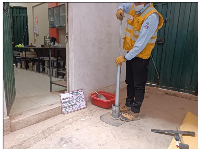
Figura 20. Molde y pisón en el ensayo de Proctor.
