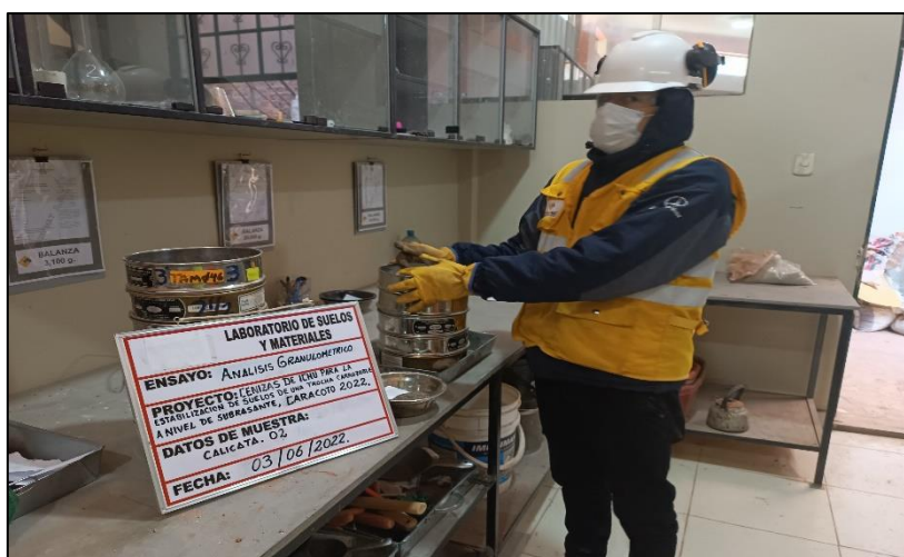
Figura 8. Ensayo de granulometría por tamizado.
