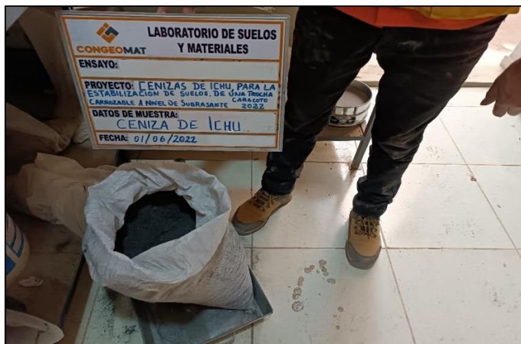
Figura 4. Muestra de cenizas de ichu en laboratorio.
