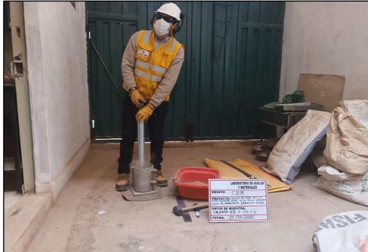
Figura 11. Molde de CBR para compactación.
