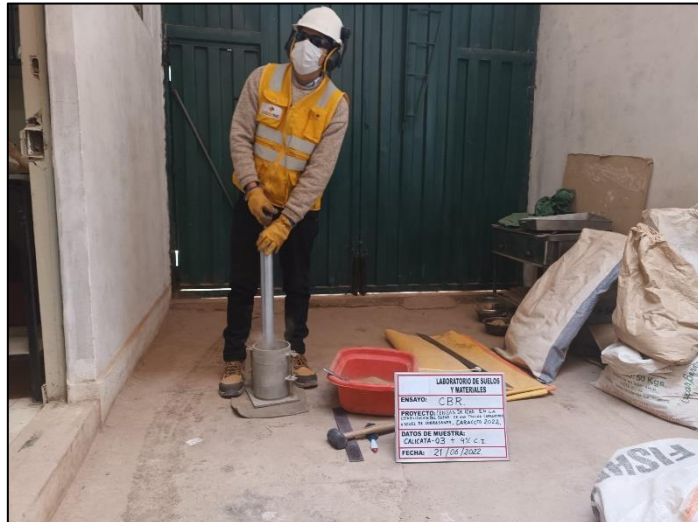
Figura 21. Molde y pisón en el ensayo de CBR
