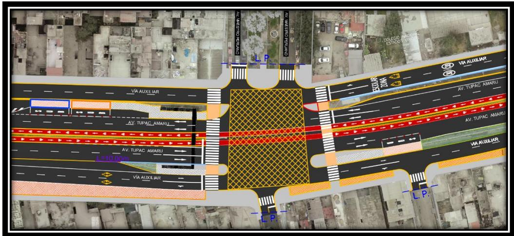
**Figura 40.** Propuesta de diseño geométrico, intersección Av. El Maestro Peruano, mostrando ubicación y mejora de paraderos.
