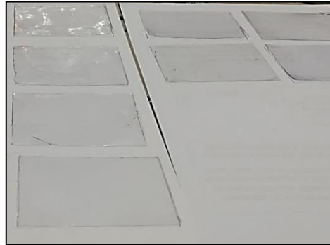
Figura 7. Micas de 5.5 \times 10^{-4} \times 8.5 \times 10^{-4} m y 1 \times 10^{-3} m de espesor
