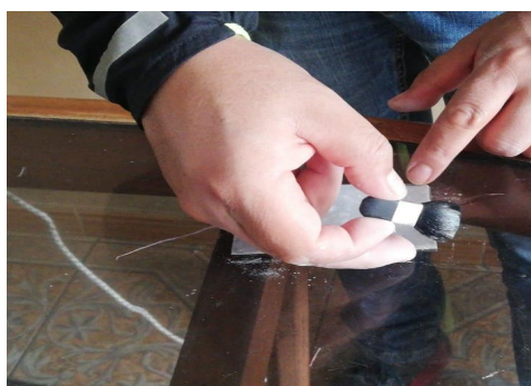
Figura 21. Se aplicó de la mezcla de KI con agua ionizada sobre las micas emparejadas
