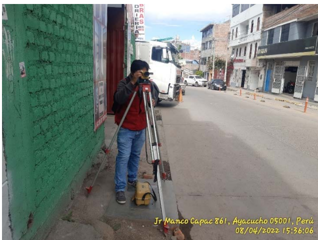
Figura 5. Levantamiento topográfico con nivel de ingeniero. Fuente: elaboración propia.
