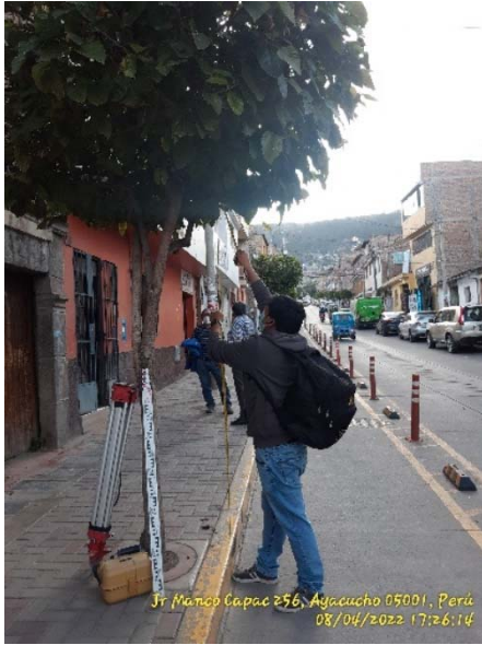
Figura 11. Medida de la altura libre. Fuente: elaboración propia.
