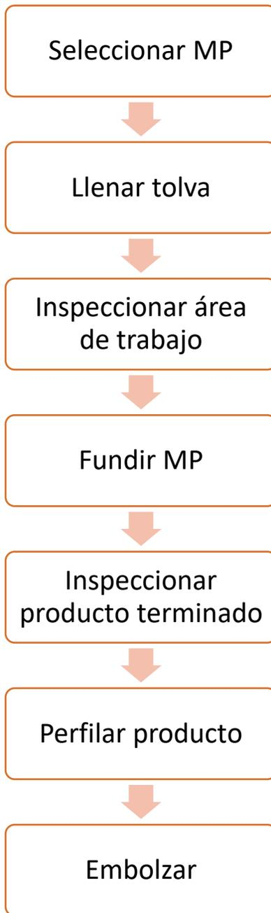
Figura 2. Diagrama de bloques del proceso de fabricación de productos plásticos en general
