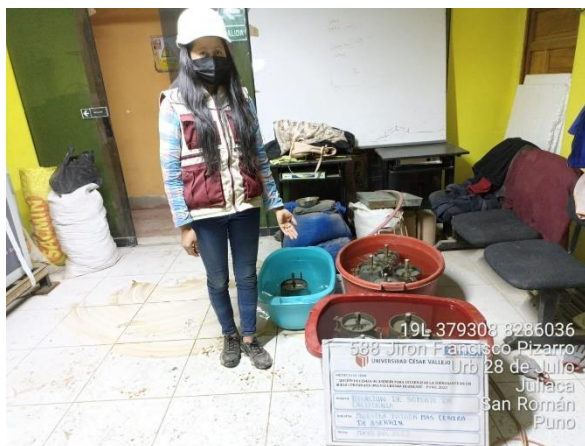
Figura 12. Ensayo de CBR
