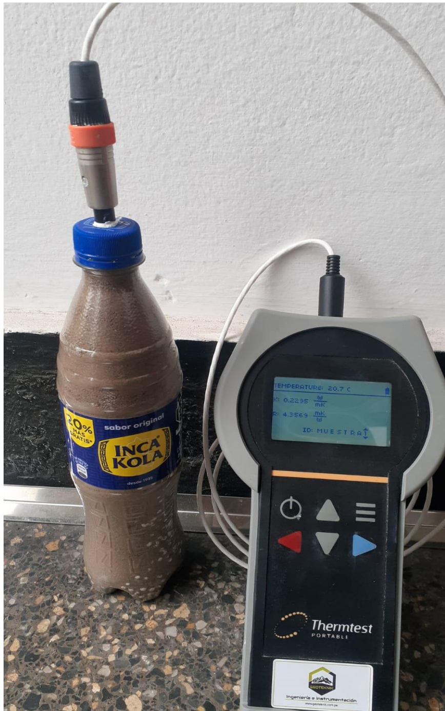
Figura 37. Medición de conductividad térmica, unidad de albañilería
