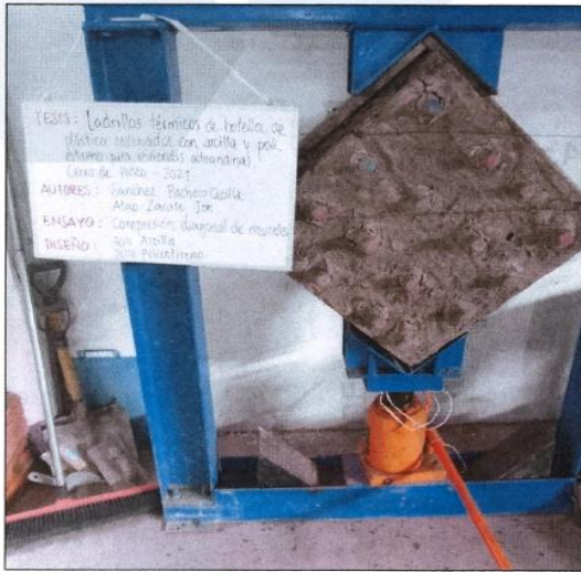
MURO CON 70% ARCILLA - 30% POLIESTIRENO.
