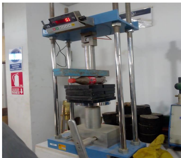
Figura 34. Ensayos a compresión por unidad de albañilería.
