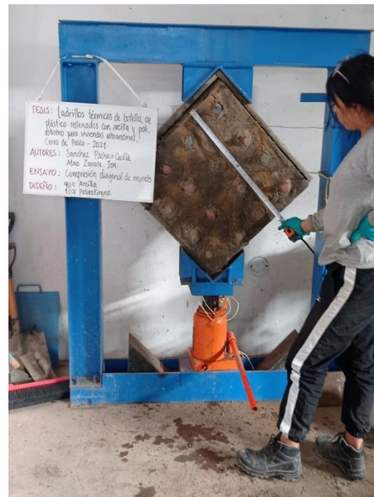
Figura 21. Prueba a compresión en muretes
