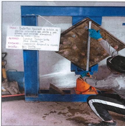
MURO CON 90% ARCILLA - 10% POLIESTIRENO.
