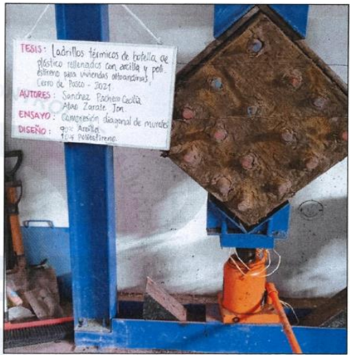
MURO CON 90% ARCILLA - 10% POLIESTIRENO.
