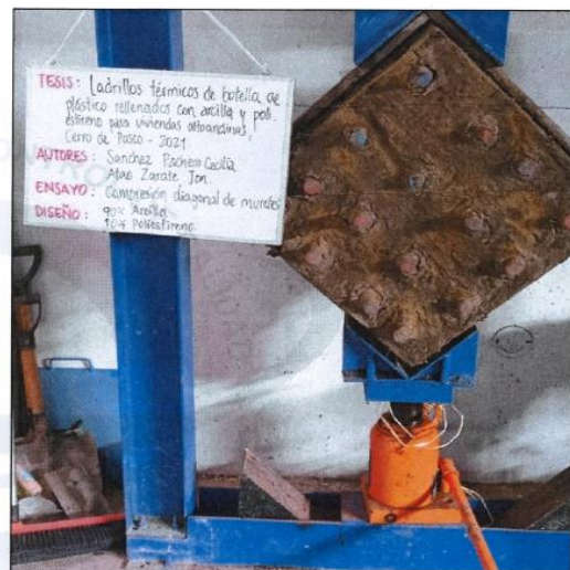
MURO CON 90% ARCILLA - 10% POLIESTIRENO.
