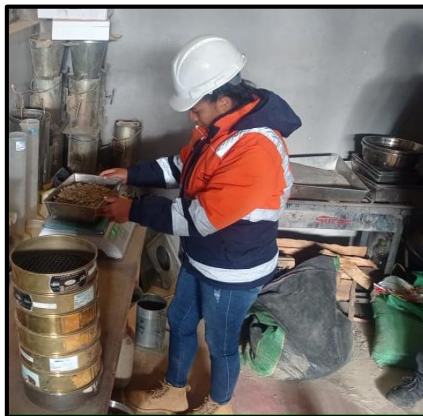
Figura 6. Material pesado para efectuar el ensayo de granulometría
