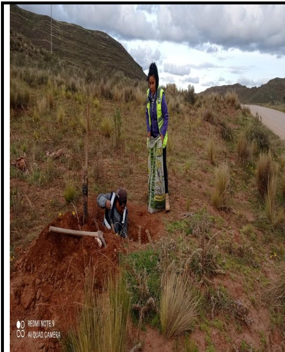
Figura 05. Extracción de material de la calicata 2
