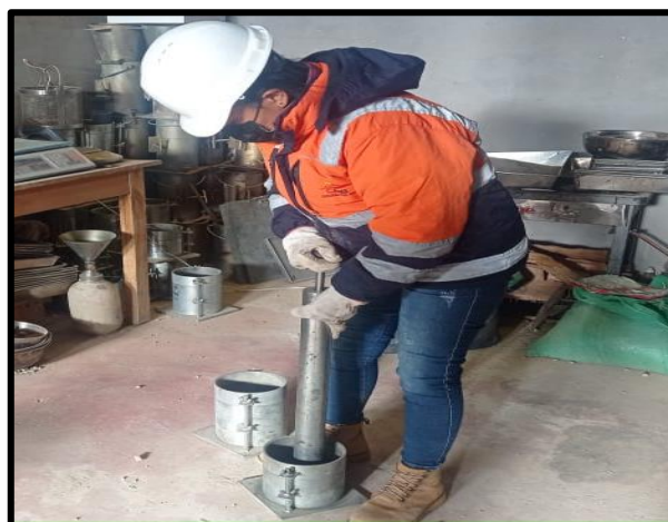
Figura 10. Ensayo de Proctor modificado
