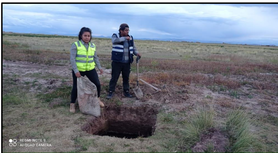
Figura 4. Apertura de la calicata I
