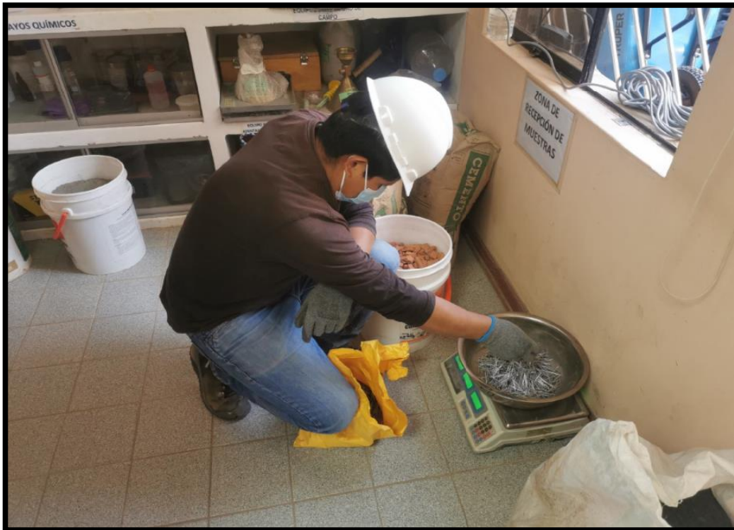
Imagen N° 11: Pesado de las fibras cortas de Acero para la elaboración del Concreto con sustitución del 25% del Agregado grueso .
