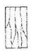
Tipo 3 Fisuras verticales en el extremo, a través de ambos extremos, como no bien formadas
