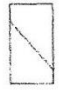
Tipo 4 Fractura diagonal con fibras a través de los extremos, por lo que se muestra con un patrón para distorsión del Tipo 1.
