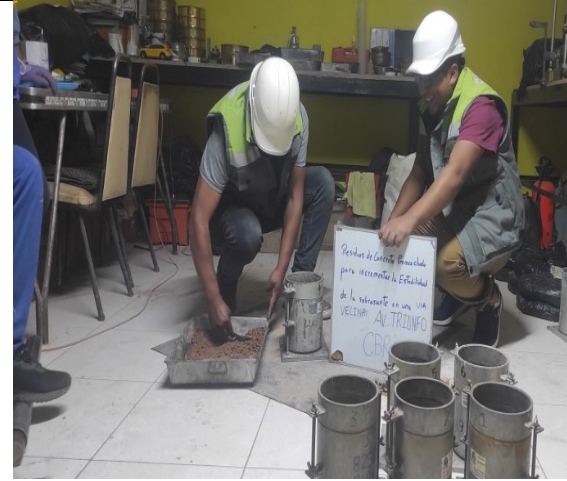
Fotografía 19. Ensayo de Proctor modificado
