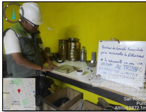
Figura 12. Ensayo de límite plástico.
