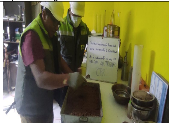
Fotografía 18. Ensayo de Proctor modificado
