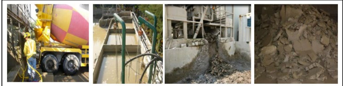
Figura 4. Generación de residuos de concreto premezclado en una planta de concreto Fuente. Xuan et al. (2016, p. 4)
