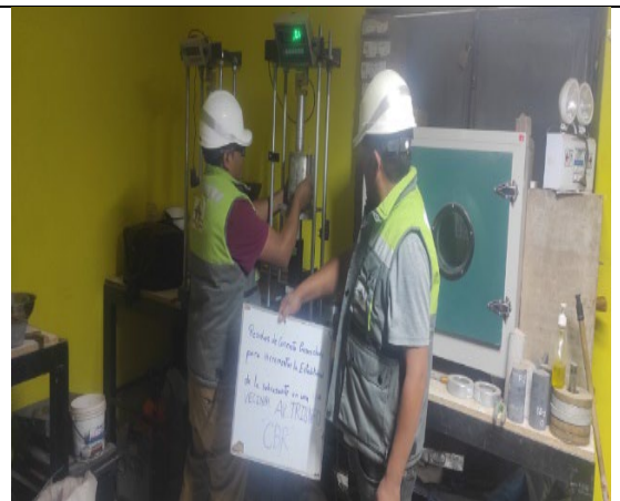
Fotografía 22. Ensayo de CBR
