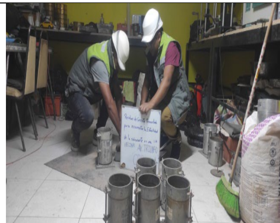
Fotografía 21. Ensayo de CBR
