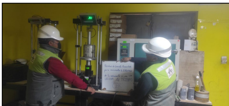
Figura 14. Ensayo de CBR
