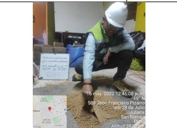
Fotografía 12. Cuarteo de la muestra extraída de las calicatas realizadas
