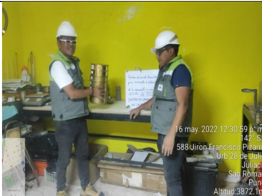
Fotografía 15. Procedimiento de tamizado para materiales finos
