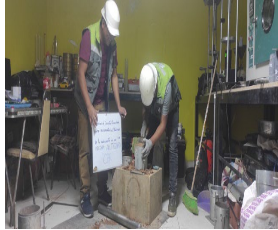
Fotografía 20. Ensayo de Proctor modificado
