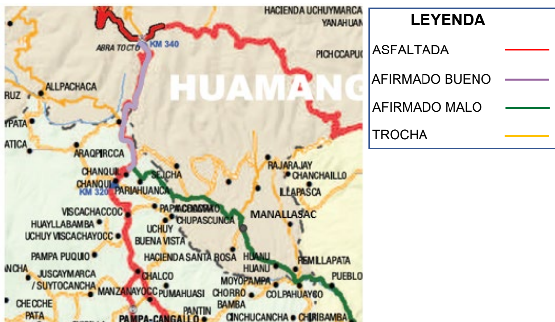
Figura 43: Estado actual de las Carreteras en Manallasac
