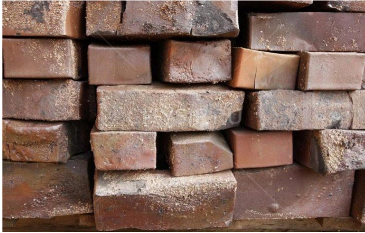
Figura 3: Se observa las muestras del ladrillo artesanal (rococho) y sus características deformaciones y textura.
