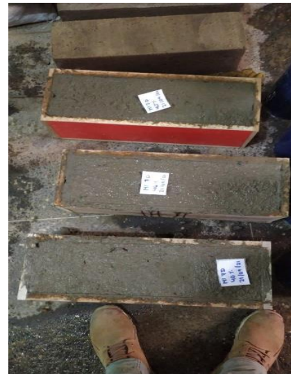
Foto 22. Moldes prismáticos llenos.
