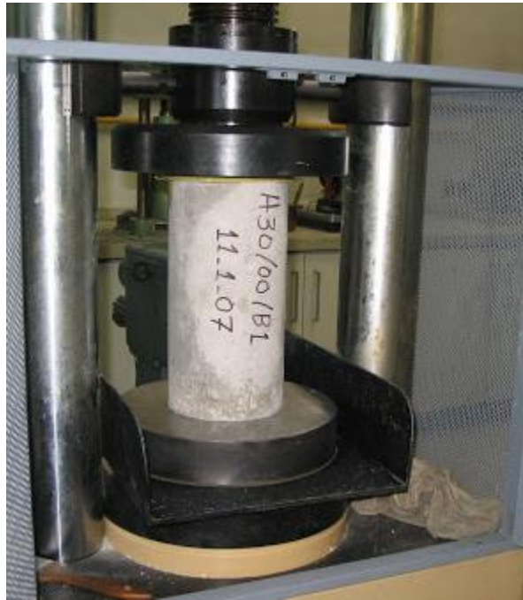
Figura 12: Se visualiza un ensayo de compresión de una muestra cilíndrica de concreto hasta que ocurra la falla.
