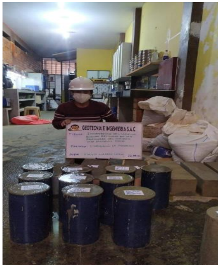
Foto 21. Muestras llenas de concreto.
