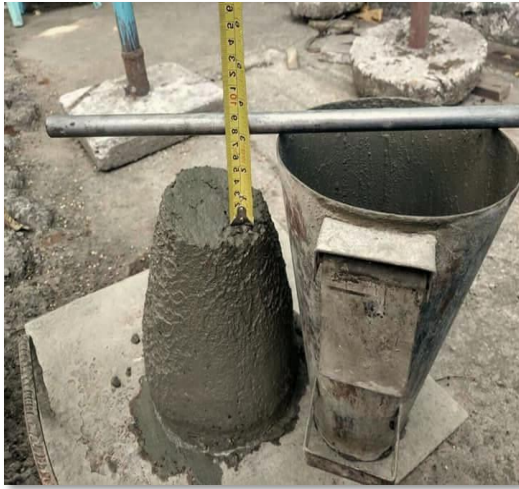
Figura 22: ensayo de revenimiento de la muestra patrón con agregados naturales de la cantera Excalibur sac.
