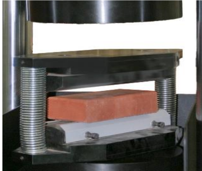
Figura 8: Otra de las propiedades del ladrillo rococho es la resistencia a la compresión que no debe ser menor a 50 kg/cm 2 según la norma E070.
