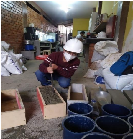
Foto 19. Varillado de la mezcla.
