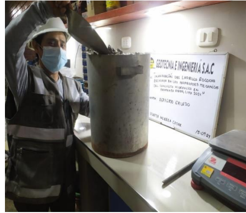
Foto 12. Peso unitario de agregado grueso.
