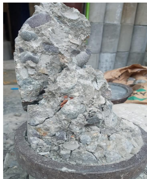
Figura 26: vista de la probeta ya ensayada y el tipo de rotura.
