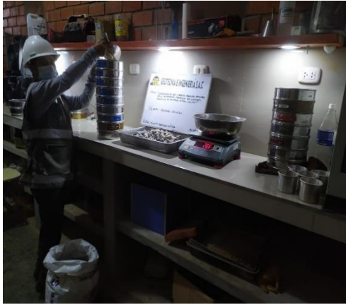
Foto 11. Granulometría de agregado grueso.
