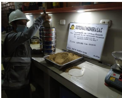
Foto 9. Granulometría de agregado fino.
