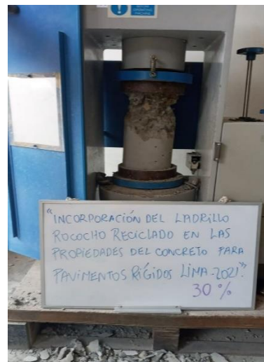
Foto 26. Ensayo a compresión 30% ladrillo rococho.
