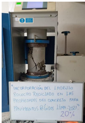
Foto 25. Ensayo a compresión 20% ladrillo rococho.
