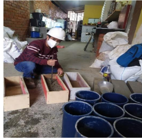
Foto 18. Llenado de moldes prismáticos.
