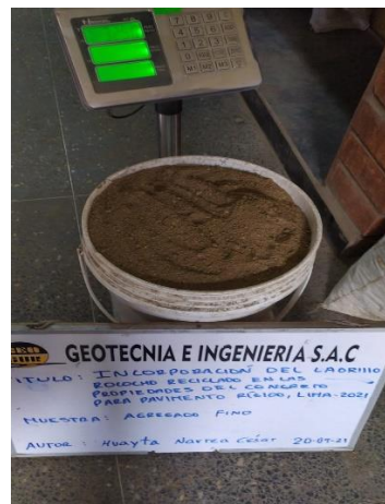
Foto 16. Pesaje de agregado fino.
