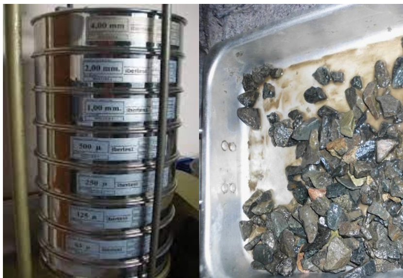
Figura 10: Hacia la izquierda se tiene los tamices donde se realizará la granulometría del material designado, y hacia la derecha el ensayo de densidad y absorción del agregado grueso.
