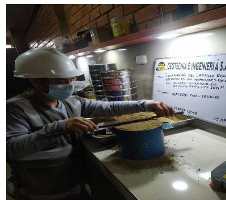
Foto 10. Peso unitario de agregado fino.
