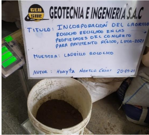
Foto 17. Pesaje de ladrillo rococho.
