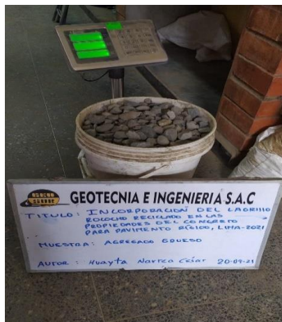
Foto 15. Pesaje de agregado grueso.
