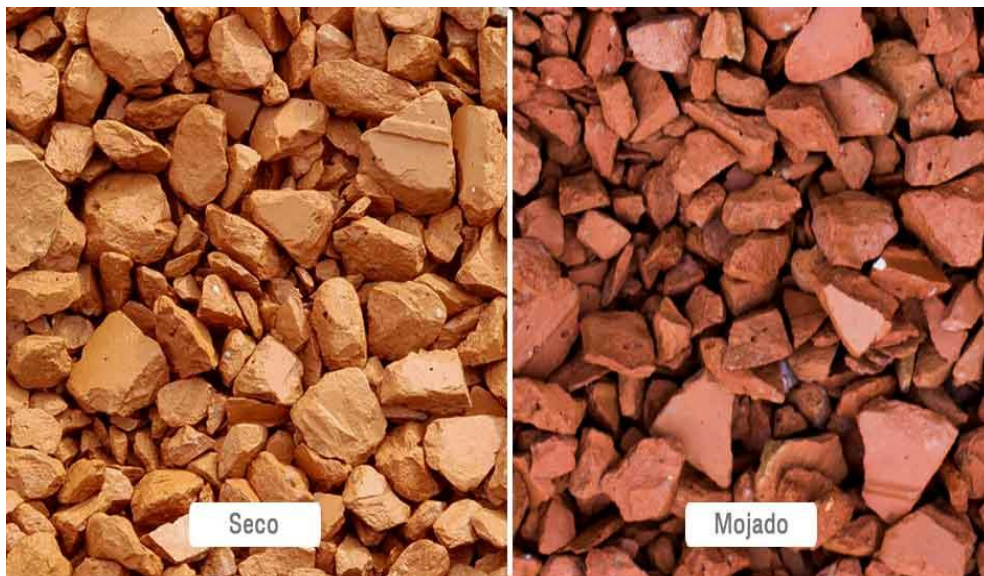
Figura 5: Ladrillo reciclado triturado en estado seco y húmedo que se incorporara al nuevo concreto.
