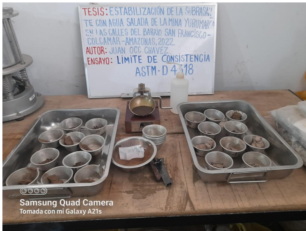
Fotografía 9. Ensayos de límites de Atterberg a las muestras tomadas en las calles del barrio San Francisco
