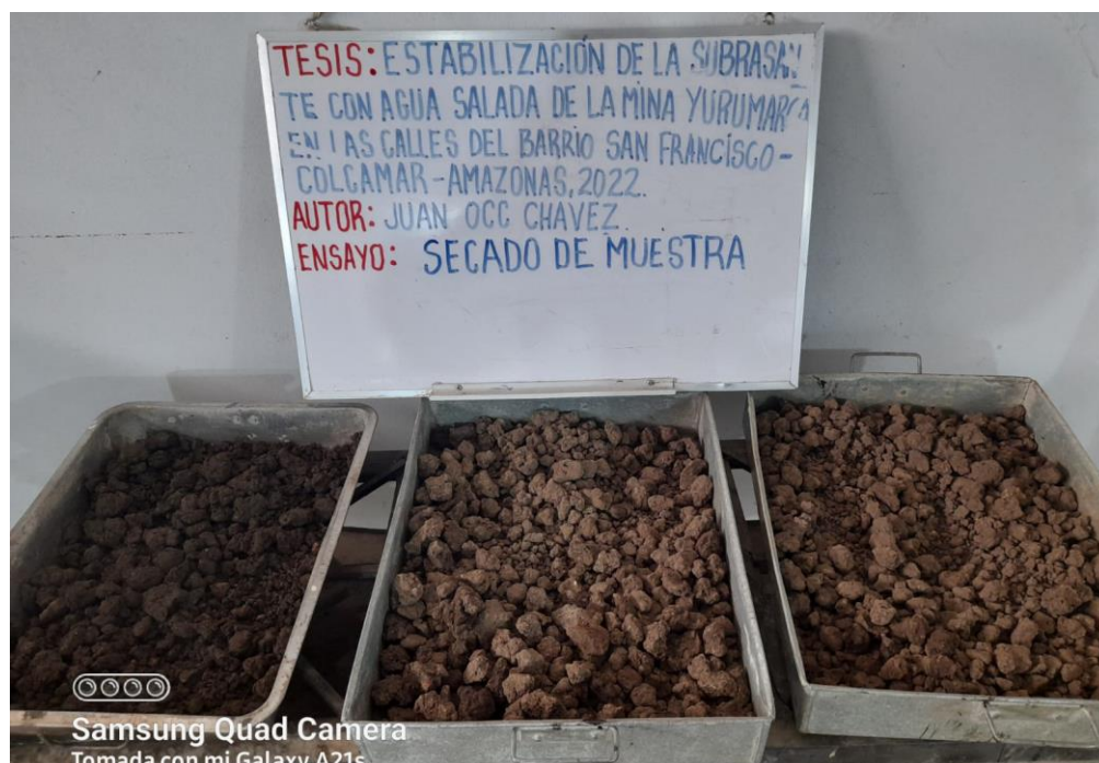
Fotografía 10. Secado de muestras para determinar el contenido de humedad de natural de las muestras tomadas en las calles del barrio San Francisco
