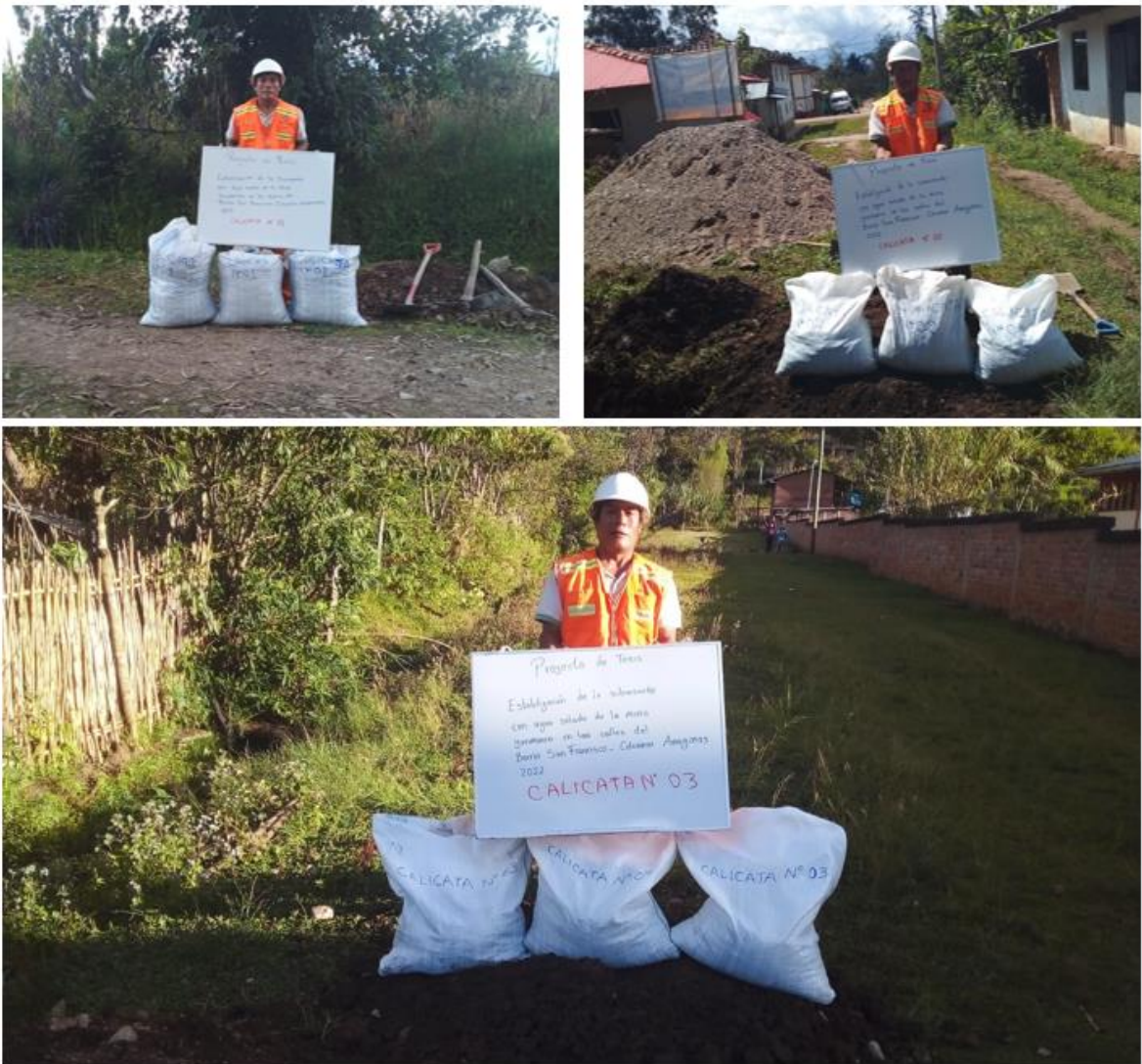
Fotografía 8. Muestras de suelos, tomadas en las calles del barrio de San Francisco de Colcamar
