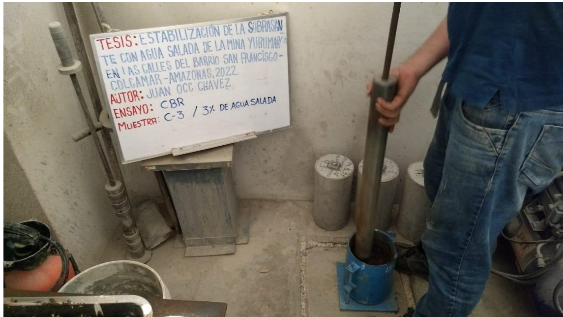
Fotografía 11. Ensayos de compactación para determinar la máxima densidad seca y el óptimo contenido de humedad, mediante el ensayo del Proctor modificado
