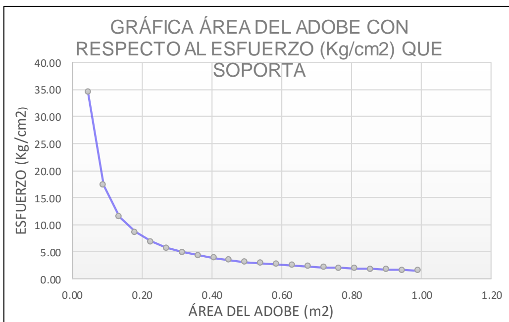
Figura 17. Gráfico del área del adobe con respecto al esfuerzo que soporta. Fuente. propia.
