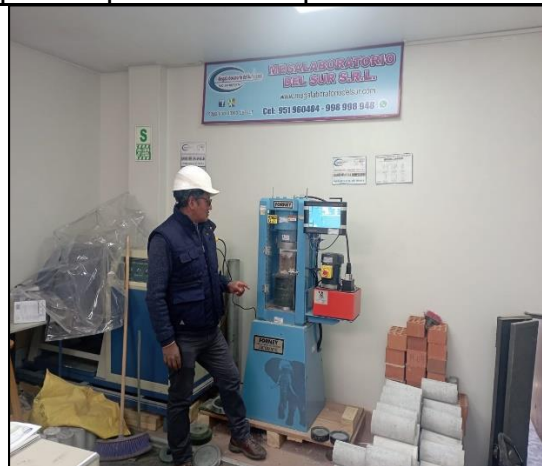
Fotografía 11. Muestra sometida a la prueba de compresión.
