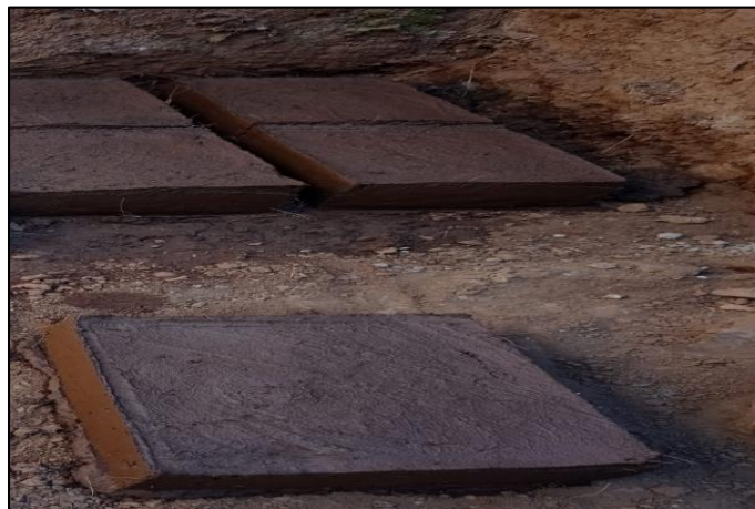
Figura 10. Adobes fabricados para la prueba de compresión. Fuente. propia.
