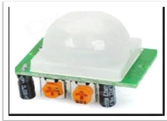
*Figura 11: Sensor de movimiento PIR*
