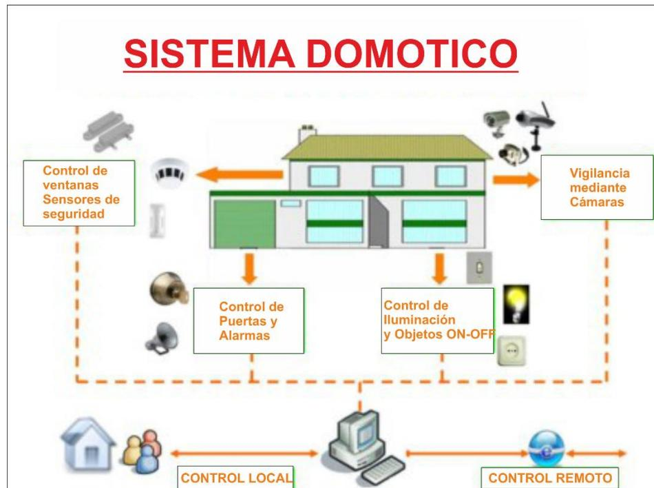
Figura 6: Esquema de Sistema Inteligente
