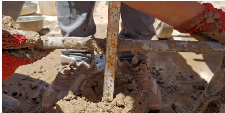
Fotografía 12 Determinación del revenimiento.
