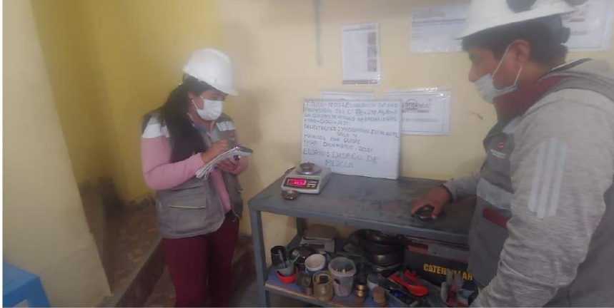
Fotografía 14 Determinación del contenido de humedad. (FUENTE: INGEOMAT).
