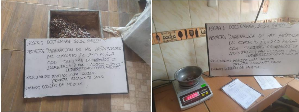
Fotografía 8 Y Fotografía 9 Análisis granulométrico y pesado de muestras para determinar la el contenido de humedad. (FUENTE: INGEOMAT.)
