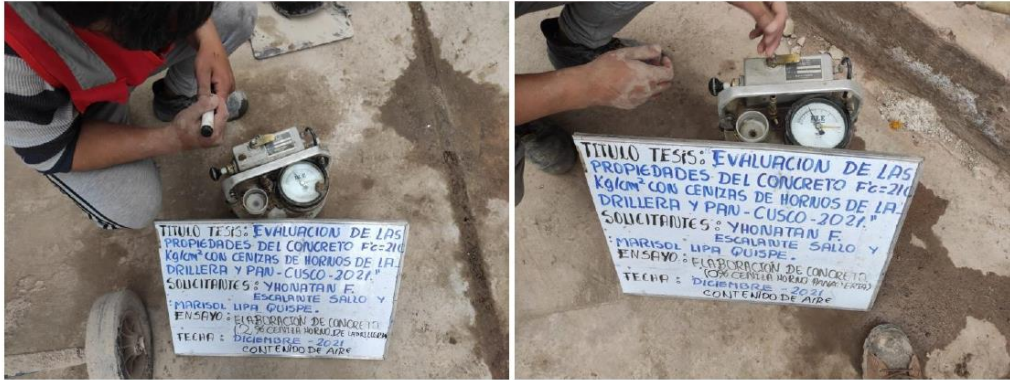
Fotografía 5 y Fotografía 6 IZQUIERDA: Calibración del equipo, DERECHA: Determinación del contenido de aire
