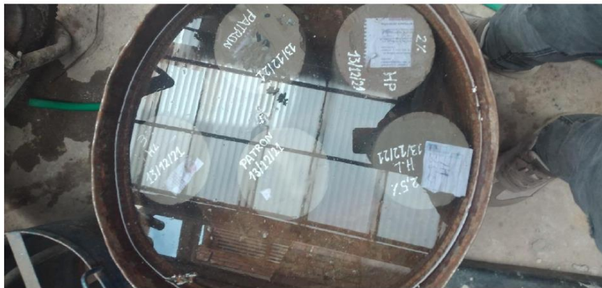
Fotografía 20 y Fotografía 21 Sumergido de los especímenes cilíndricos de concreto en agua potable a temperatura ambiente.
