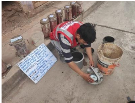
Figura 18: Contenido de aire – lectura en % - Olla de Washington
