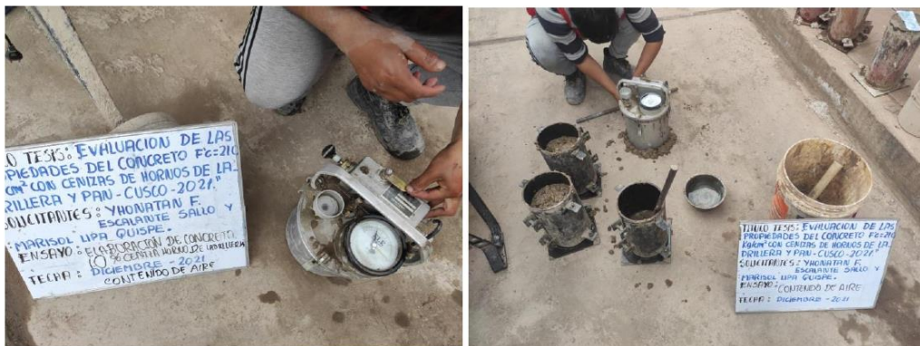
Fotografía 3 y Fotografía 4 Determinación del contenido de aire del concreto.
