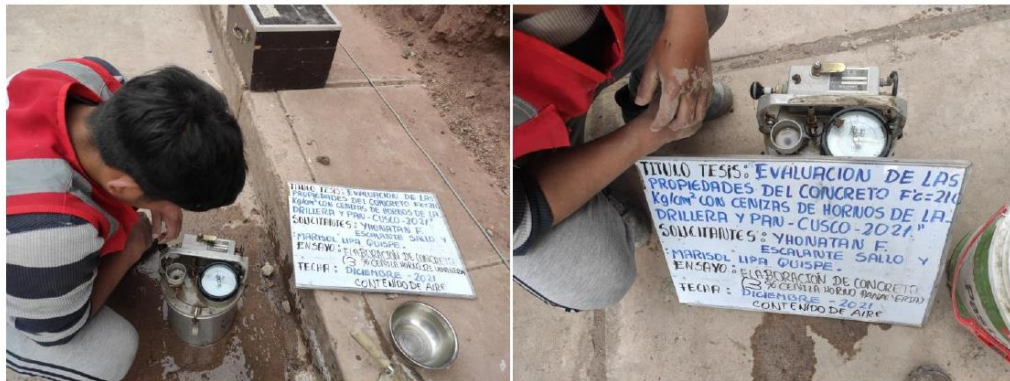
Fotografía 7 y Fotografía 8 Determinación del contenido de aire del concreto.
