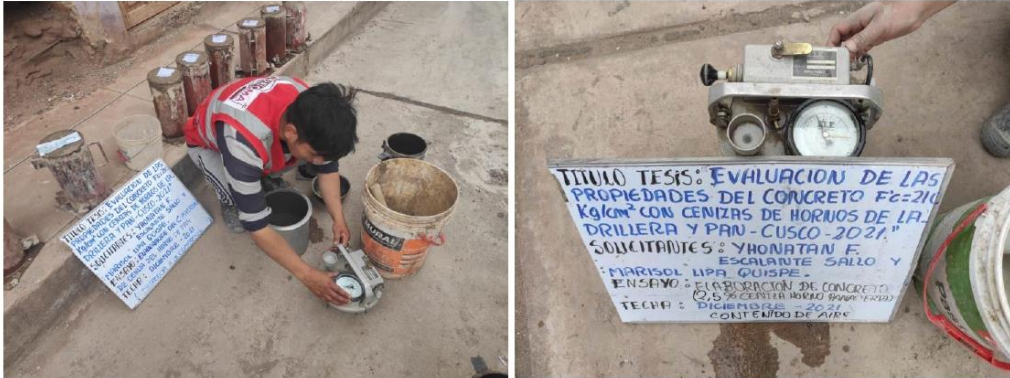
Fotografía 1 y Fotografía 2 Determinación del contenido de aire del concreto.
