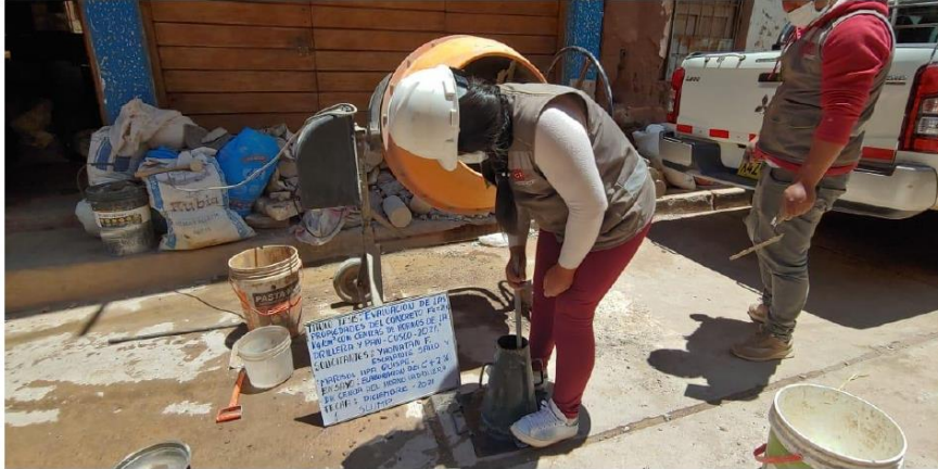
Fotografía 3 Determinación del SLUMP, concreto + Ceniza de horno de ladrillera.
