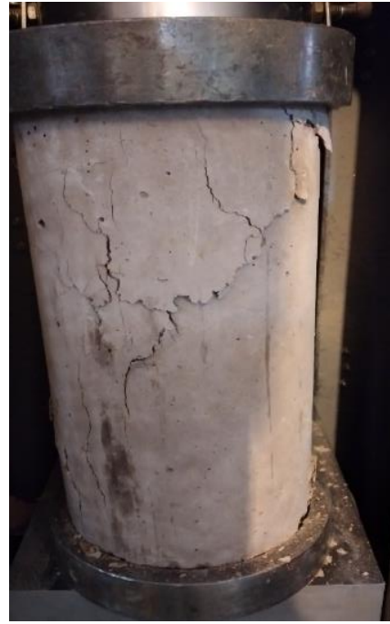
Figura 20: Ensayo de f'_c
