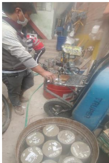
Figura 19: Curado de especímenes
