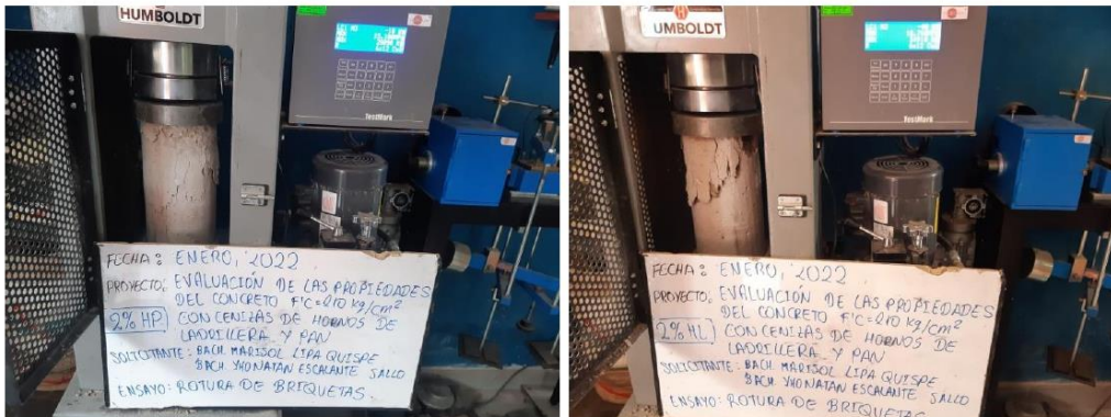
Fotografía 3 Y Fotografía 4 Compresión uniaxial de unidades de concreto 2% Horno de ladrillera “HL” y 2% Horno de pan “HP”
