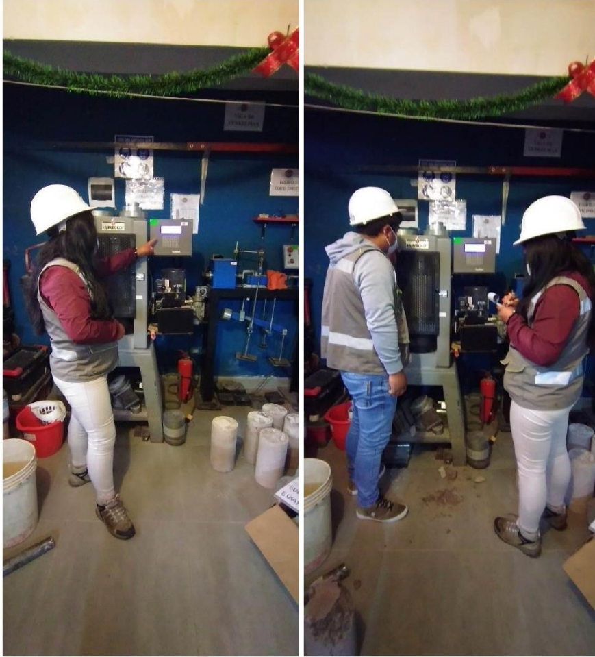
Fotografía 8 Y Fotografía 9 Compresión uniaxial de especímenes de concreto.
