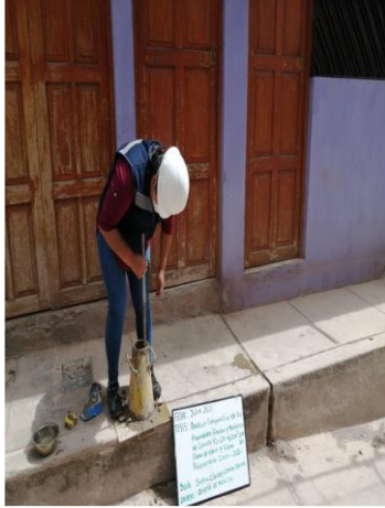
Figura 1: Ensayo de consistencia
