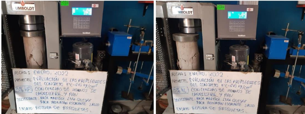
Fotografía 1 Y Fotografía 2 Compresión uniaxial de unidades de concreto 3% Horno de ladrillera “HL” y 3% Horno de pan “HP”
