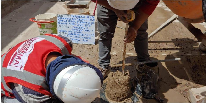
Fotografía 9 Determinación del SLUMP.
