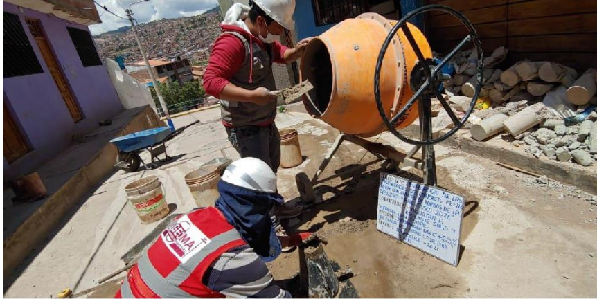
Fotografía 11 Colocación de la primera capa para el ensayo de slump.
