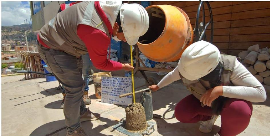
Fotografía 2 Determinación del SLUMP, concreto + Ceniza de horno de pan.
