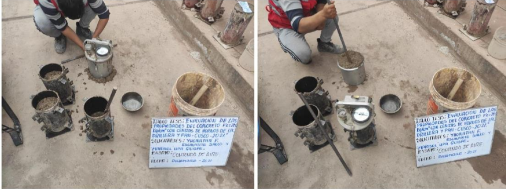
Fotografía 9 y Fotografía 10 Determinación del contenido de aire del concreto.
