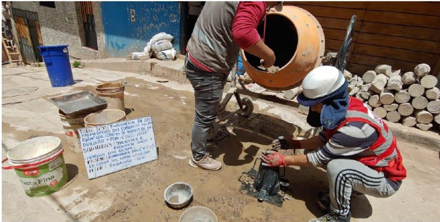
Fotografía 6 Preparación del equipo para realizar el ensayo de slump.
