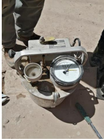
Figura 2: Ensayo de contenido de aire
