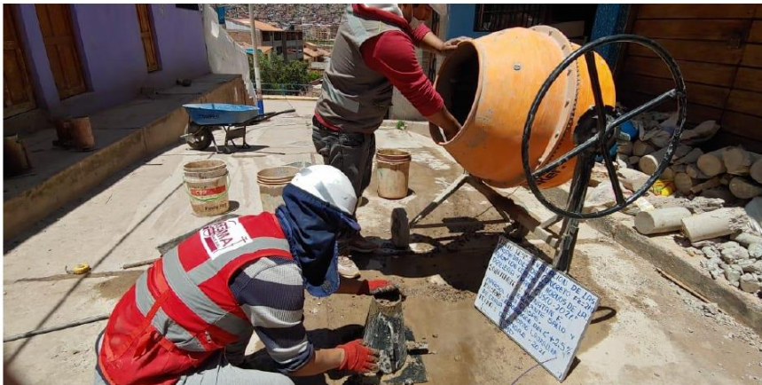
Fotografía 8 Preparación del equipo para realizar el ensayo de slump.
