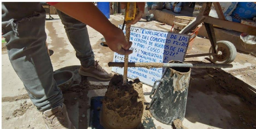
Fotografía 10 Determinación del revenimiento.
