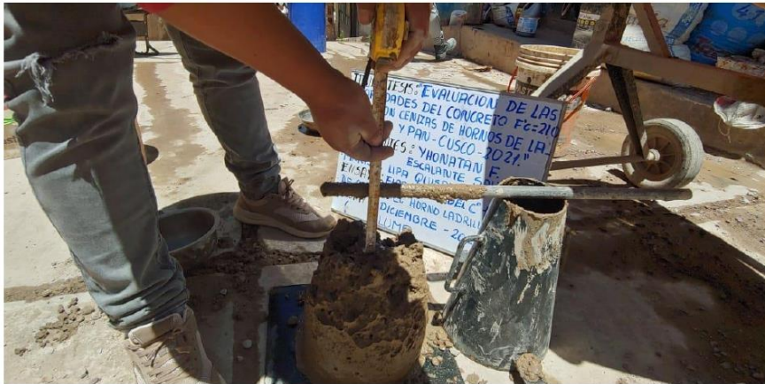
Fotografía 4 Determinación del SLUMP.
