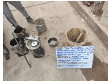
Figura 18: Contenido de aire – lectura en % - Olla de Washington
