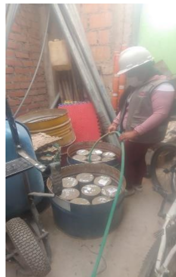
Figura 19: Curado de especímenes
