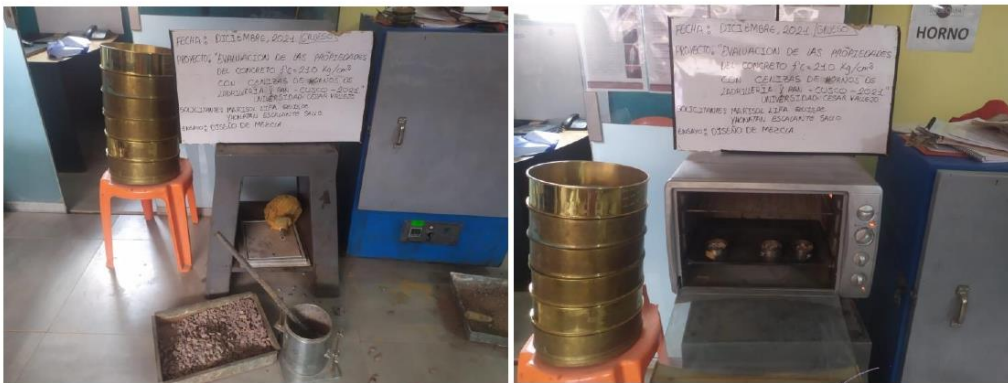
Fotografía 10 Y Fotografía 11: IZQUIERDA: Determinación del peso unitario suelto, DERECHA: Colocación al horno de las muestras para posterior análisis granulométrico, peso específico, absorción. (FUENTE: INGEOMAT.)
