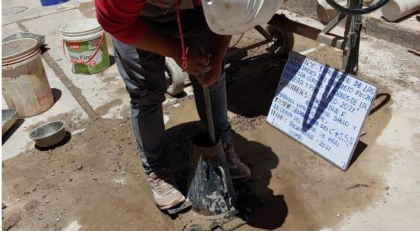
Fotografía 7 Determinación del SLUMP.
