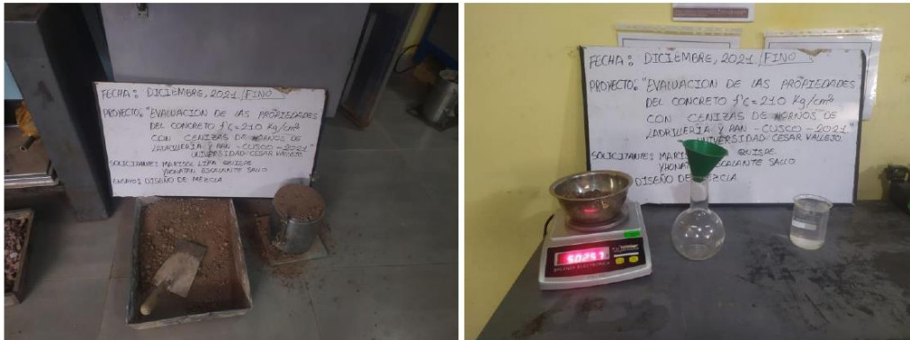
Fotografía 6 Y Fotografía 7: IZQUIERDA: Determinación del peso unitario, DERECHA: determinación del peso específico.
