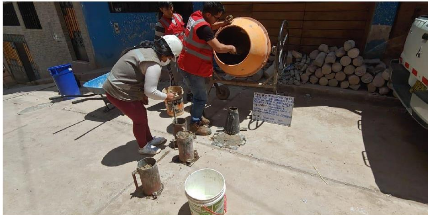
Fotografía 18 y Fotografía 19 Vaciado del concreto en los moldes cilindricos de 15x30cm.
