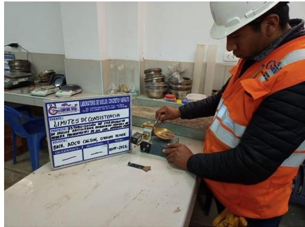
**Panel fotográfico N° 18:** Ensayo de límite líquido del suelo en estado inicial.
