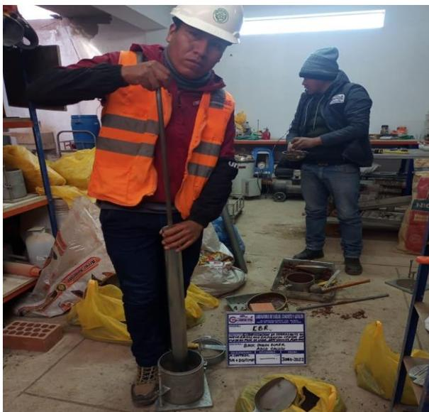
**Panel fotográfico N° 23:** Ensayo CBR con la incorporación del 20% de ceniza de madera.
