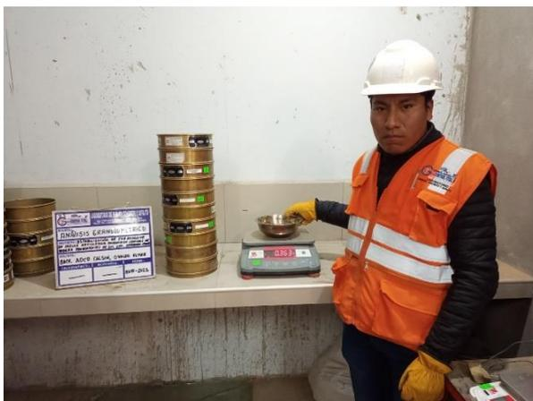
**Panel fotográfico N° 13:** Ensayo de granulometría
