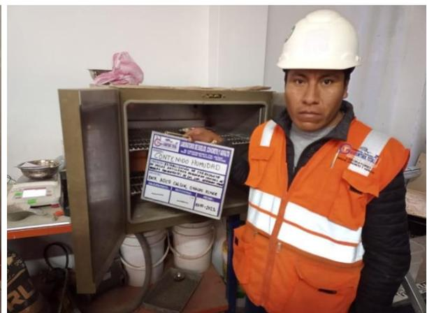
**Panel fotográfico N° 14:** Ensayo de contenido de humedad.
