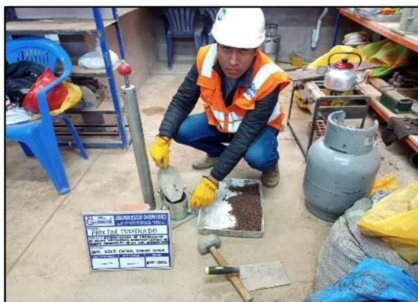
Figura 24. Ensayo proctor modificado.
