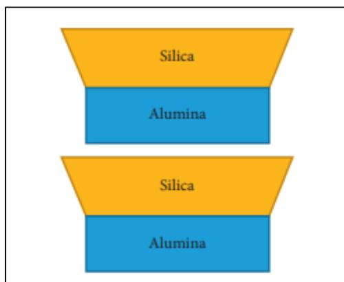
*Figura 5.* Disposición estructural del cristal de caolinita
