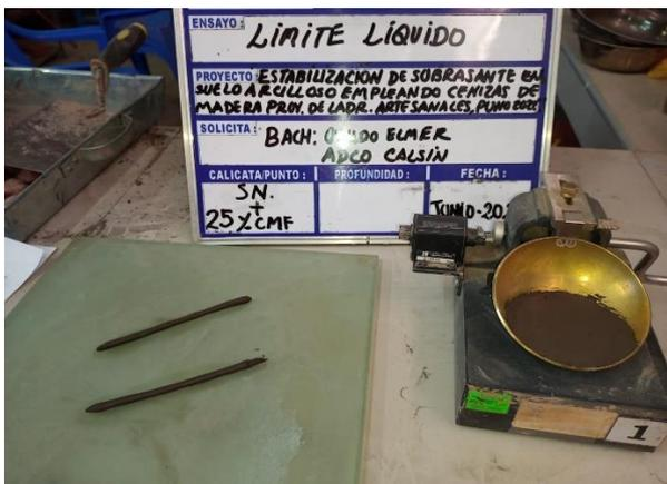
**Panel fotográfico N° 19:** Ensayo de límite líquido con la incorporación del 25% de ceniza de madera.
