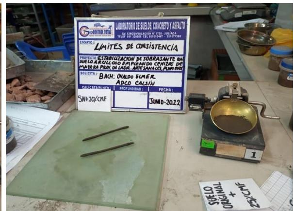
**Panel fotográfico N° 20:** Ensayo de límites de consistencia con la incorporación del 20% de ceniza de
