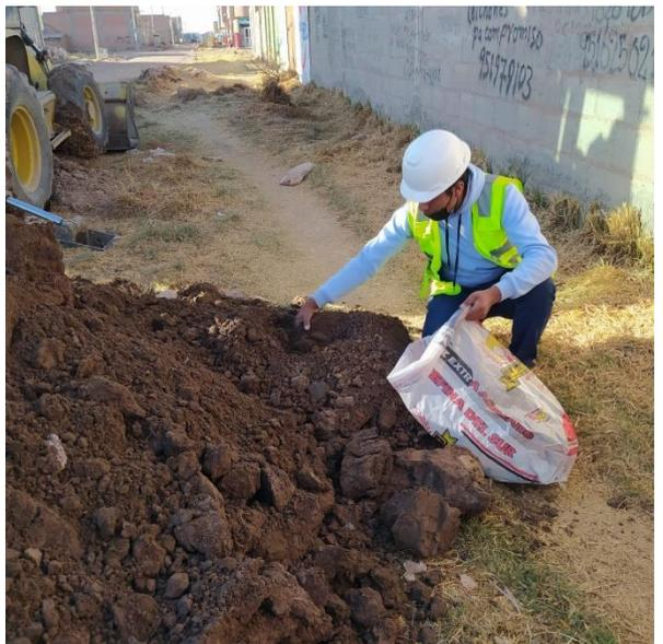
**Panel fotográfico N° 8:** Extracción de suelo arcilloso de la Calicata N° 2 del Jirón La victoria.
