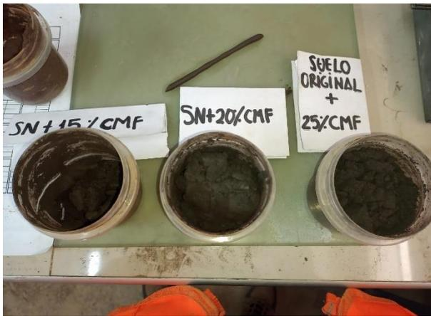
**Panel fotográfico N° 17:** Preparación de 15%, 20% y 25% de ceniza de madera para el ensayo de límite líquido.
