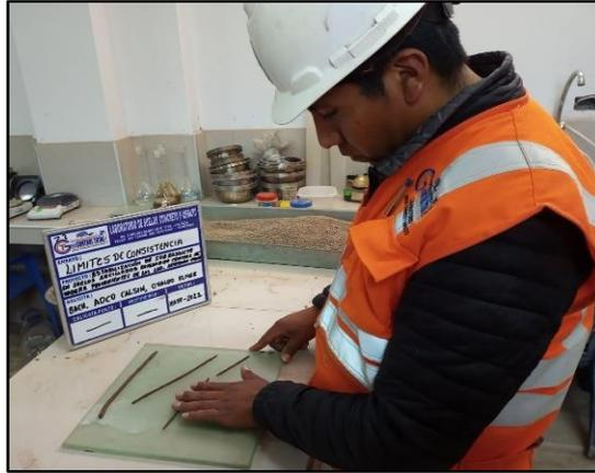
Figura 23. Ensayo del límite plástico.
