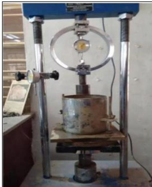
*Figura 17.* Máquina de ensayo CBR
