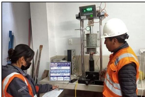
*Figura 25.* Ensayo de capacidad de soporte CBR.
