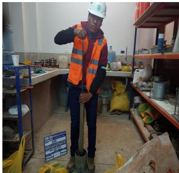
**Panel fotográfico N° 24:** Ensayo CBR con la incorporación del 25% de ceniza de madera.
