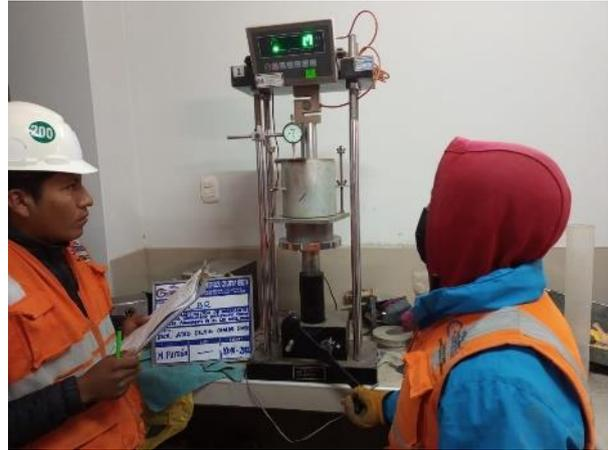
**Panel fotográfico N° 28:** Ensayo de CBR de la muestra patrón.
