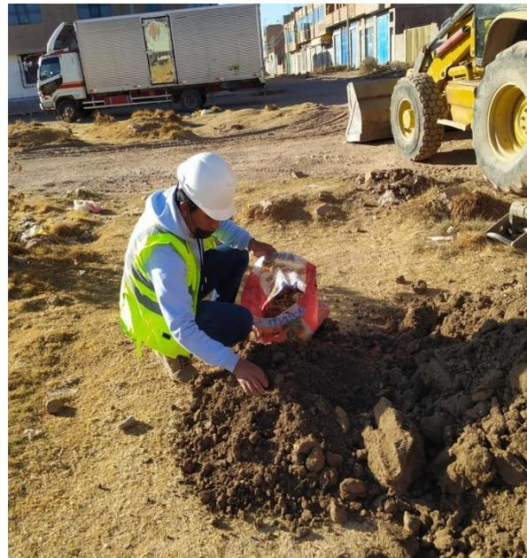
**Panel fotográfico N° 4:** Extracción de la muestra del suelo arcilloso de C-1.
