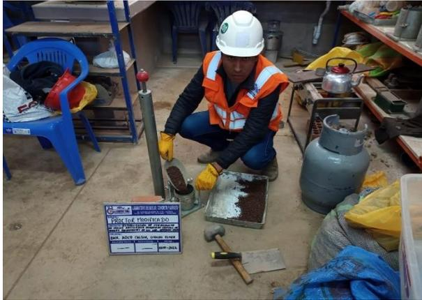
**Panel fotográfico N° 21:** Colocación de la muestra en el molde cilíndrico.
