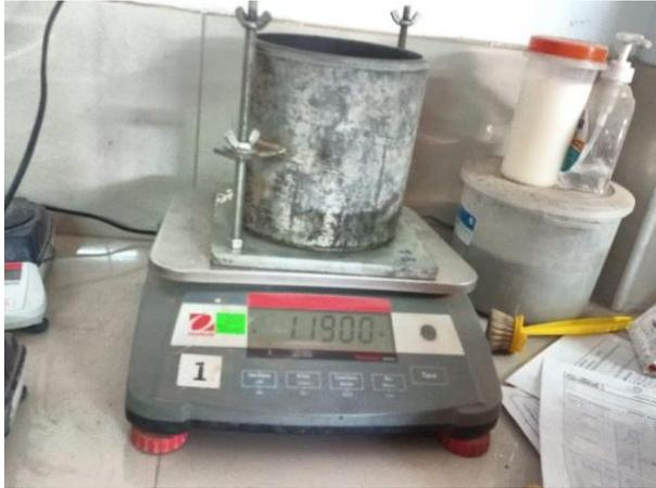
**Panel fotográfico N° 27:** Peso de la muestra del suelo para la prueba CBR.
