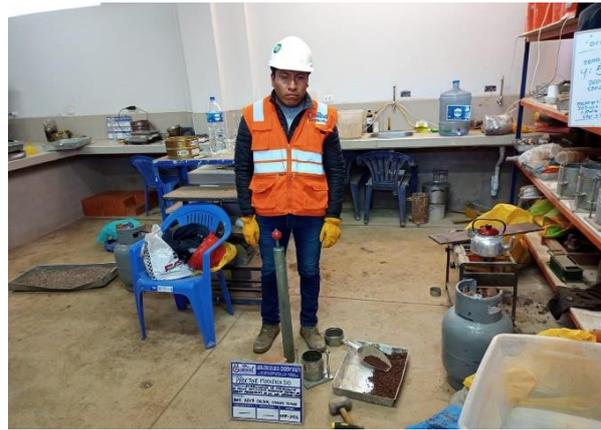
**Panel fotográfico N° 22:** Ensayo de proctor modificado del suelo natural.
