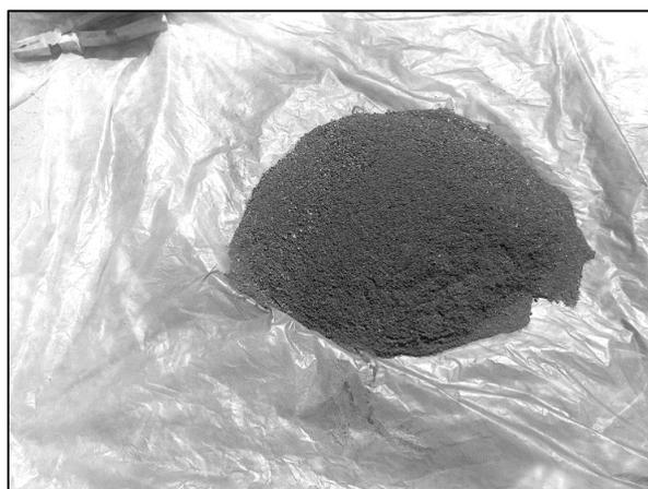
*Figura 26.* Ceniza de madera extraída de ladrilleras artesanales
