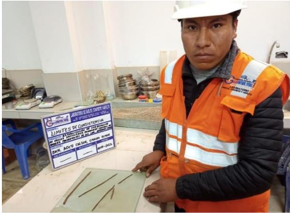
**Panel fotográfico N° 15:** Ensayo de límite plástico del suelo natural.
