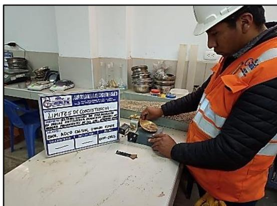
Figura 22. Ensayo de límite líquido
