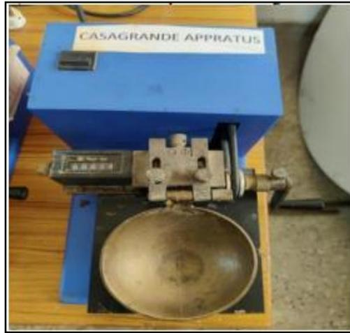
Figura 8. Aparato de Casagrande para prueba de LL.
