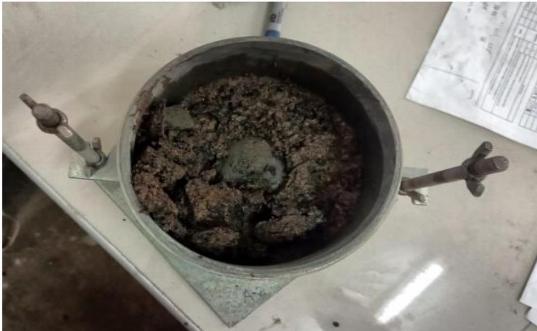
**Panel fotográfico N° 31:** Ensayo de CBR: Muestra después de la aplicación de carga.
