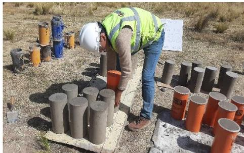
Proceso donde se desmolda las briquetas de concreto.
