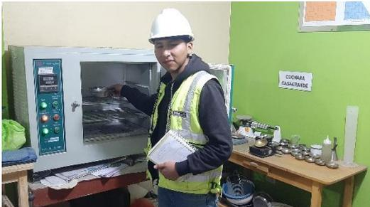
Proceso de secado en horno del agregado para determinar su humedad.
