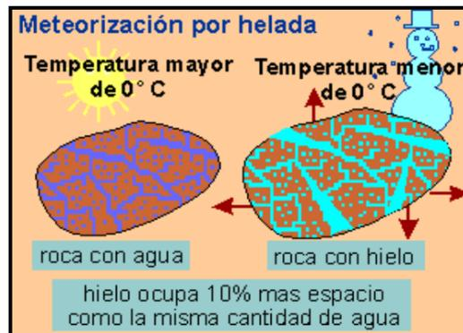
Figura 6: Presión dentro del agregado.
