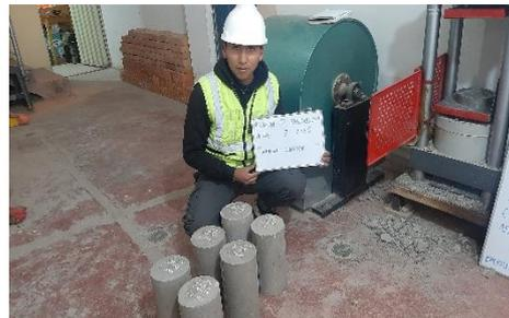
Selección de las briquetas de concreto según la edad para someterlos a la prueba de compresión.
