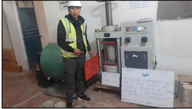
Figura 28: Prueba de resistencia a los 28 días.
