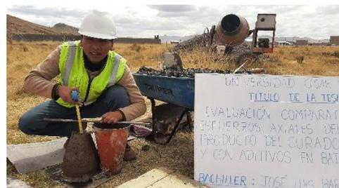
Ensayo de cono de Abrams para analizar la consistencia de la mezcla.
