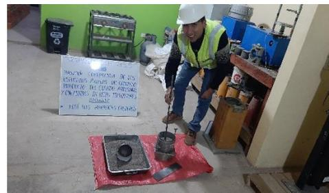
Ensayo de pesos unitarios del agregado para el diseño de mezcla.
