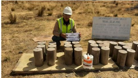
Identificación de los testigos de concreto para realizar el curado con aditivo membrasil vista.
