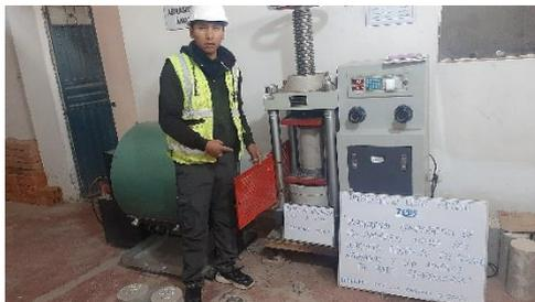
Ensayo de resistencia a la compresión del concreto según la edad de los testigos.
