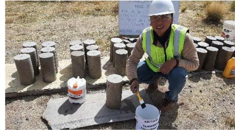
Proceso de curado con el aditivo membrasil vista según los grupos de 1,2 y 3 capas.
