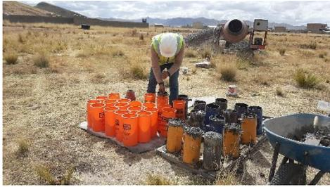
Proceso de elaboración de las briquetas de concreto para la investigación.
