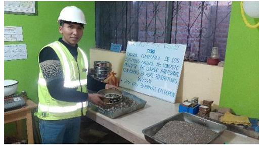
Ensayo de granulometría del agregado.
