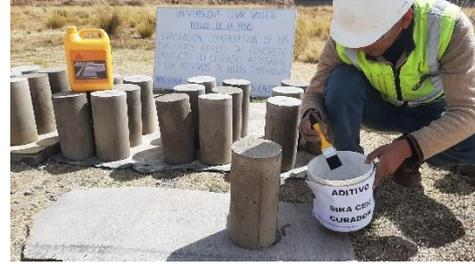
Proceso de curado con el aditivo sikacem según los grupos de 1,2 y 3 capas.
