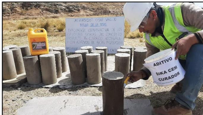
Figura 24: Proceso del curado con sikacem.
