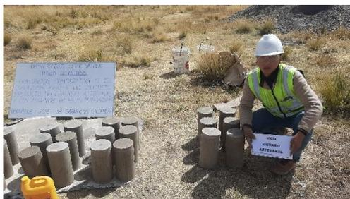
Identificación de los testigos de concreto para realizar el curado artesanal.
