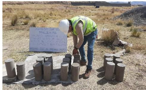
Proceso de distribución de los testigos para realizar los métodos de curado de la investigación.
