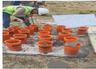
Proceso de varillado en la elaboración de briquetas de concreto.
