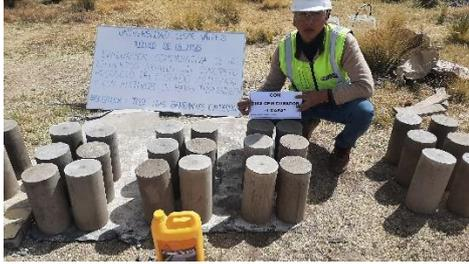
Identificación de los testigos de concreto para realizar el curado con aditivo sikacem.
