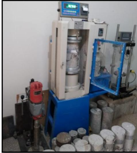
*Figura 14:* Equipo para ensayo de Briquetas.
