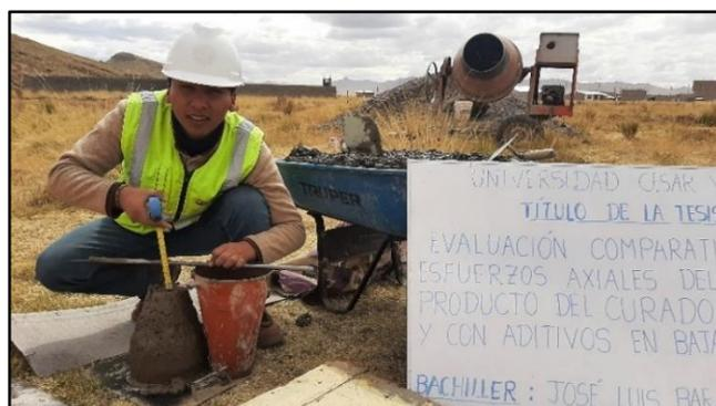
Figura 17: Ensayo de consistencia.
