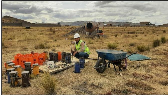
*Figura 18:* Colocación del concreto en los moldes
