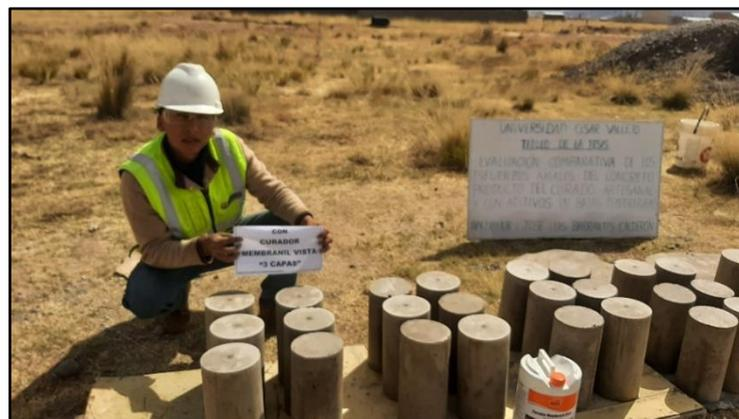
Figura 22: Briquetas para el curado con membrasil vista.
