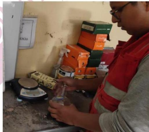
fotografía 3 y Fotografía 4 Ejecución del ensayo de peso específico.
