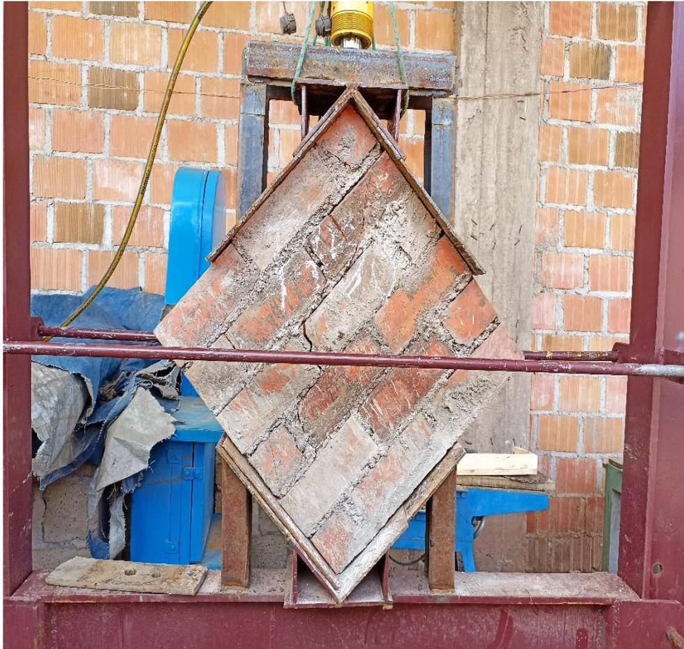
En la **figura 21** se observa una falla por corte escalonado, que parte en dos el murete. Del mismo modo, se observa que el mortero se mantiene intacto adherido a la unidad de albañilería superior pero separada de la unidad de albañilería inferior.
