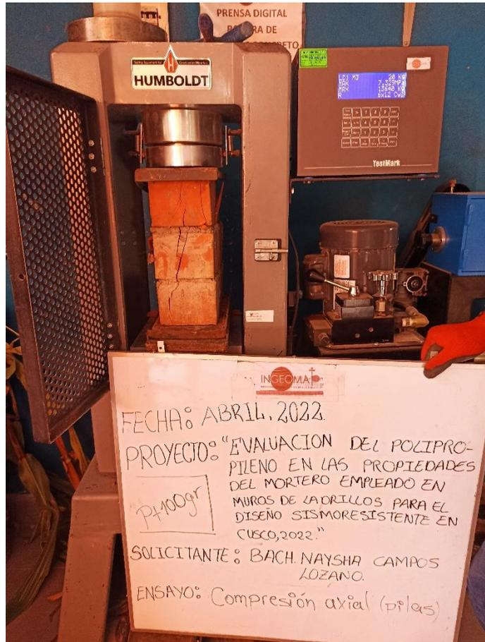
Realización del ensayo de compresión diagonal en los especímenes (patrón, patrón+50 gramos, patrón+75 gramos y patrón+100 gramos respectivamente)
