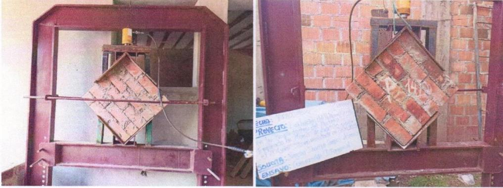
Fotografía 5 y Fotografía 6, Ejecución del ensayo en el Espécimen 01 y Espécimen 02.
