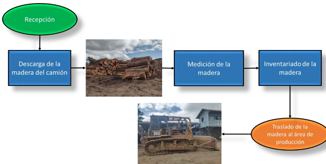
Figura 11. Diagrama de procesos de la recepción de la materia prima, Forestal Durand S.A.C.
