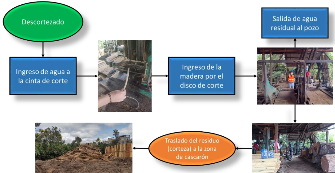
Figura 12. Diagrama de procesos del descortezado de la materia prima, Forestal Durand S.A.C.
