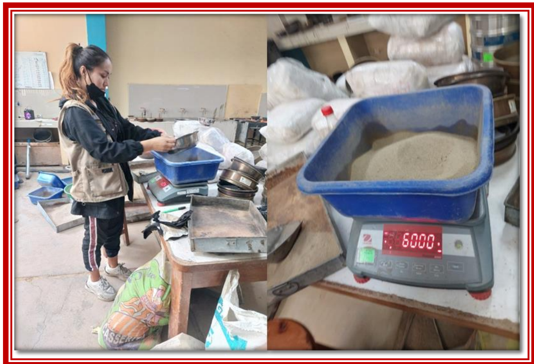
FIGURA N° 16 SUELO SELECCIONADO PARA ENSAYO DE PROCTOR
