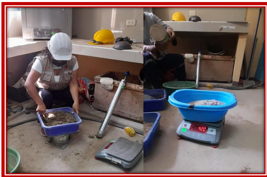
FIGURA N° 17 SUELO MÁS PET PARA ENSAYO DE PROCTOR
